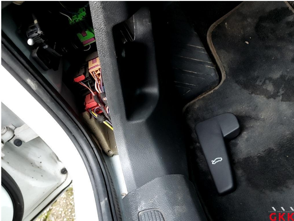
Bild 15 Motorhaube, Betätigung, abgerissen, ersetzen
