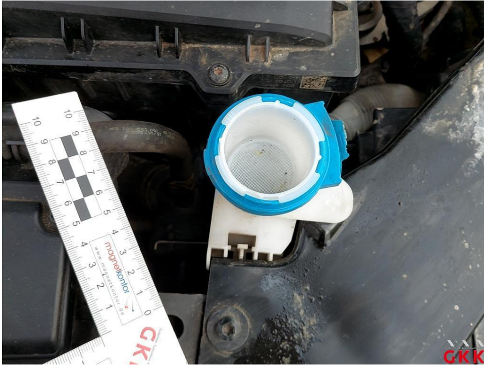
Bild 23 Scheibenwaschanlage, Deckel, beschädigt, ersetzen
