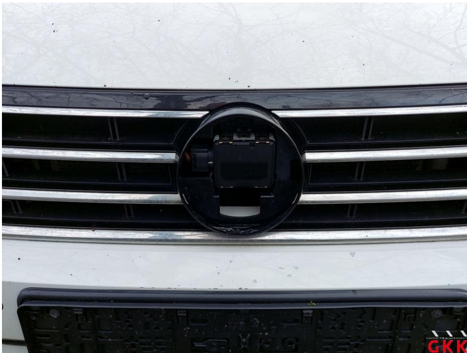
Bild 25 Emblem / Kühlergrill, fehlt, ersetzen
