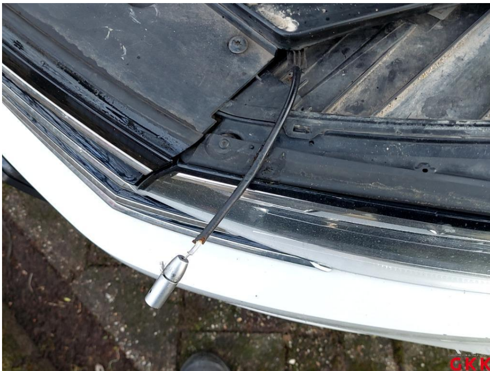
Bild 14 Motorhaube, Betätigung, abgerissen, ersetzen
