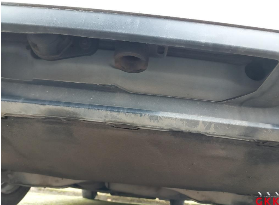
Bild 18 Anhängerkupplung, Kugelkopf -abnehmbar-, fehlt, ersetzen
