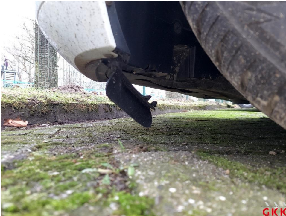
Bild 27 Kotflügel vorne links, Schale, beschädigt, ersetzen
