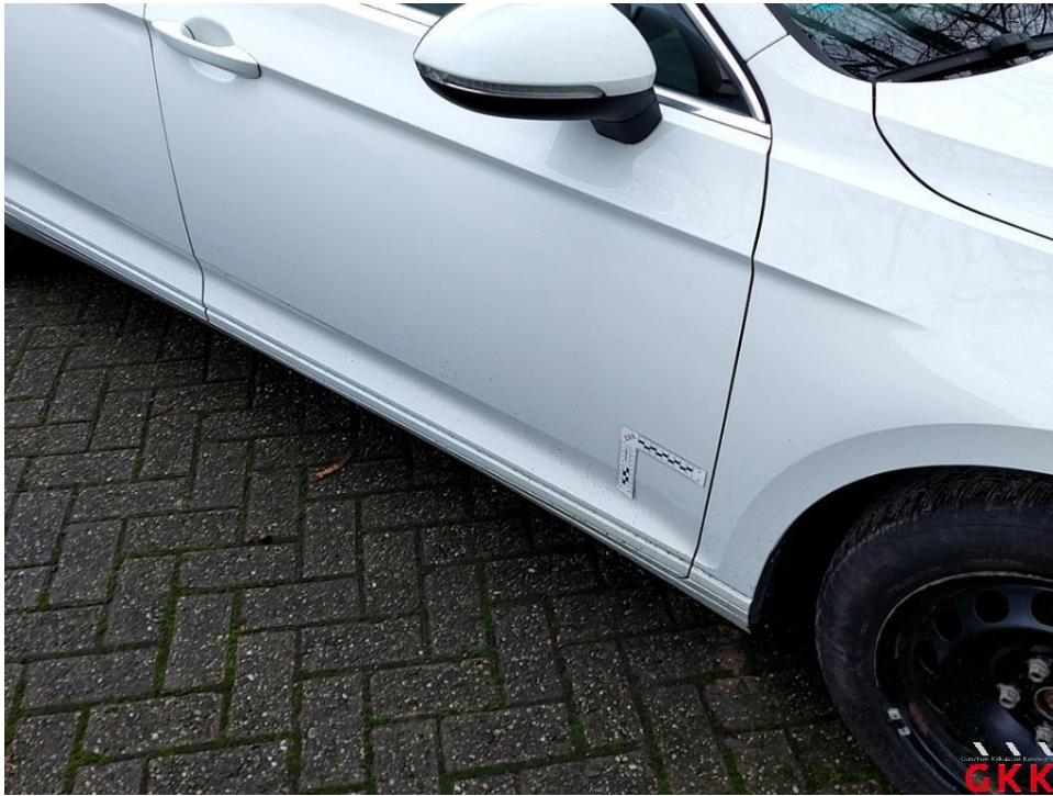
Bild 31 Tür vorne rechts, bis 3 Dellen / Bauteil, kalt drücken
