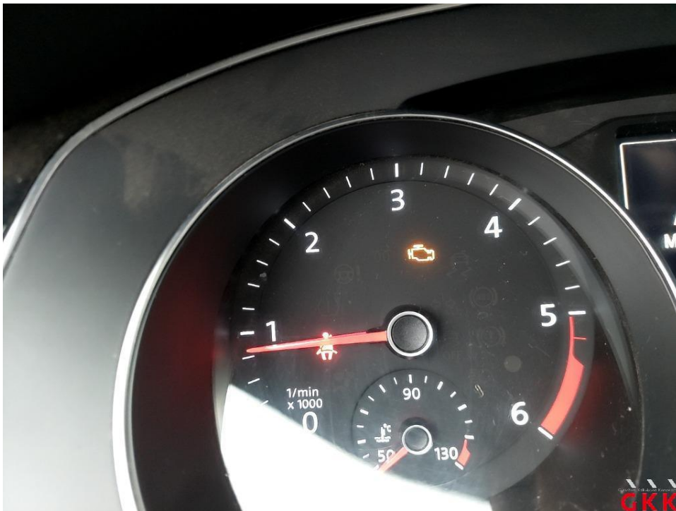
Bild 28 Motor, Fehlerspeicher, aktiv, auslesen / prüfen
