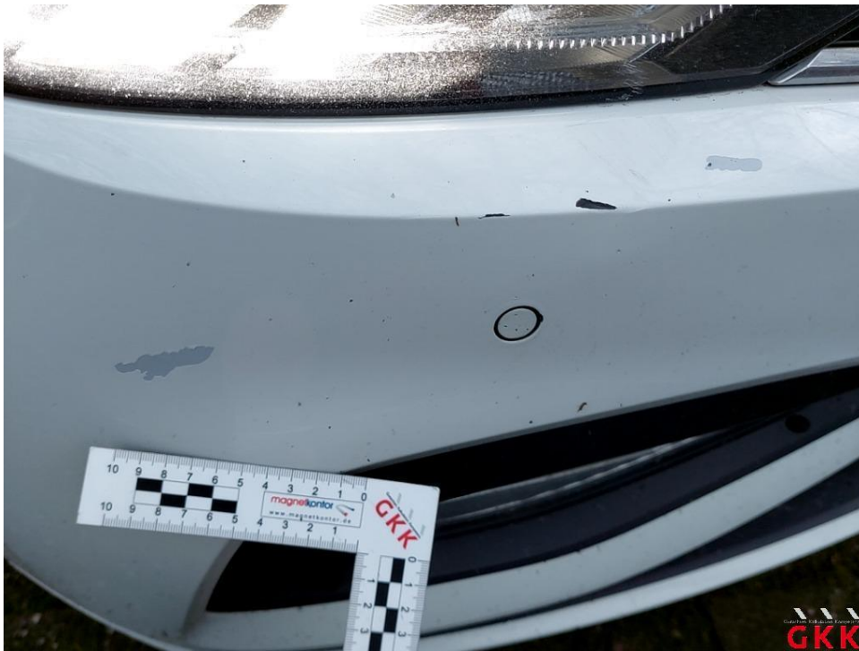
Bild 22 Stoßfänger vorne, Verkleidung -lackiert-, verkratzt, lackieren
