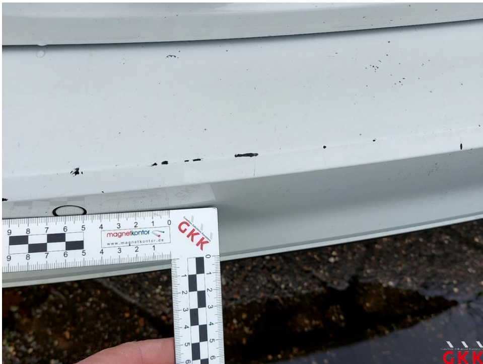
Bild 20 Stoßfänger hinten, Verkleidung -lackiert-, verkratzt, lackieren
