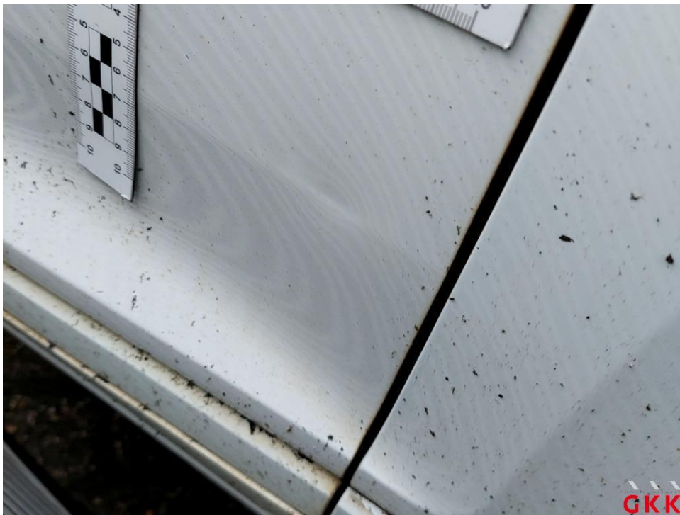
Bild 32 Tür vorne rechts, bis 3 Dellen / Bauteil, kalt drücken
