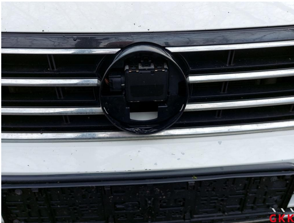
Bild 24 Emblem / Kühlergrill, fehlt, ersetzen
