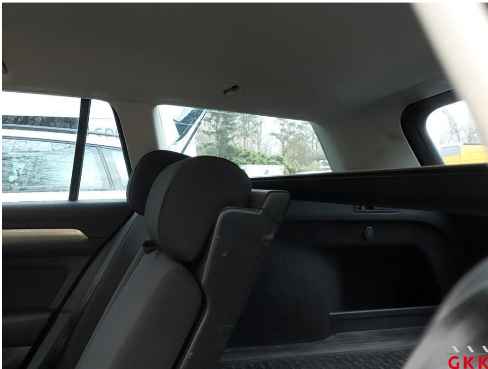
Bild 30 Laderaum, Trennnetz, fehlt, ersetzen
