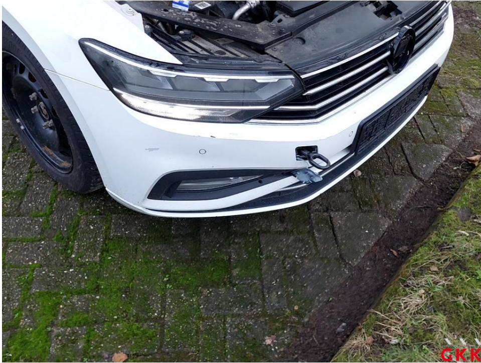
Bild 21 Stoßfänger vorne, Verkleidung -lackiert-, verkratzt, lackieren
