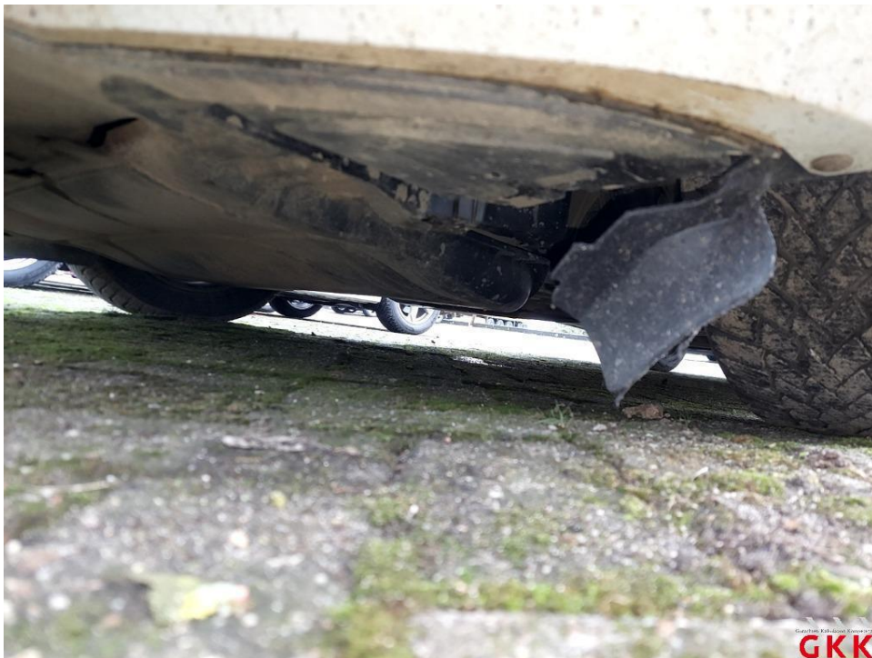
Bild 26 Kotflügel vorne links, Schale, beschädigt, ersetzen
