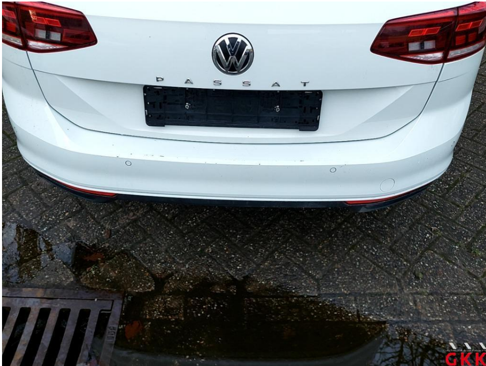
Bild 19 Stoßfänger hinten, Verkleidung -lackiert-, verkratzt, lackieren
