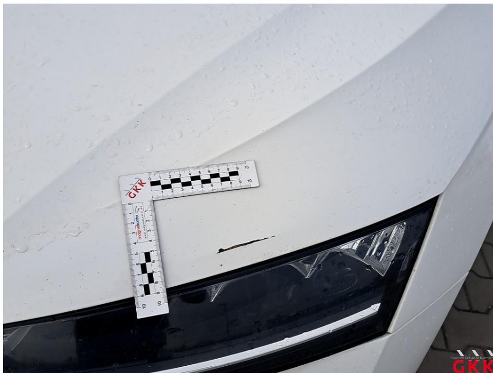
Bild 16 Motorhaube, beschädigt, instand setzen - lackieren
