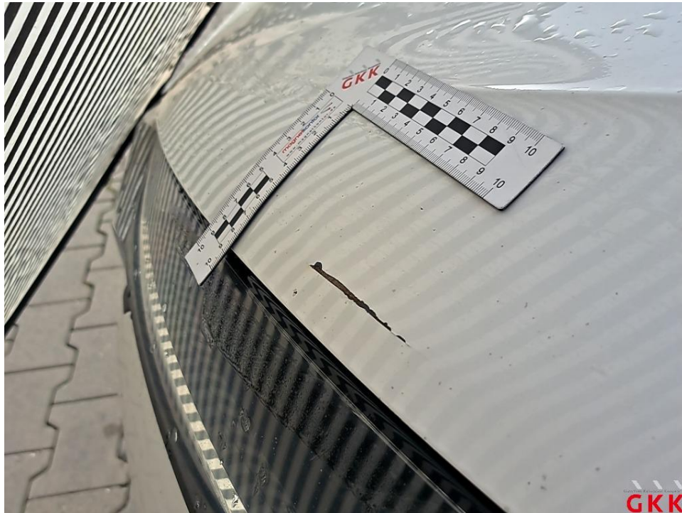
Bild 17 Motorhaube, beschädigt, instand setzen - lackieren
