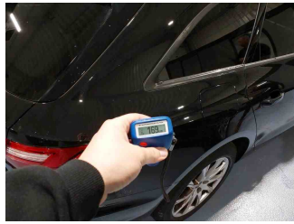
Lackstärke Seitenwand hinten rechts
