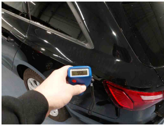
Lackstärke Seitenwand hinten links
