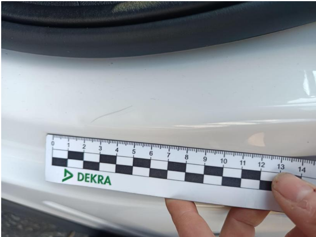
Fot. 43 Próg L - Wgniecenie/odkształcenie 1
