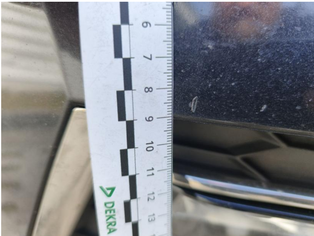
Fot. 43 Zderzak - Rysa/odprysk 2
