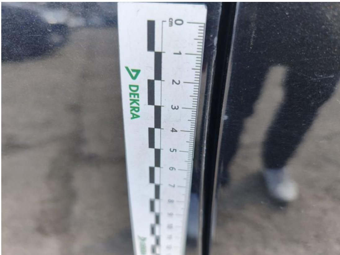
Fot. 67 Drzwi przed L() - Rysa/odprysk 3
