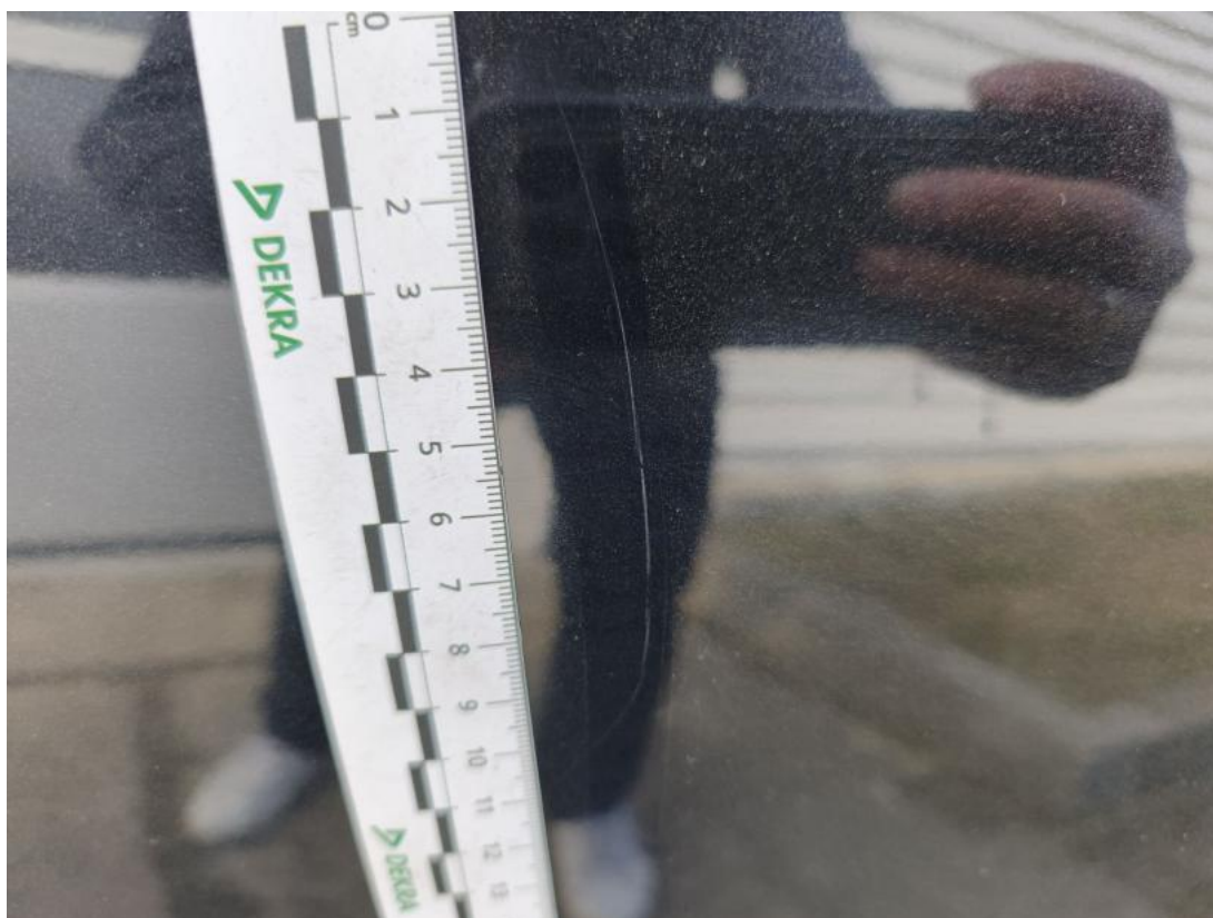
Fot. 49 Drzwi tylne P - Rysa/odprysk 1
