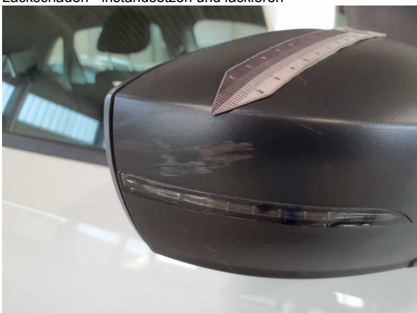
Beschädigung #13: Außenspiegel rechts: Abdeckkappe - Kratzer - aufbereiten
