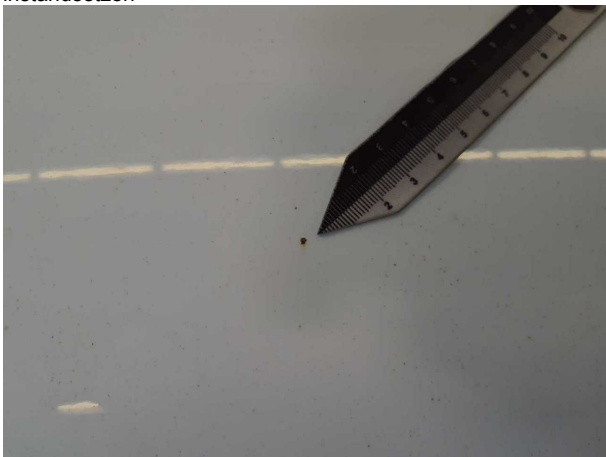
Beschädigung #11: Motorhaube: Motorhaube - Steinschlag - auslegen / polieren
