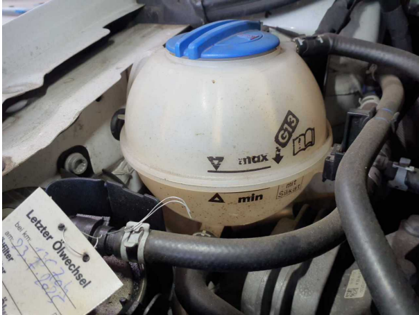
Beschädigung #4: Motorkühlung: Kühlflüssigkeit - leer - befunden ggf. instandsetzen
