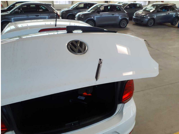
Beschädigung #1: Heckklappe/-tür: Heckklappe - Kratzer - auslegen / polieren
