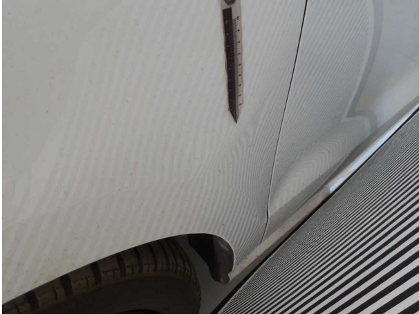
Beschädigung #14: Kotflügel links: Kotflügel links - verformt - erneuern
