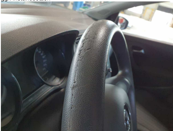
Beschädigung #5: Lenkanlage: Lenkrad - Abrieb - erneuern
