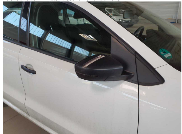
Beschädigung #13: Außenspiegel rechts: Abdeckkappe - Kratzer - aufbereiten
