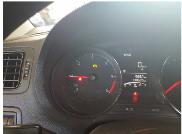
Beschädigung #6: Motor: Motor (MIL leuchtet + Geräusche im Lauf) - Funktion / Zulässigkeit - befunden ggf. instandsetzen
