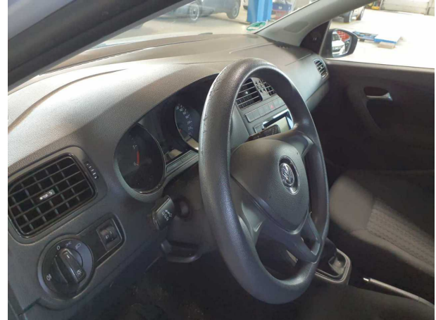
Beschädigung #5: Lenkanlage: Lenkrad - Abrieb - erneuern
