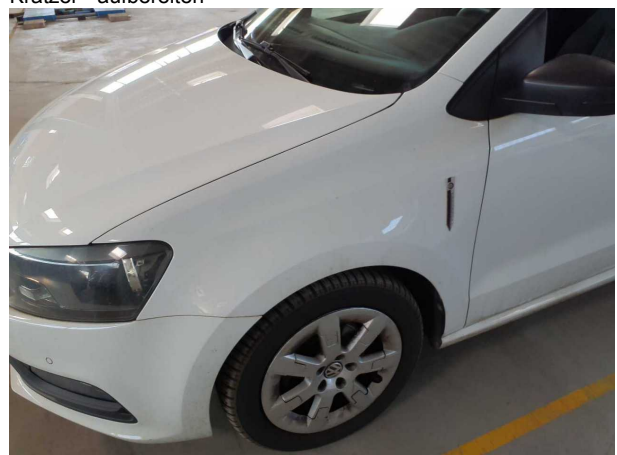
Beschädigung #14: Kotflügel links: Kotflügel links - verformt - erneuern
