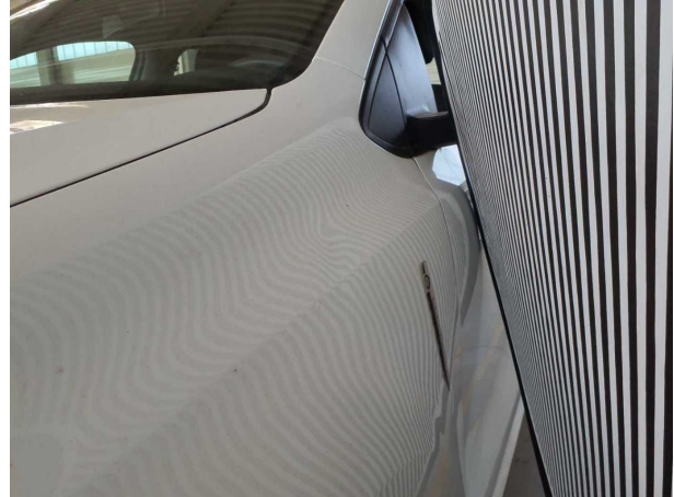
Beschädigung #14: Kotflügel links: Kotflügel links - verformt - erneuern
