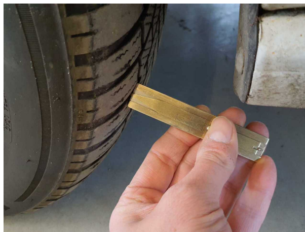
Beschädigung #8: Rad/Reifen: Reifen vorn - verschlissen - erneuern
