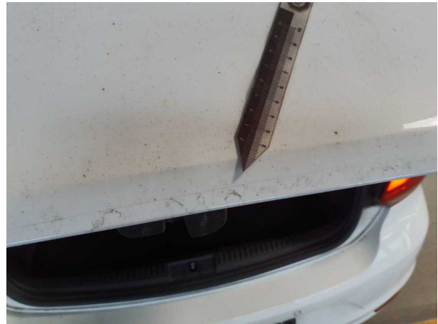
Beschädigung #1: Heckklappe/-tür: Heckklappe - Kratzer - auslegen / polieren
