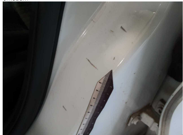
Beschädigung #15: Schweller links: Einstieg - Delle / Lackschaden - instandsetzen und lackieren
