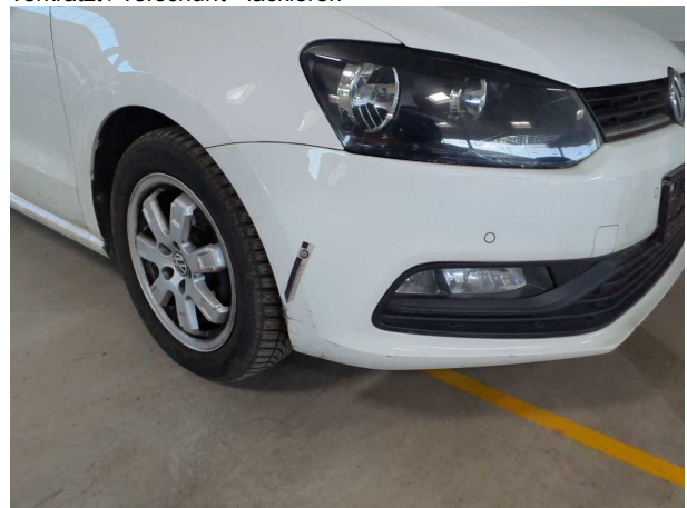
Beschädigung #19: Stossfänger vorn: Stossfänger vorn - Delle / Lackschaden - erneuern
