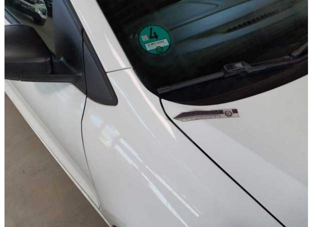
Beschädigung #12: Kotflügel rechts: Kotflügel rechts - Delle / Lackschaden - instandsetzen und lackieren
