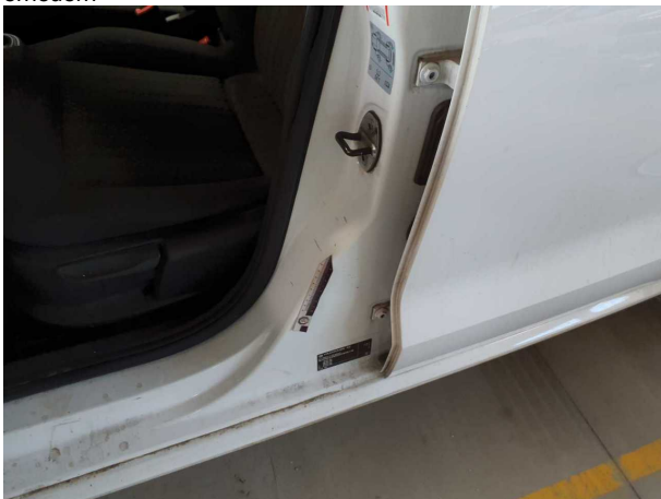
Beschädigung #15: Schweller links: Einstieg - Delle / Lackschad... - instandsetzen und lackieren
