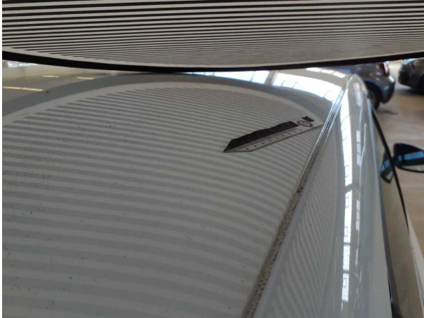
Beschädigung #10: Fahrzeugdach: Dach - Delle(n) - sanft instandsetzen
