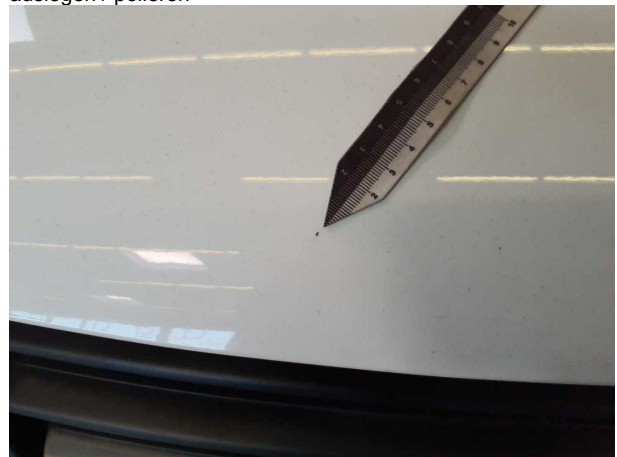
Beschädigung #11: Motorhaube: Motorhaube - Steinschlag - auslegen / polieren
