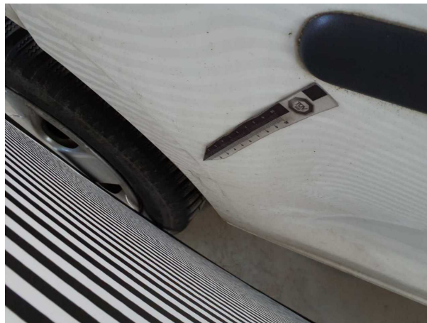
Beschädigung #22: Schiebetür rechts: Schiebetür mit Glasscheibe - Delle / Lackschaden - instandsetzen und
