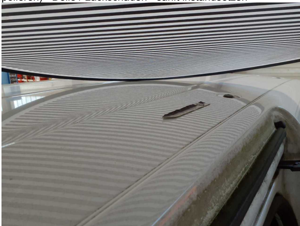
Beschädigung #8: Fahrzeugdach: Dach - Delle(n) - sanft instandsetzen
