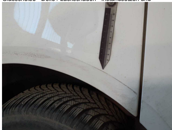
Beschädigung #23: Seitenwand rechts: Seitenwand - verkratzt / verschürft - lackieren
