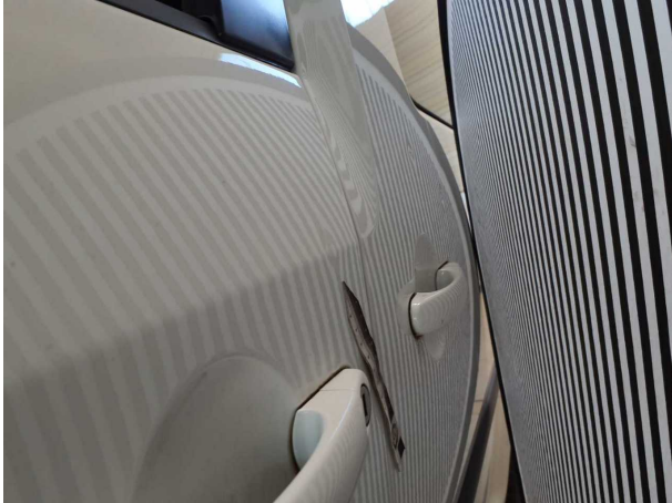
Beschädigung #14: Tür vorn links: Tür (+ auslegen/polieren) - Delle / Lackschaden - sanft instandsetzen
