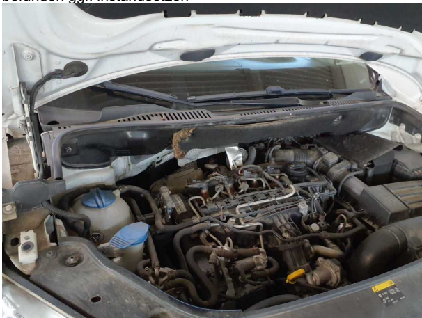
Beschädigung #6: Fahrerhaus: Dämmmatte - Marderschaden - erneuern
