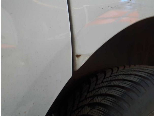
Beschädigung #12: Seitenwand links: Seitenwand - verkratzt / verschürft - lackieren
