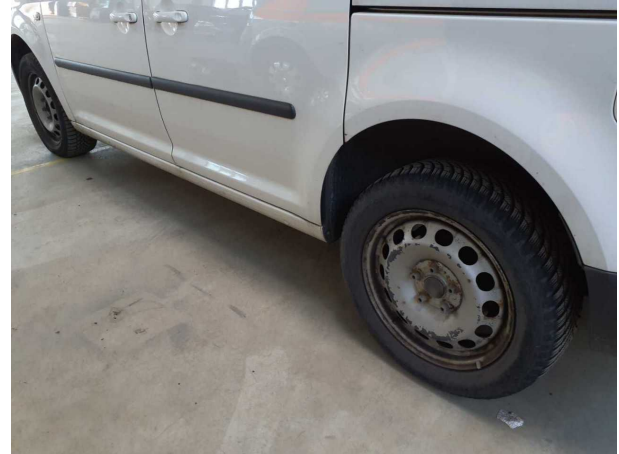
Beschädigung #25: Rad/Reifen: Raddeckel (Links + verschürft) - fehlt - erneuern
