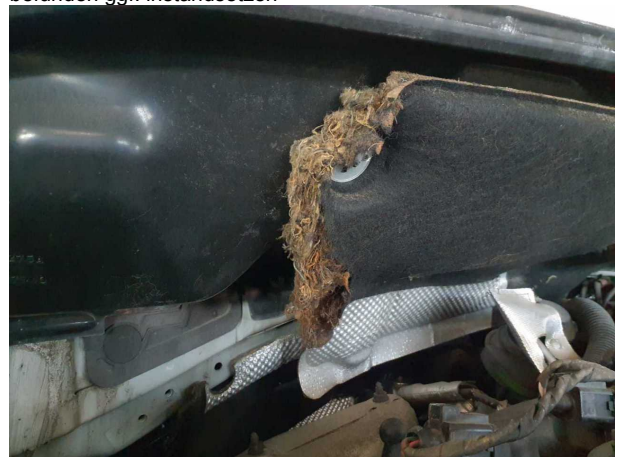
Beschädigung #6: Fahrerhaus: Dämmmatte - Marderschaden - erneuern
