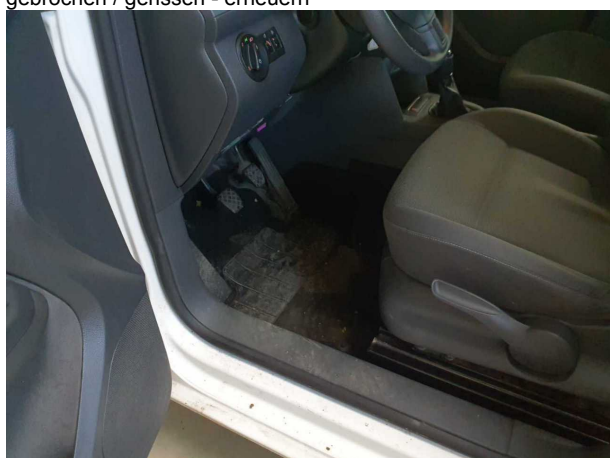
Beschädigung #4: Verkleidungen/Abdeckungen: Teppichboden vorn links - Löcher - erneuern
