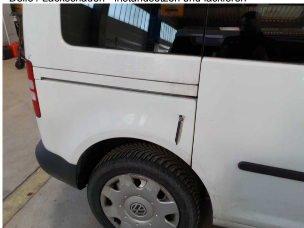
Beschädigung #23: Seitenwand rechts: Seitenwand - verkratzt / verschürft - lackieren
