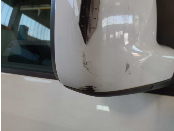
Beschädigung #10: Außenspiegel rechts: Abdeckkappe - verkratzt / verschürft - lackieren
