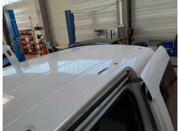
Beschädigung #8: Fahrzeugdach: Dach - Delle(n) - sanft instandsetzen
