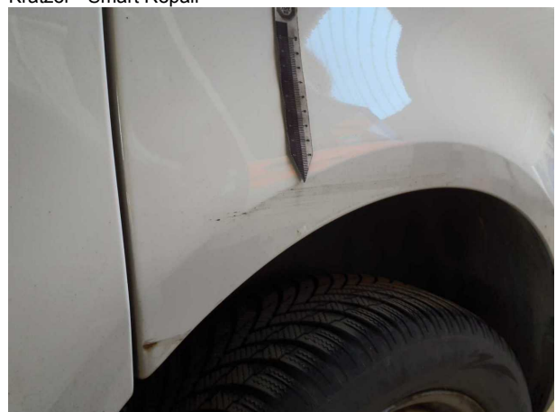
Beschädigung #12: Seitenwand links: Seitenwand - verkratzt / verschürft - lackieren
