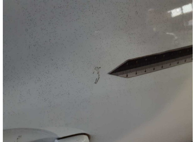
Beschädigung #21: Tür vorn rechts: Tür - Delle / Lackschaden - instandsetzen und lackieren
