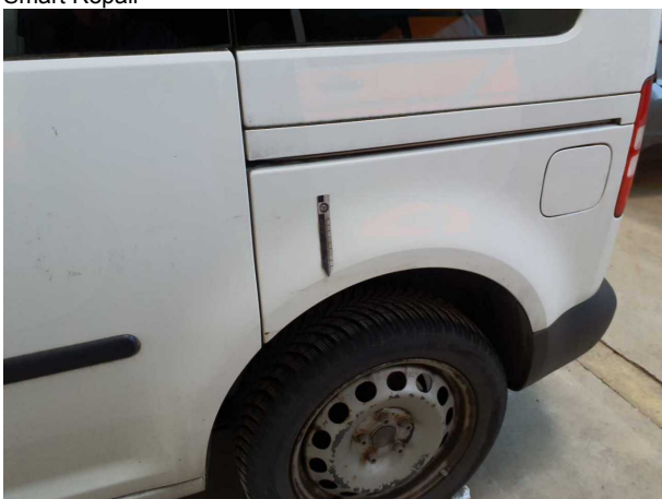
Beschädigung #12: Seitenwand links: Seitenwand - verkratzt / verschürft - lackieren
