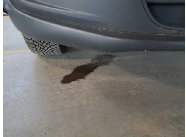
Beschädigung #5: Motorkühlung: Kühlflüssigkeit - undicht - befunden ggf. instandsetzen
