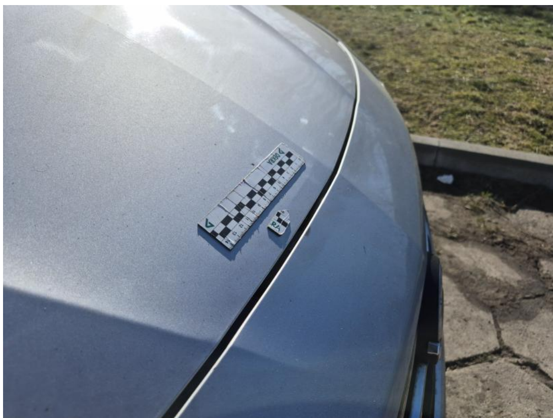
Fot. 34 Pokrywa komory silnika - Wgniecenie/odkształcenie 1
