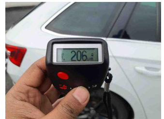
Lackstärke Seitenwand hinten rechts
