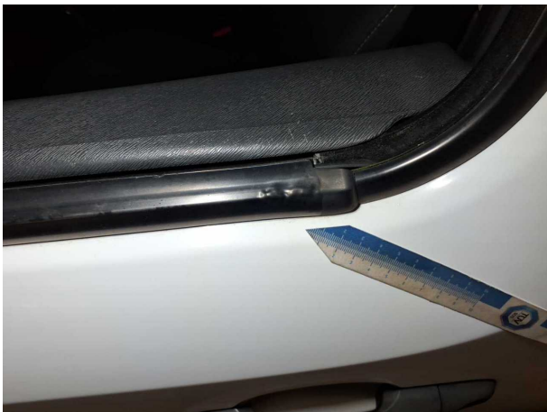
Beschädigung #22: Tür vorn links: Fensterführung - beschädigt - erneuern
