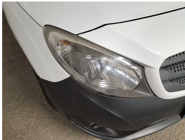
Beschädigung #10: Scheinwerfer: Scheinwerfer rechts (und links, Blind) - Funktion / Zulässigkeit - instandsetzen
