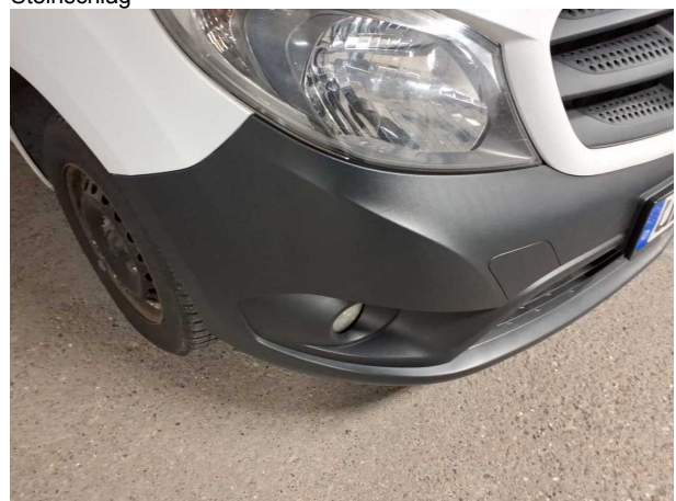
Beschädigung #12: Stossfänger vorn: Stossfänger vorn (unlackiert) - Kratzer
