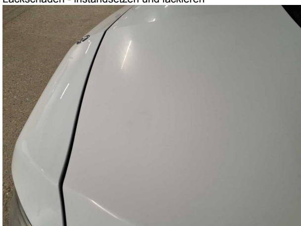
Beschädigung #31: Karosserie: Karosserie (Matte Stellen) - Lackmangel - instandsetzen
