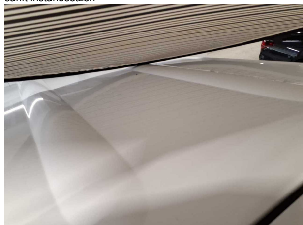
Beschädigung #32: Karosserie: Karosserie - Hagelschaden - sanft instandsetzen
