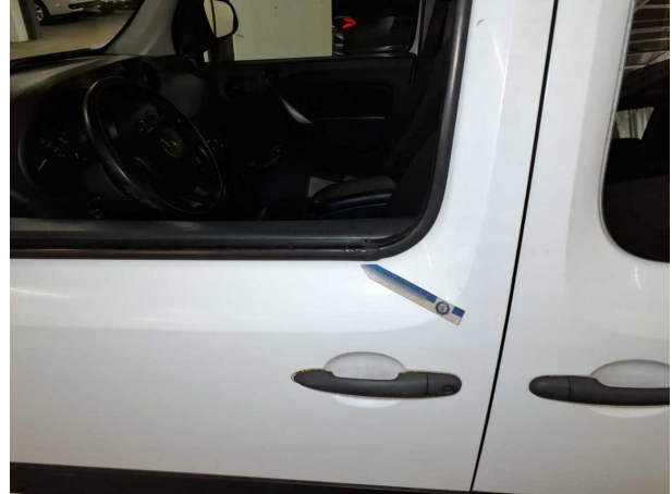
Beschädigung #22: Tür vorn links: Fensterführung - beschädigt - erneuern
