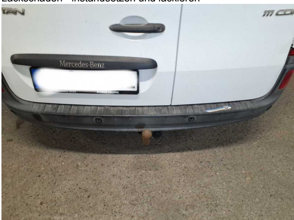
Beschädigung #18: Stossfänger hinten: Stossfänger hinten (unlackiert) - Kratzer
