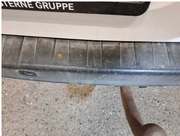
Beschädigung #18: Stossfänger hinten: Stossfänger hinten (unlackiert) - Kratzer
