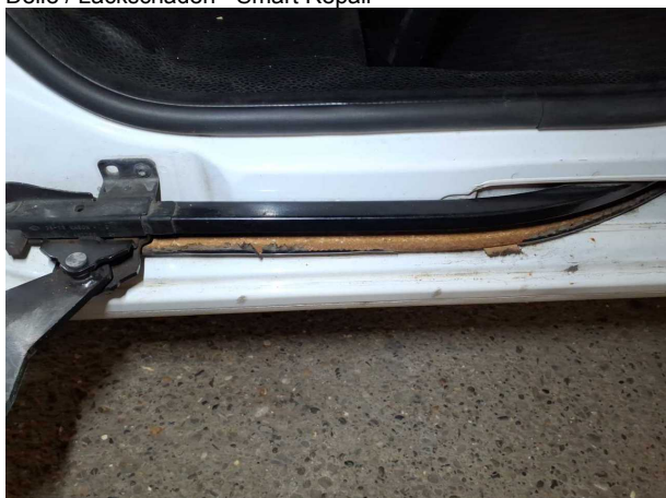
Beschädigung #7: Schiebetür rechts: Führungsschiene - Korrosi... - instandsetzen
