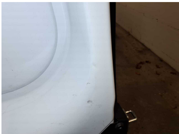
Beschädigung #6: Heckklappe/-tür: Hecktür rechts (Innenseite) - Delle / Lackschaden - Smart Repair
