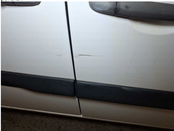
Beschädigung #15: Tür vorn rechts: Tür - Kratzer - auslegen / polieren
