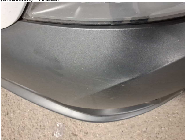
Beschädigung #12: Stossfänger vorn: Stossfänger vorn (unlackiert) - Kratzer
