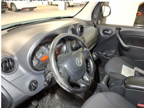
Beschädigung #27: Lenkanlage: Lenkrad - beschädigt - erneuern
