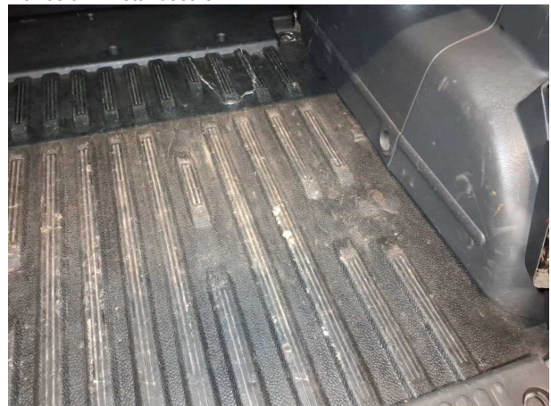
Beschädigung #3: Interieur: Laderaumboden (Und Verkleidungen) - Kratzer
