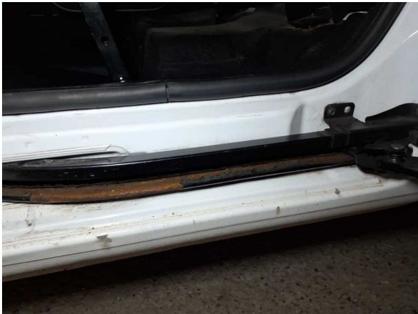
Beschädigung #2: Schiebetür links: Führungsschiene - Korrosio... instandsetzen
