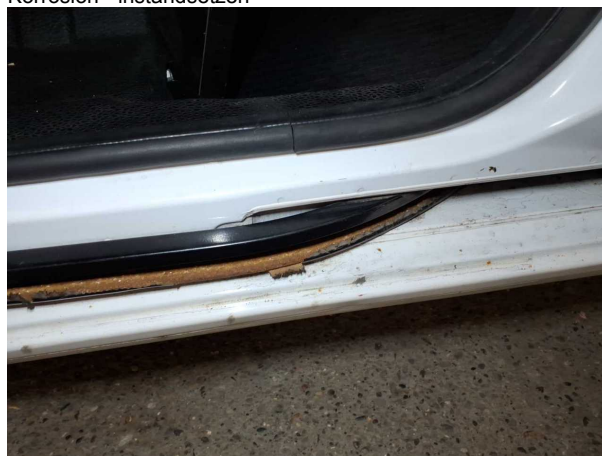
Beschädigung #7: Schiebetür rechts: Führungsschiene - Korrosion - instandsetzen
