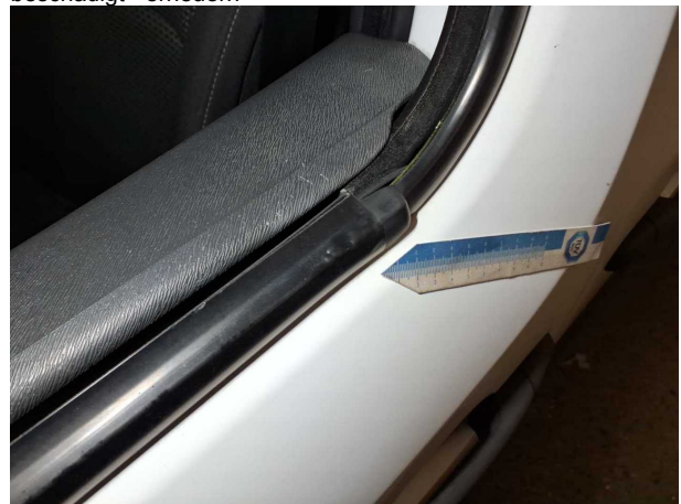
Beschädigung #22: Tür vorn links: Fensterführung - beschädigt - erneuern
