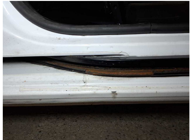
Beschädigung #2: Schiebetür links: Führungsschiene - Korrosion - instandsetzen
