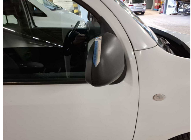
Beschädigung #14: Außenspiegel rechts: Abdeckkappe - Kratzer
