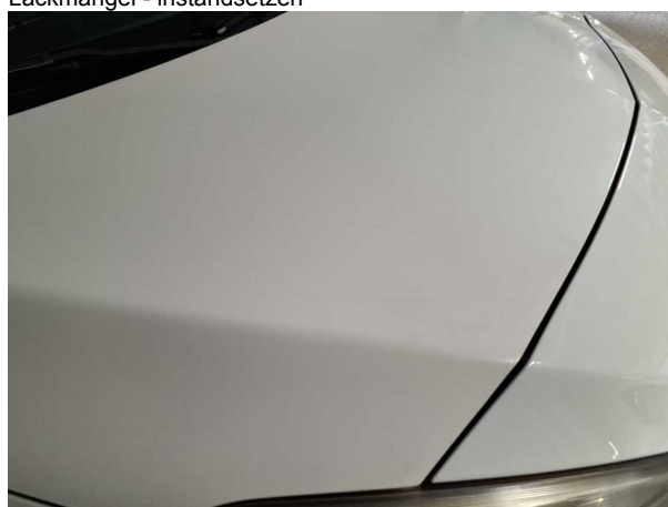
Beschädigung #31: Karosserie: Karosserie (Matte Stellen) - Lackmangel - instandsetzen
