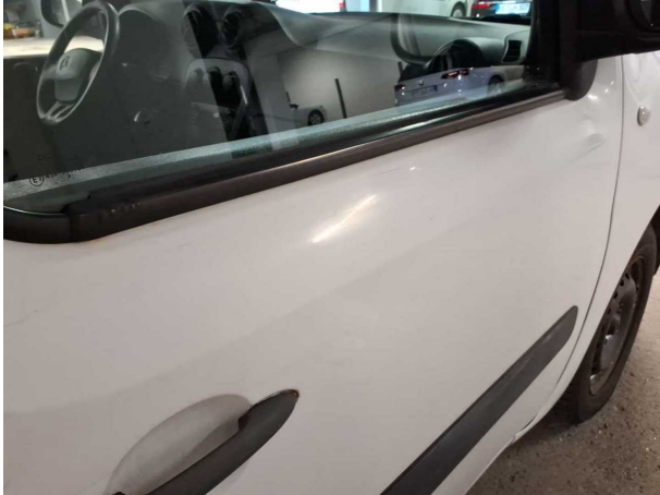
Beschädigung #31: Karosserie: Karosserie (Matte Stellen) - Lackmangel - instandsetzen
