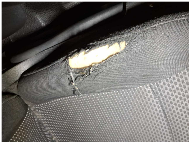
Beschädigung #26: Sitz vorn: Sitzbezug links (Mit Polster) - gebrochen / gerissen - erneuern
