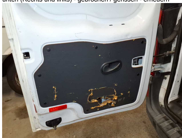
Beschädigung #4: Heckklappe/-tür: Verkleidung Standard unten (Rechts und links) - gebrochen / gerissen - erneuern
