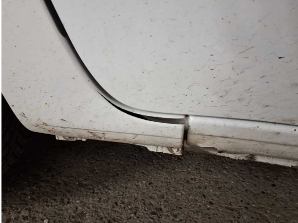
Beschädigung #23: Kotflügel links: Kotflügel links - gebrochen / gerissen - erneuern
