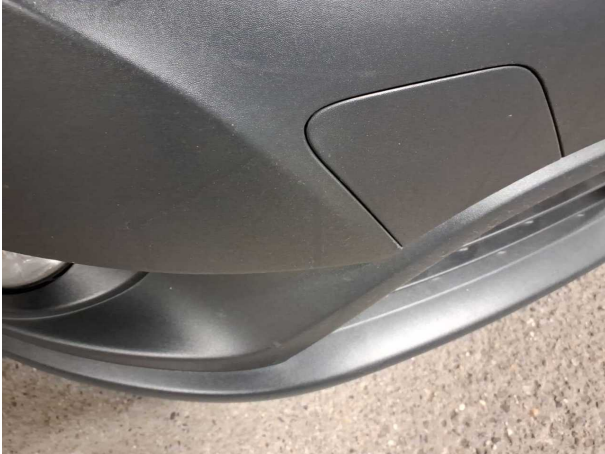
Beschädigung #12: Stossfänger vorn: Stossfänger vorn (unlackiert) - Kratzer
