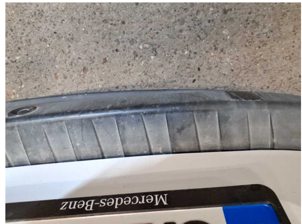
Beschädigung #18: Stossfänger hinten: Stossfänger hinten (unlackiert) - Kratzer
