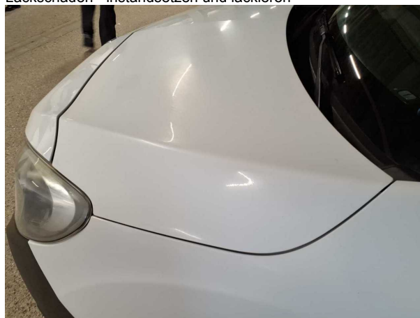
Beschädigung #31: Karosserie: Karosserie (Matte Stellen) - Lackmangel - instandsetzen
