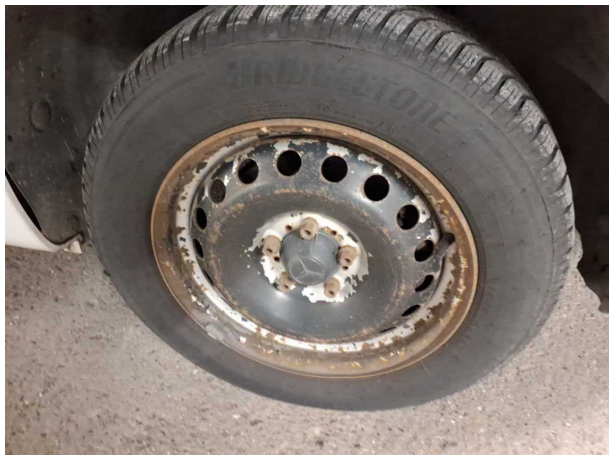
Beschädigung #9: Rad/Reifen: Stahlrad (Alle 4x) - Korrosion
