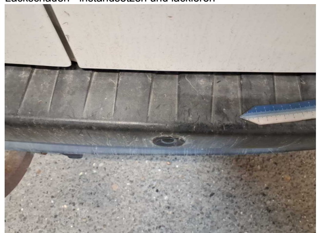
Beschädigung #18: Stossfänger hinten: Stossfänger hinten (unlackiert) - Kratzer
