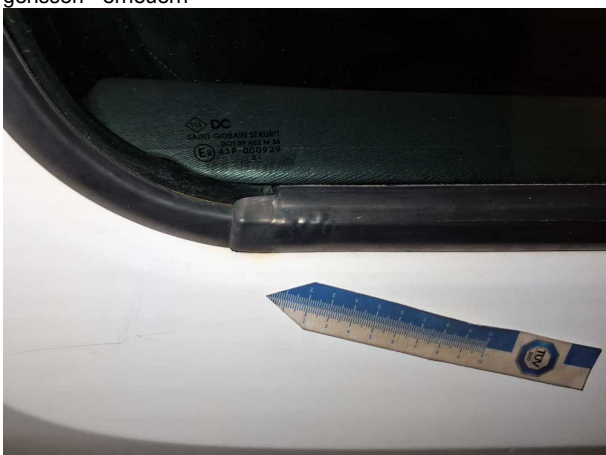
Beschädigung #25: Tür vorn rechts: Fensterführung - beschädigt - erneuern
