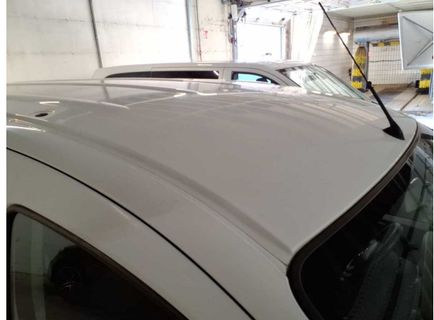
Beschädigung #32: Karosserie: Karosserie - Hagelschaden - sanft instandsetzen
