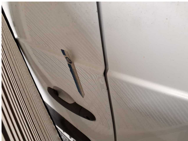
Beschädigung #30: Heckklappe/-tür: Hecktür links - Delle / Lackschaden - instandsetzen und lackieren
