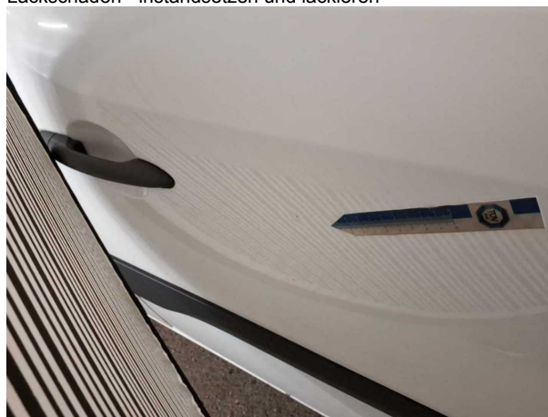
Beschädigung #29: Schiebetür links: Schiebetür - Delle / Lackschaden - instandsetzen und lackieren
