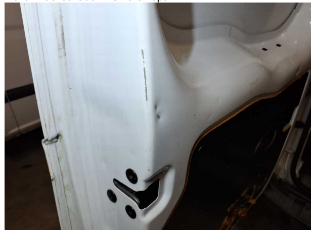
Beschädigung #5: Heckklappe/-tür: Hecktür links (Innenseit... Delle / Lackschaden - Smart Repair
