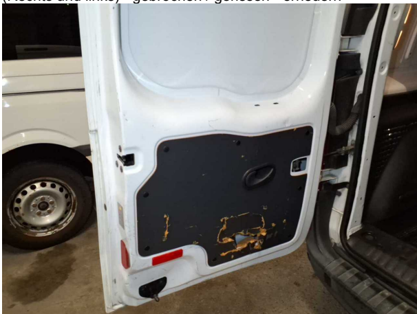
Beschädigung #5: Heckklappe/-tür: Hecktür links (Innenseite) - Delle / Lackschaden - Smart Repair
