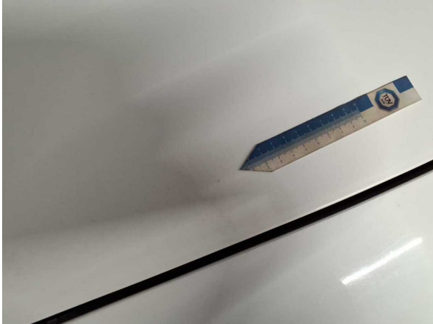
Beschädigung #13: Motorhaube: Motorhaube - Steinschlag
