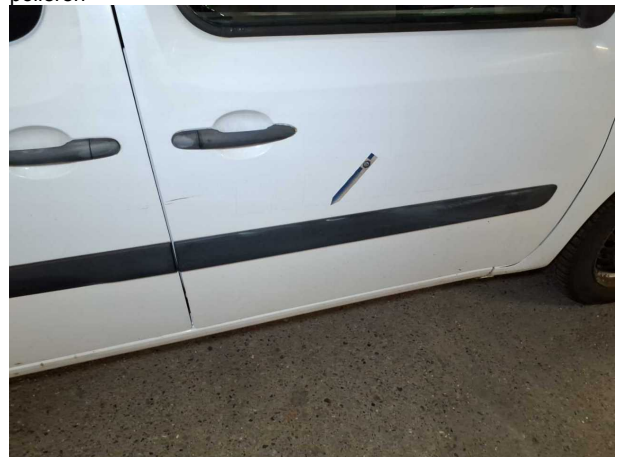
Beschädigung #16: Tür vorn rechts: Zierleiste Mitte - Kratzer - instandsetzen
