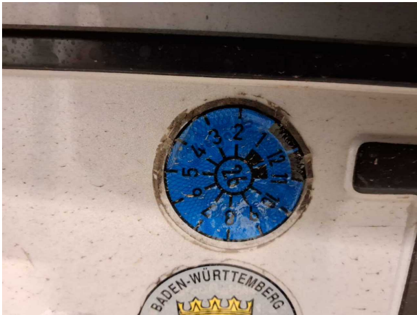
Beschädigung #1: Sonstiges: Hauptuntersuchung - abgelaufen - erneuern
