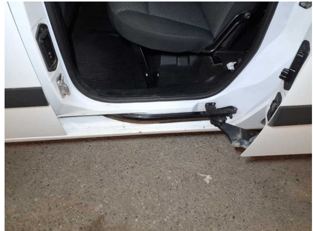
Beschädigung #2: Schiebetür links: Führungsschiene - Korrosion - instandsetzen
