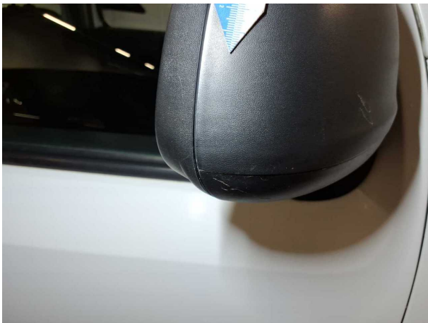
Beschädigung #14: Außenspiegel rechts: Abdeckkappe - Kratzer
