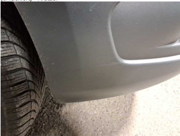
Beschädigung #12: Stossfänger vorn: Stossfänger vorn (unlackiert) - Kratzer
