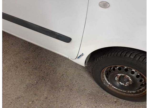
Beschädigung #24: Kotflügel rechts: Kotflügel rechts - gebrochen / gerissen - erneuern
