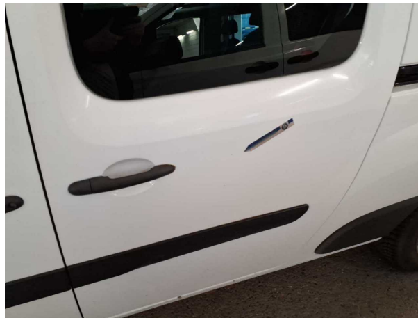
Beschädigung #29: Schiebetür links: Schiebetür - Delle / Lackschaden - instandsetzen und lackieren
