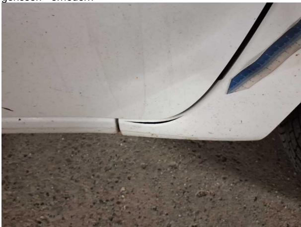
Beschädigung #24: Kotflügel rechts: Kotflügel rechts - gebroche... gerissen - erneuern
