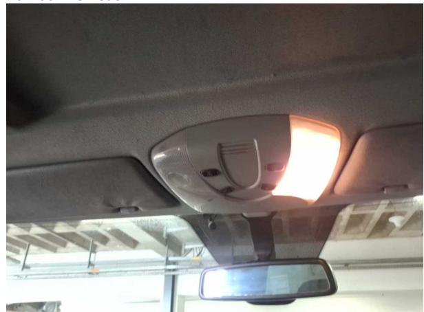
Beschädigung #7: Interieur: Innenraumleuchte vorn - ohne Funktion - erneuern
