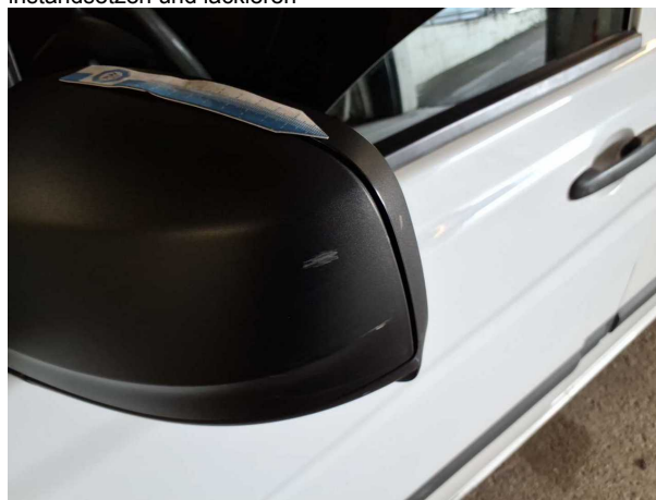
Beschädigung #34: Außenspiegel links: Abdeckkappe - Kratzer
