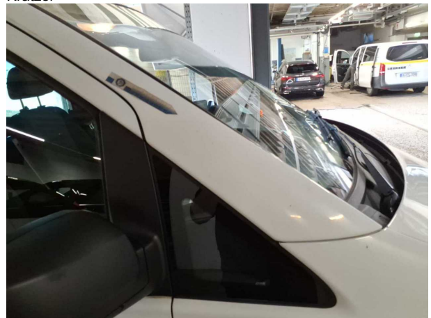
Beschädigung #20: Karosserie: A-Säule rechts - Steinschlag - Smart Repair
