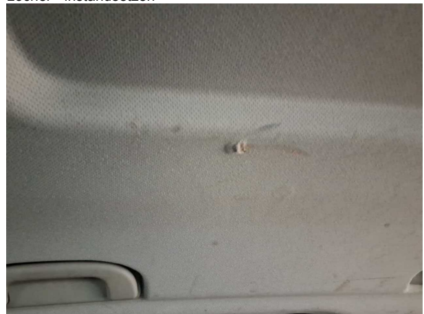
Beschädigung #5: Verkleidungen/Abdeckungen: Dachhimmel... Kratzer - Smart Repair
