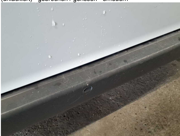
Beschädigung #26: Stossfänger hinten: Stossfänger hinten (unlackiert) - gebrochen / gerissen - erneuern
