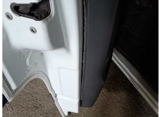
Beschädigung #37: Verkleidungen/Abdeckungen: Türverkleidung vorn links - lose - instandsetzen
