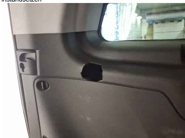
Beschädigung #4: Interieur: Innenraum (Verkleidungen) - Löcher - instandsetzen
