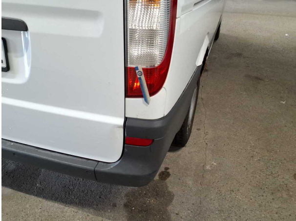
Beschädigung #27: Stossfänger hinten: Schutzleiste rechts - verkratzt / verschürft - Smart Repair
