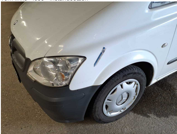
Beschädigung #38: Kotflügel links: Kotflügel links - Kratzer - instandsetzen und lackieren
