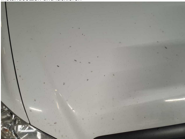
Beschädigung #14: Motorhaube: Motorhaube - Steinschlag - instandsetzen und lackieren
