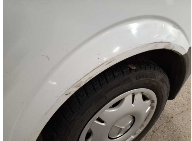
Beschädigung #17: Kotflügel rechts: Kotflügel rechts - Korrosion - erneuern
