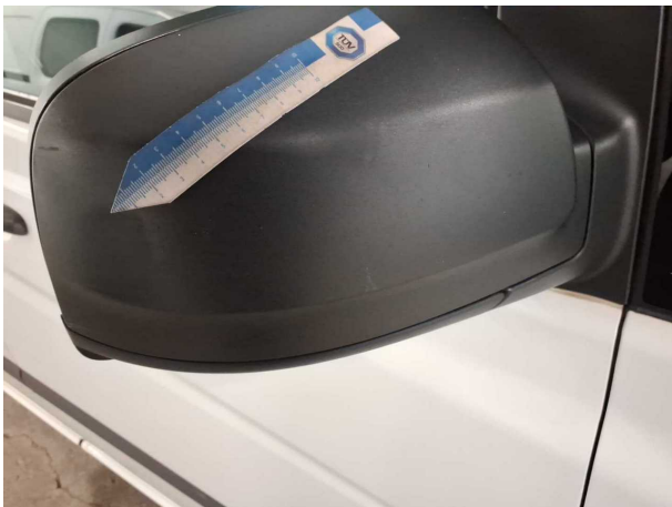
Beschädigung #19: Außenspiegel rechts: Abdeckkappe - Kratzer
