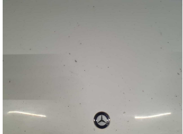
Beschädigung #14: Motorhaube: Motorhaube - Steinschlag - instandsetzen und lackieren
