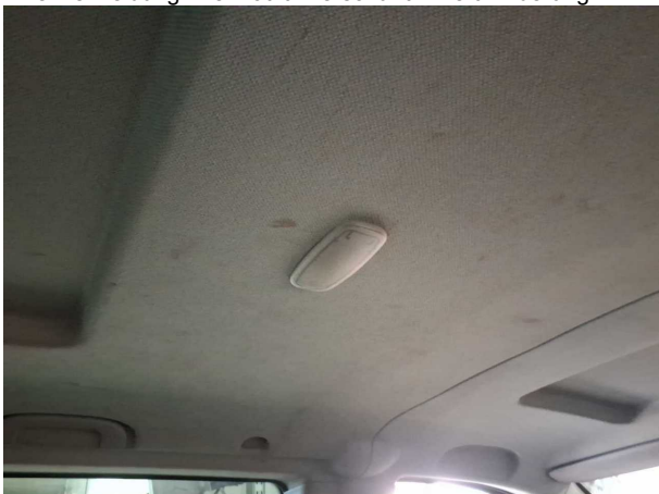
Beschädigung #7: Interieur: Innenraumleuchte vorn - ohne Funktion - erneuern
