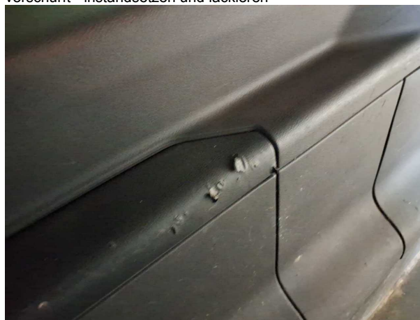
Beschädigung #24: Verkleidungen/Abdeckungen: Kofferraumverkleidung (Rechts mit Schiebetür) - Kratzer
