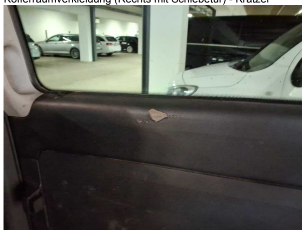
Beschädigung #24: Verkleidungen/Abdeckungen: Kofferraumverkleidung (Rechts mit Schiebetür) - Kratzer
