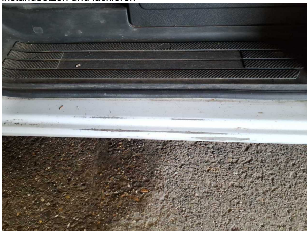
Beschädigung #32: Schweller links: Schweller - Korrosion - instandsetzen und lackieren
