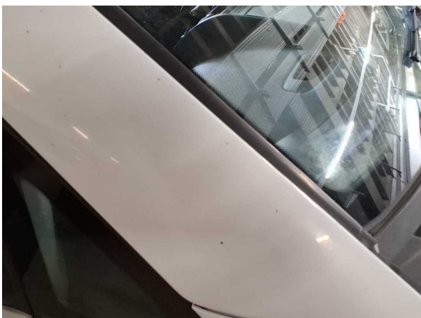
Beschädigung #20: Karosserie: A-Säule rechts - Steinschlag - Smart Repair
