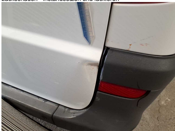
Beschädigung #29: Heckklappe/-tür: Heckklappe - Delle / Lackschaden - instandsetzen und lackieren
