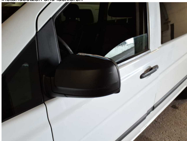
Beschädigung #34: Außenspiegel links: Abdeckkappe - Kratzer
