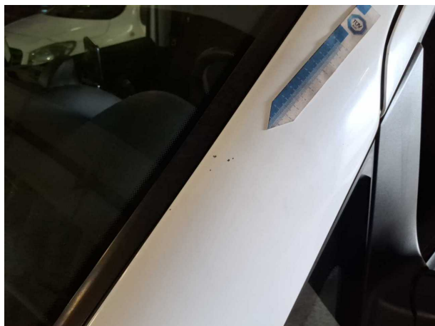
Beschädigung #39: Karosserie: A-Säule links - Steinschlag - Smart Repair
