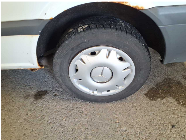
Beschädigung #12: Rad/Reifen: Radblende hinten links - gebrochen / gerissen - erneuern
