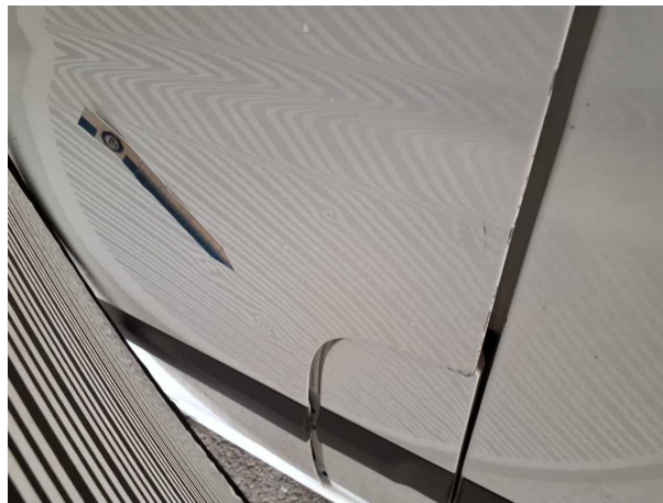
Beschädigung #33: Tür vorn links: Tür - Delle / Lackschaden - instandsetzen und lackieren
