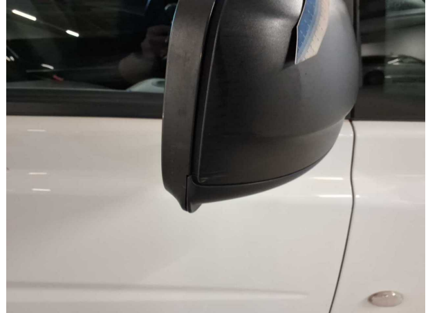
Beschädigung #19: Außenspiegel rechts: Abdeckkappe - Kratzer
