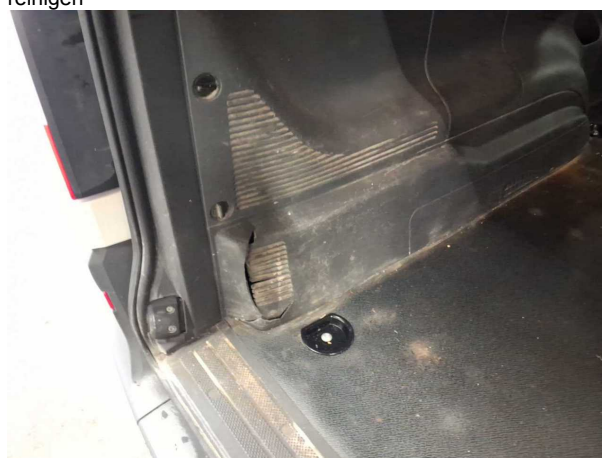
Beschädigung #2: Verkleidungen/Abdeckungen: Kofferraumverkleidung (Links) - gebrochen / gerissen -
