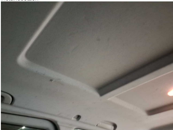
Beschädigung #5: Verkleidungen/Abdeckungen: Dachhimmel - Kratzer - Smart Repair
