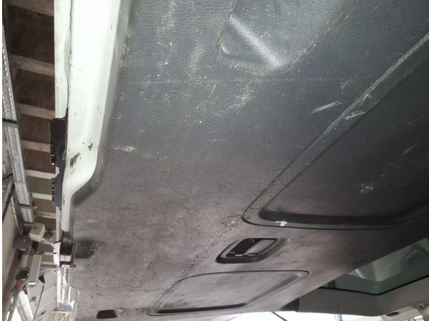
Beschädigung #6: Verkleidungen/Abdeckungen: Heckdeckel, Innenverkleidung - verkratzt / verschürft - Wertminderung
