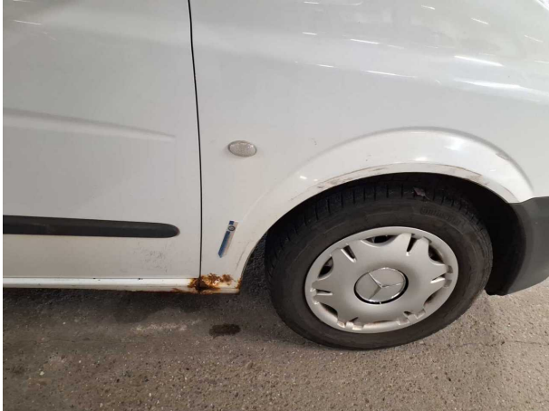
Beschädigung #17: Kotflügel rechts: Kotflügel rechts - Korrosion - erneuern
