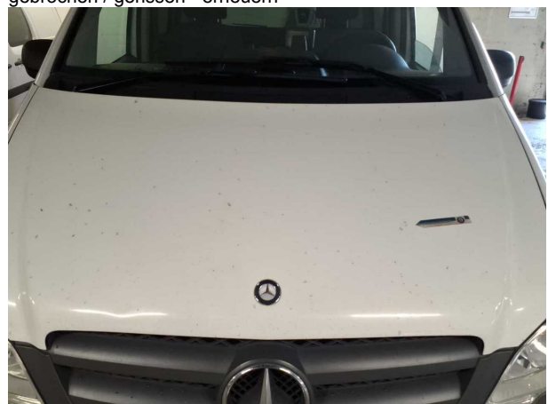
Beschädigung #14: Motorhaube: Motorhaube - Steinschlag - instandsetzen und lackieren
