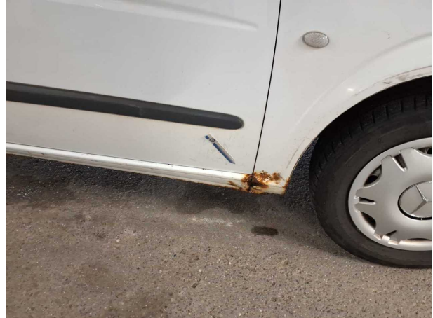
Beschädigung #18: Schweller rechts: Schweller - Korrosion - instandsetzen und lackieren
