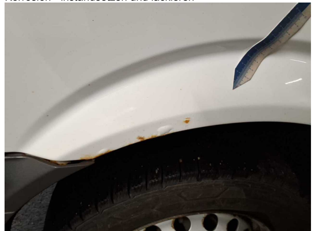
Beschädigung #25: Seitenwand rechts: Seitenwand - Korrosion - instandsetzen und lackieren
