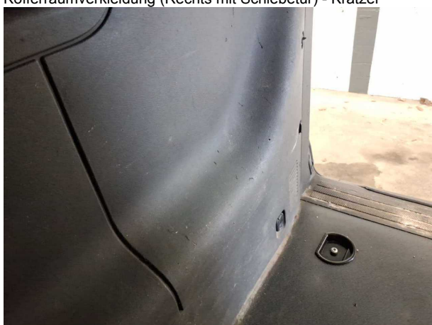
Beschädigung #24: Verkleidungen/Abdeckungen: Kofferraumverkleidung (Rechts mit Schiebetür) - Kratzer
