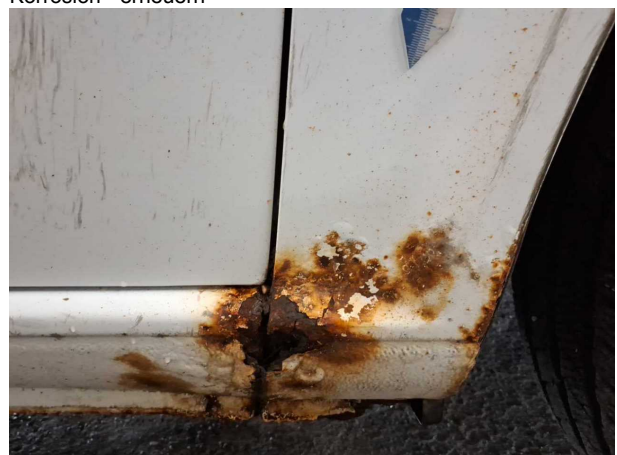
Beschädigung #17: Kotflügel rechts: Kotflügel rechts - Korrosion - erneuern
