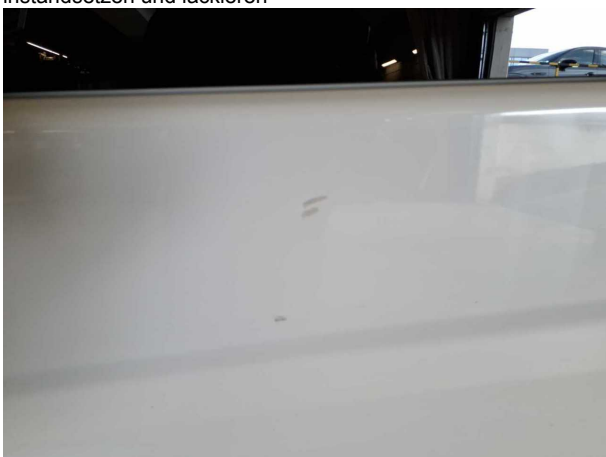
Beschädigung #31: Seitenwand links: Seitenwand - Korrosion - instandsetzen und lackieren
