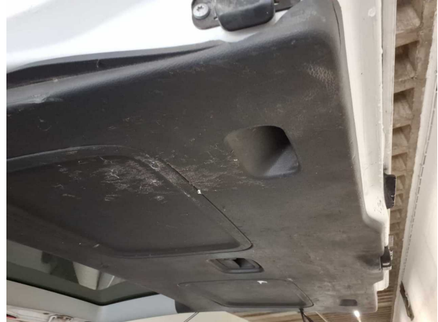
Beschädigung #6: Verkleidungen/Abdeckungen: Heckdeckel, Innenverkleidung - verkratzt / verschürft - Wertminderung
