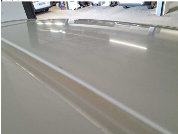
Beschädigung #22: Fahrzeugdach: Dach - Kratzer - auslegen / polieren
