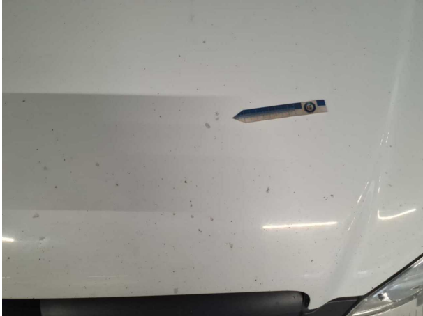
Beschädigung #14: Motorhaube: Motorhaube - Steinschlag - instandsetzen und lackieren
