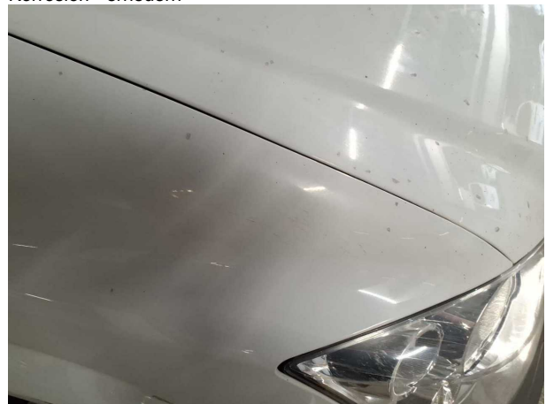
Beschädigung #17: Kotflügel rechts: Kotflügel rechts - Korrosion - erneuern
