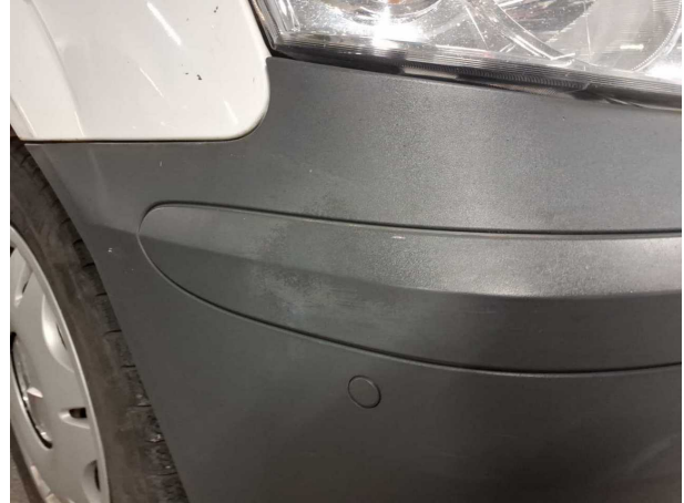
Beschädigung #16: Stossfänger vorn: Stossfänger vorn (unlackiert) - beschädigt - erneuern
