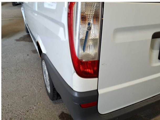
Beschädigung #30: Heckleuchte: Heckleuchte links - gebrochen / gerissen - erneuern
