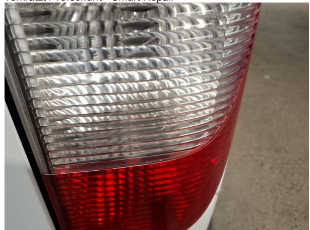
Beschädigung #28: Heckleuchte: Heckleuchte rechts - Kratzer
