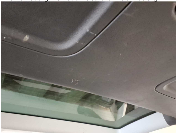
Beschädigung #6: Verkleidungen/Abdeckungen: Heckdeckel, Innenverkleidung - verkratzt / verschürft - Wertminderung
