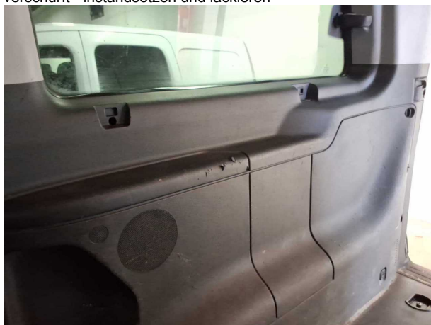
Beschädigung #24: Verkleidungen/Abdeckungen: Kofferraumverkleidung (Rechts mit Schiebetür) - Kratzer
