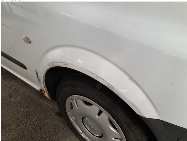
Beschädigung #17: Kotflügel rechts: Kotflügel rechts - Korrosion - erneuern
