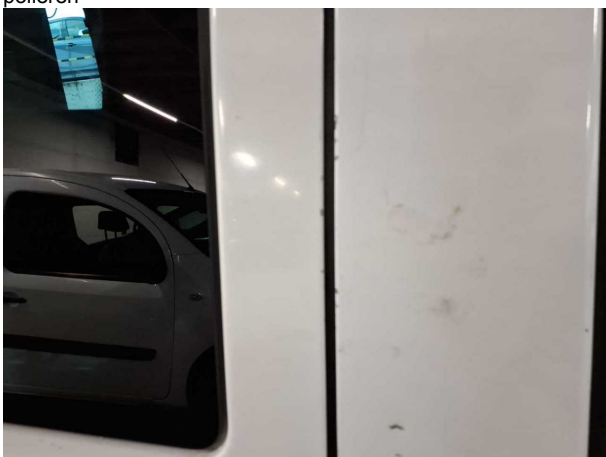
Beschädigung #23: Schiebetür rechts: Schiebetür - verkratzt / verschürft - instandsetzen und lackieren
