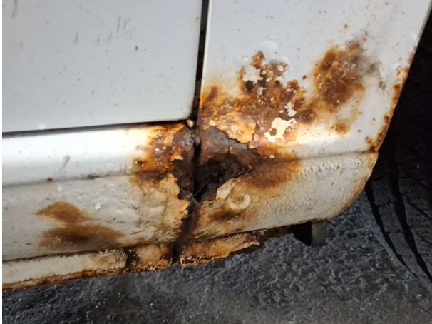
Beschädigung #17: Kotflügel rechts: Kotflügel rechts - Korrosion - erneuern
