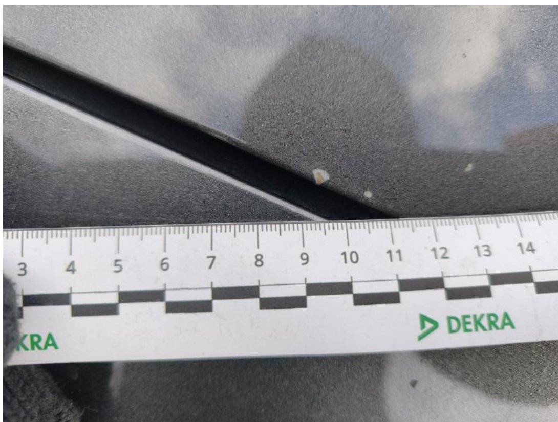
Fot. 38 Pokrywa komory silnika - Rysa/odprysk 1
