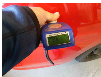
Lackstärke Seitenwand hinten rechts
