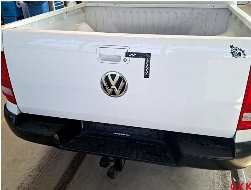
Bild 29 Heckklappe, 4 bis 10 Dellen / Bauteil, kalt drücken
