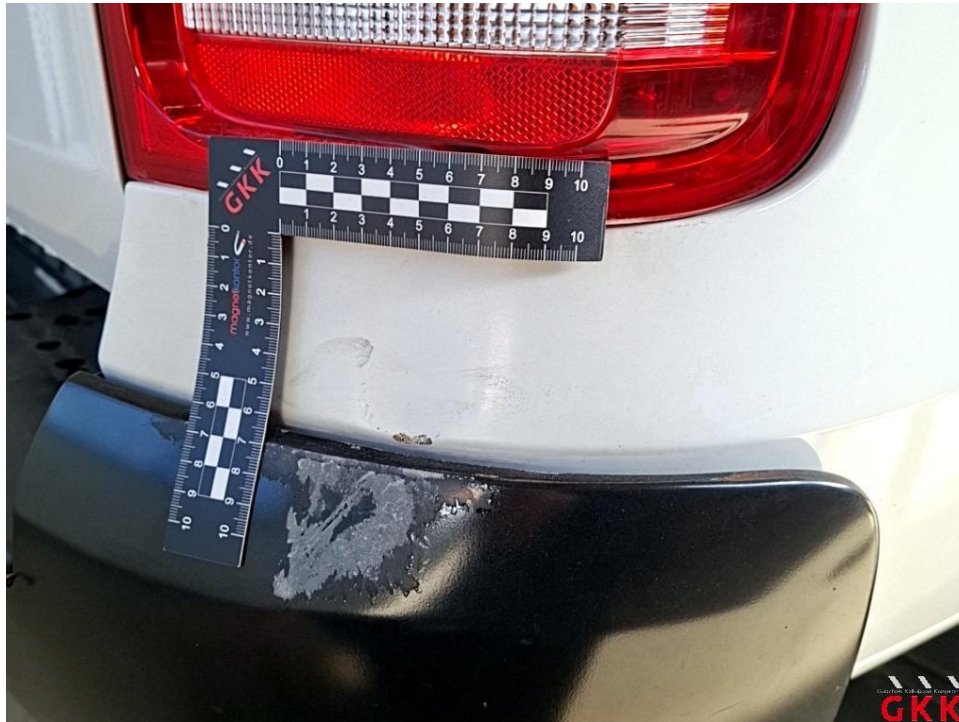
Bild 27 Seitenwand rechts, unterhalb, beschädigt, instand setzen - lackieren
