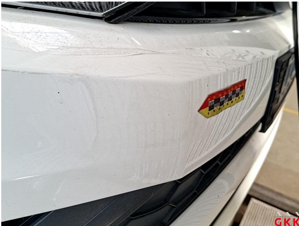
Bild 18 Stoßfänger vorne, Verkleidung -lackiert-, Reparaturmangel, ersetzen
