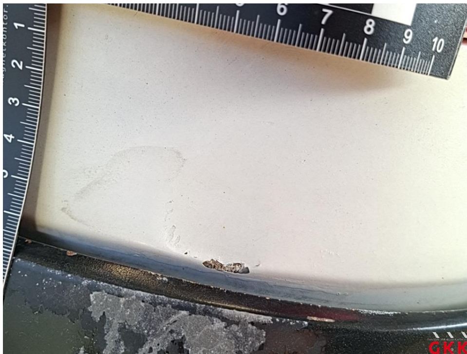
Bild 28 Seitenwand rechts, unterhalb, beschädigt, instand setzen - lackieren
