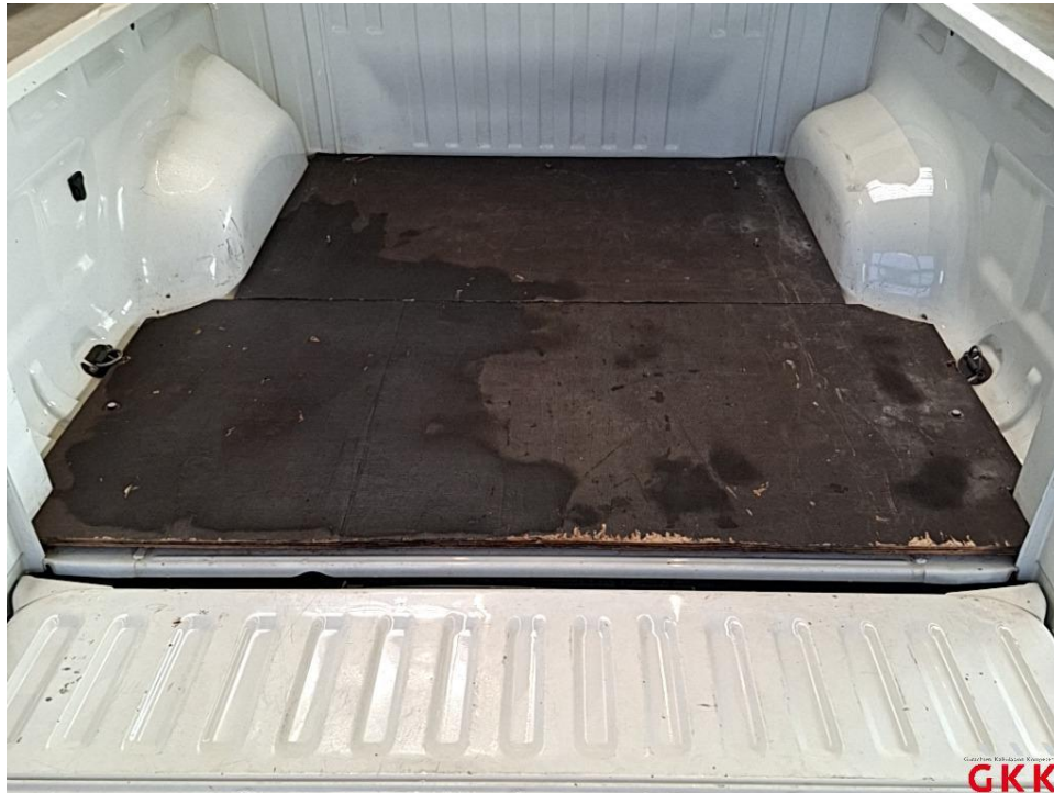
Bild 21 Laderaum, Bodenbelag Holz, beschädigt, ersetzen
