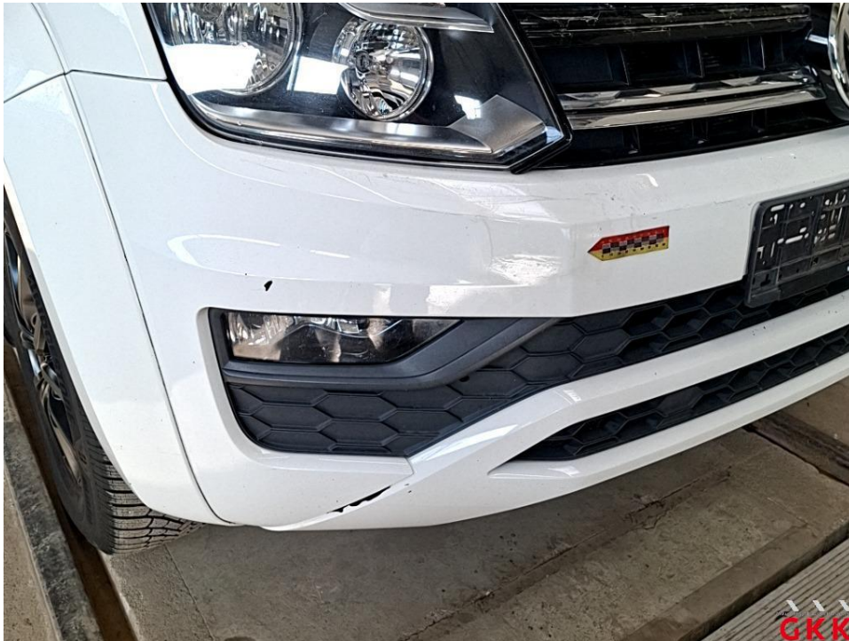
Bild 17 Stoßfänger vorne, Verkleidung -lackiert-, Reparaturmangel, ersetzen
