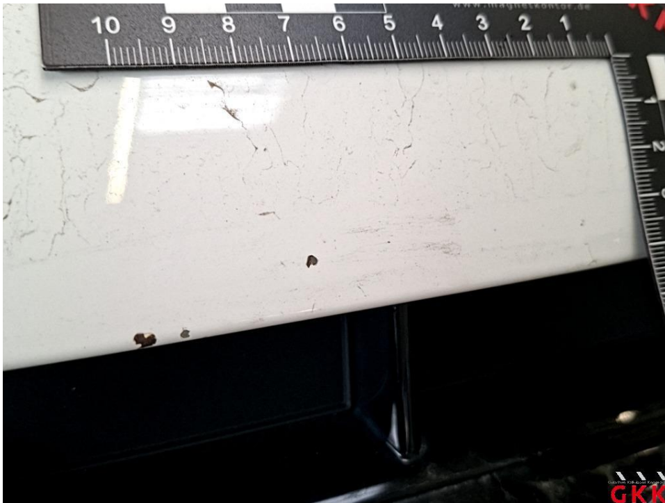
Bild 14 Motorhaube, Steinschlag, Smartrepair
