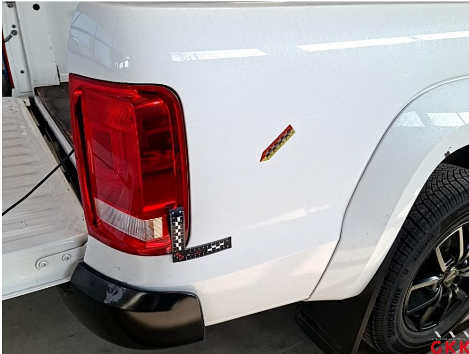
Bild 19 Seitenwand rechts, beschädigt, instand setzen - lackieren
