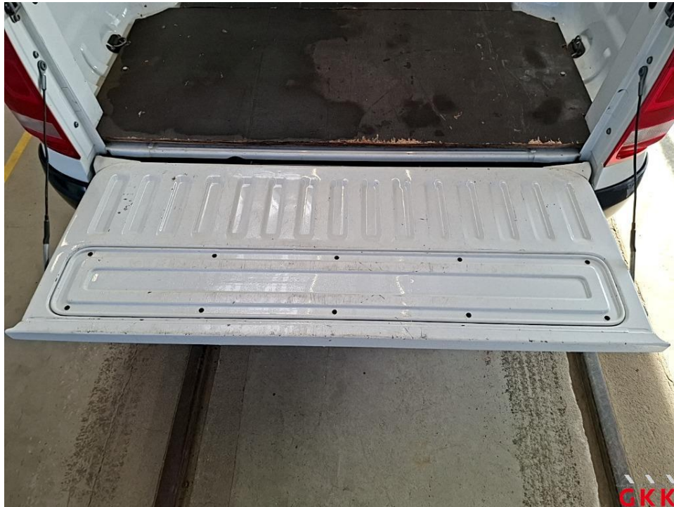
Bild 23 Heckklappe, innen, verkratzt, lackieren
