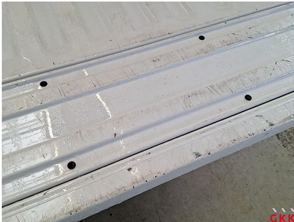
Bild 24 Heckklappe, innen, verkratzt, lackieren
