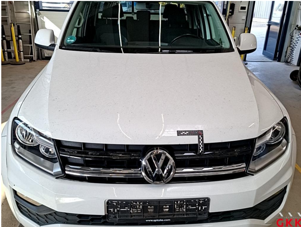
Bild 13 Motorhaube, Steinschlag, Smartrepair
