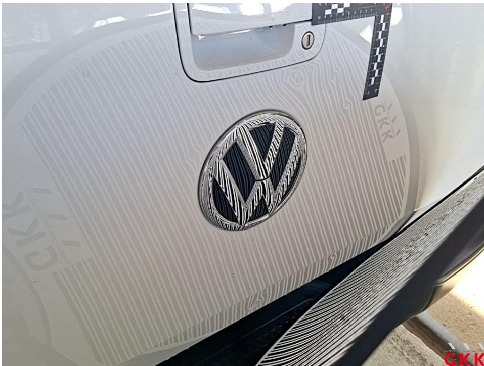
Bild 30 Heckklappe, 4 bis 10 Dellen / Bauteil, kalt drücken
