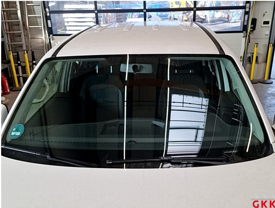
Bild 15 Frontscheibe, Steinschlag im Sichtfeld, ersetzen
