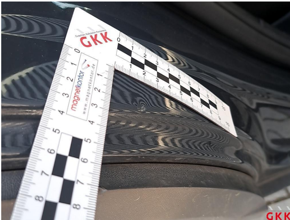
Bild 28 Tür hinten rechts, Einstieg, beschädigt, Smartrepair
