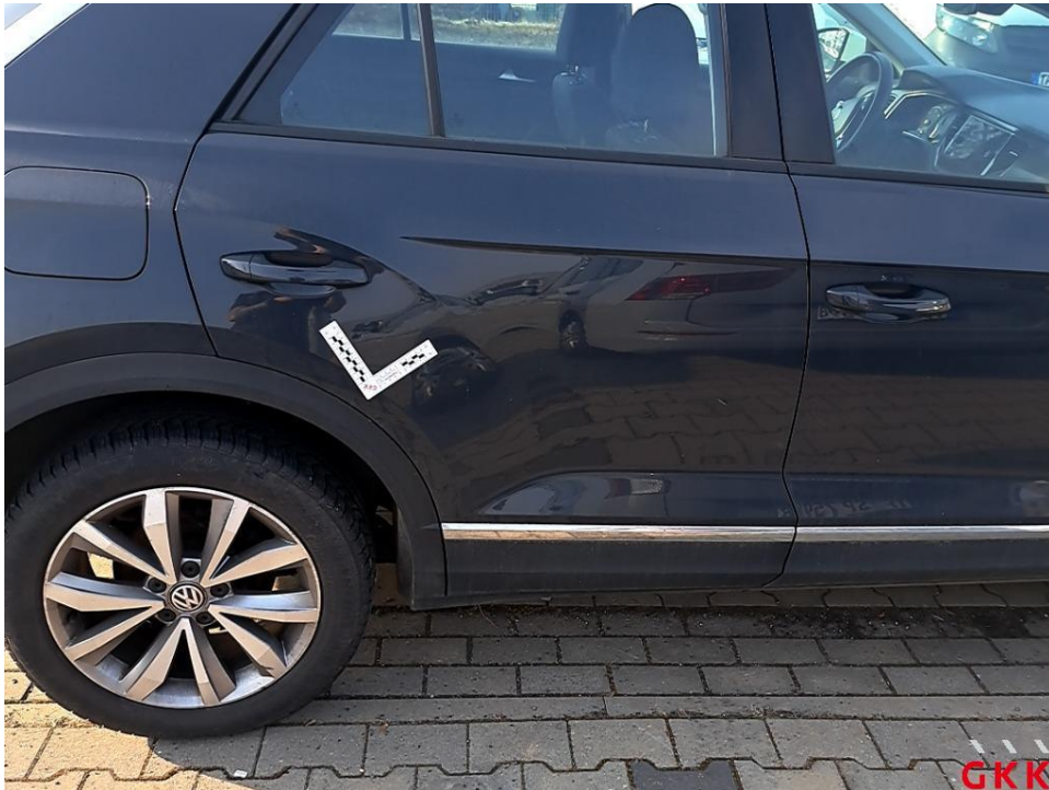
Bild 25 Tür hinten rechts, beschädigt, instand setzen - lackieren
