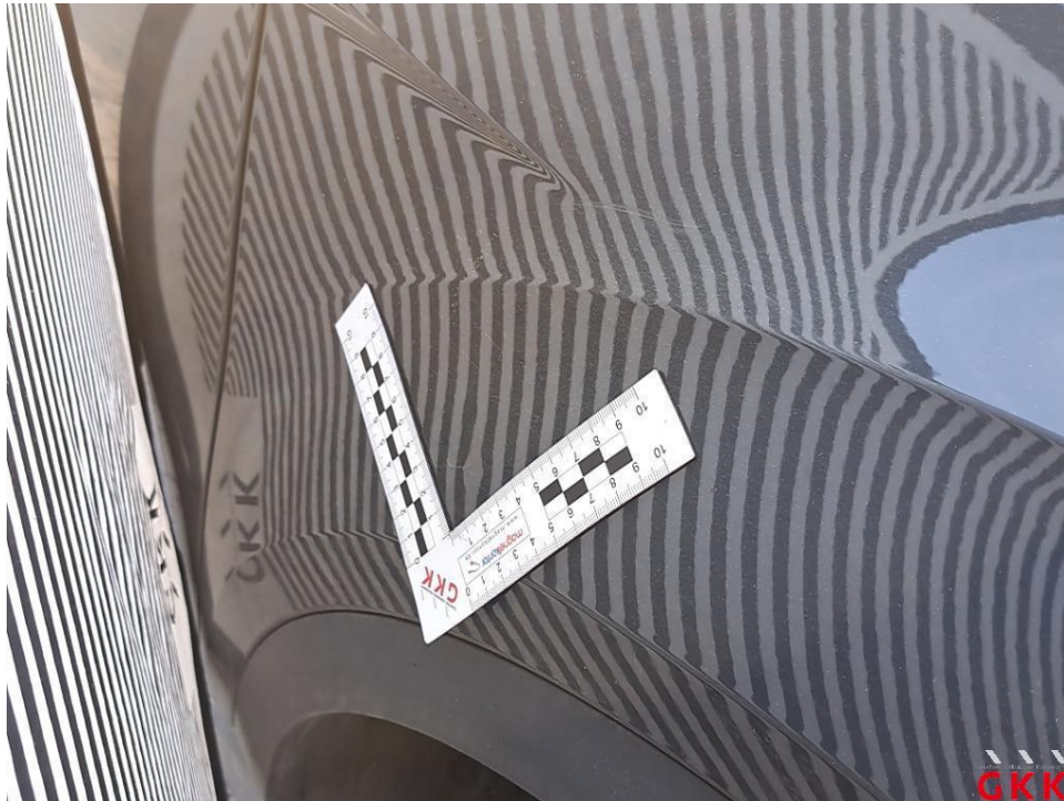
Bild 21 Kotflügel vorne rechts, bis 3 Dellen / Bauteil, kalt drücken
