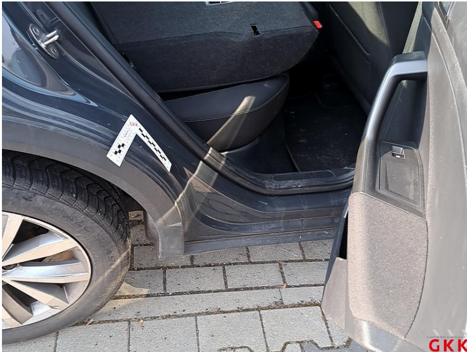
Bild 27 Tür hinten rechts, Einstieg, beschädigt, Smartrepair
