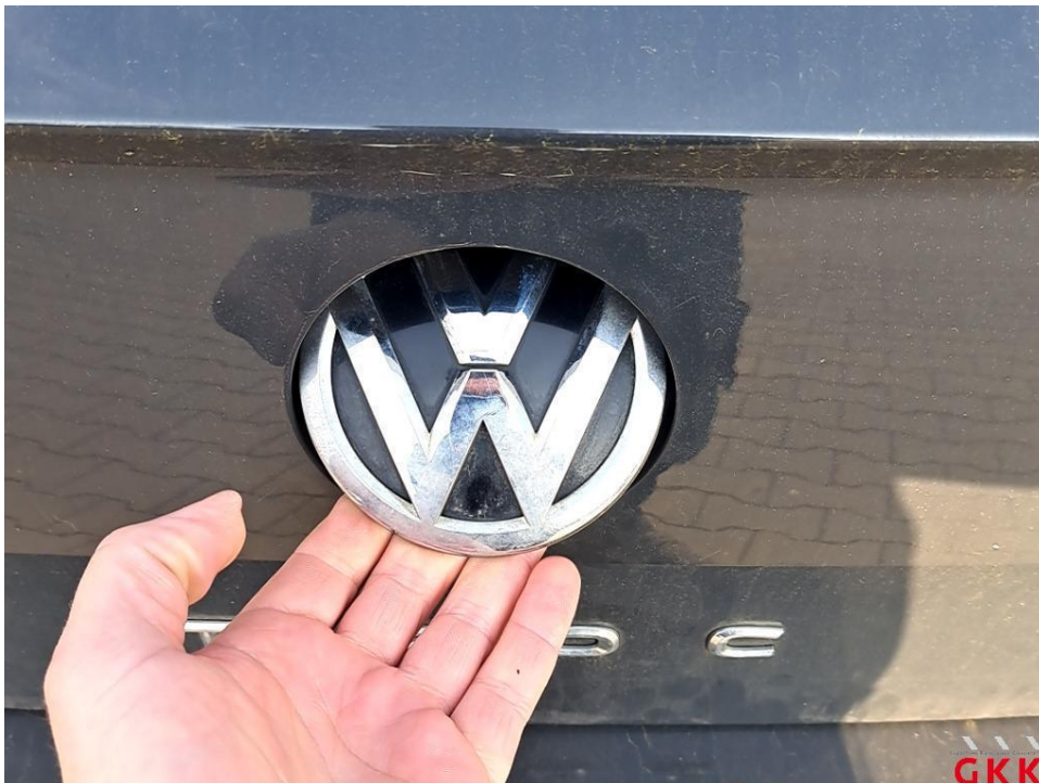
Bild 16 Heckklappe, Schloss, defekt, ersetzen
