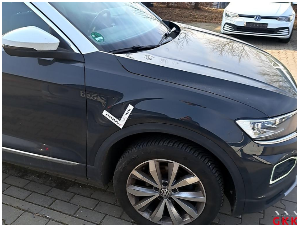
Bild 20 Kotflügel vorne rechts, bis 3 Dellen / Bauteil, kalt drücken
