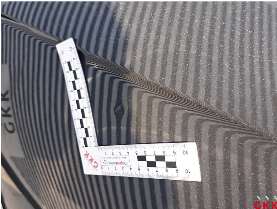
Bild 24 Tür hinten links, beschädigt, instand setzen - lackieren
