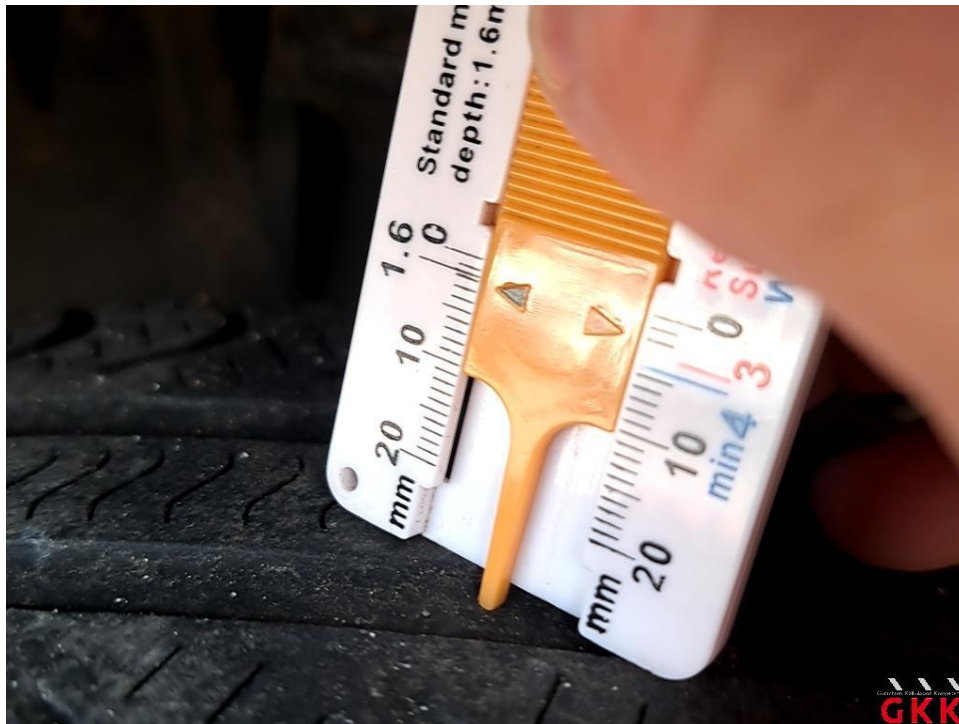
Bild 19 Reifen, vorn links und rechts, Untermaß, ersetzen
