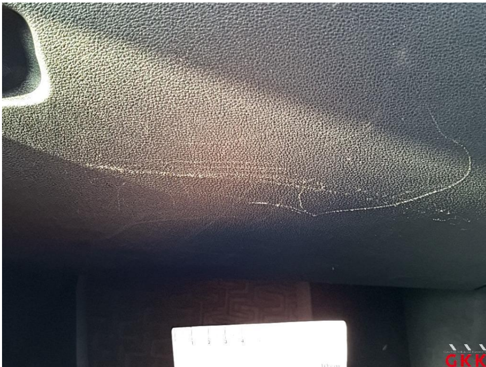
Bild 38 Handschuhfach, Deckel, verkratzt, ersetzen
