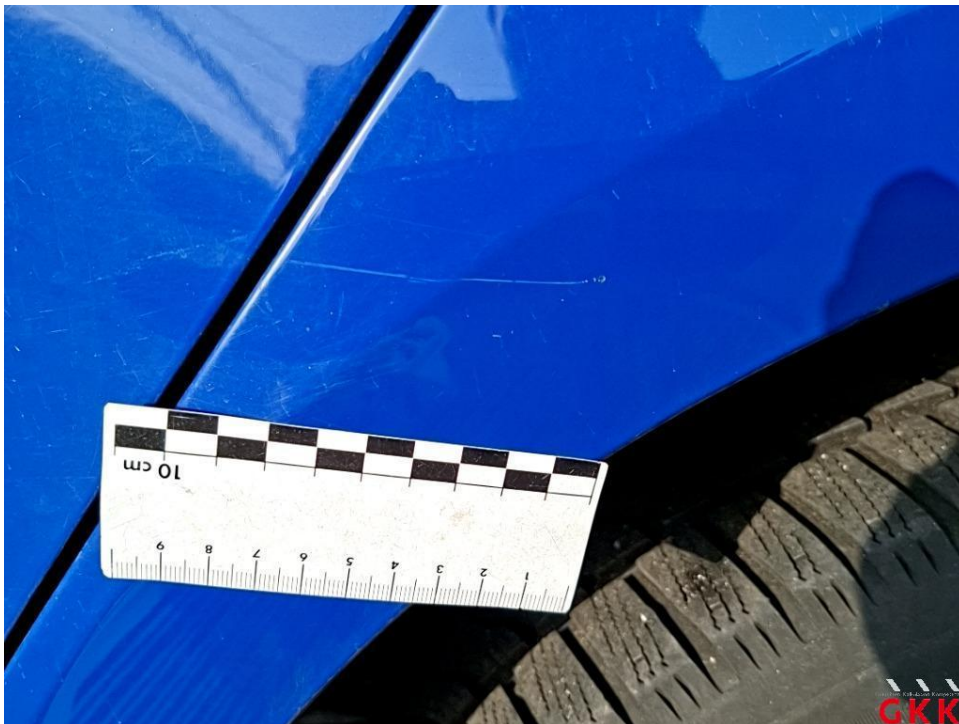
Bild 16 Seitenwand links, beschädigt, instand setzen - lackieren
