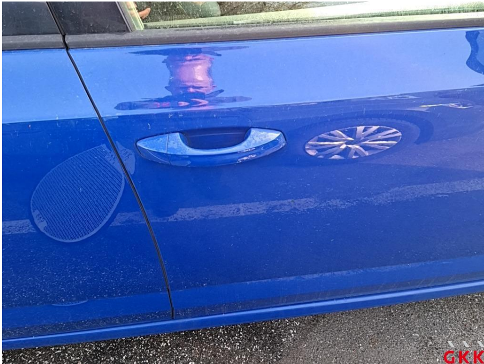
Bild 23 Tür vorne rechts, Griff, verkratzt, lackieren
