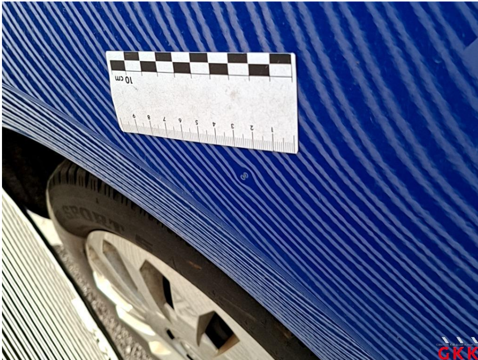
Bild 15 Seitenwand links, beschädigt, instand setzen - lackieren
