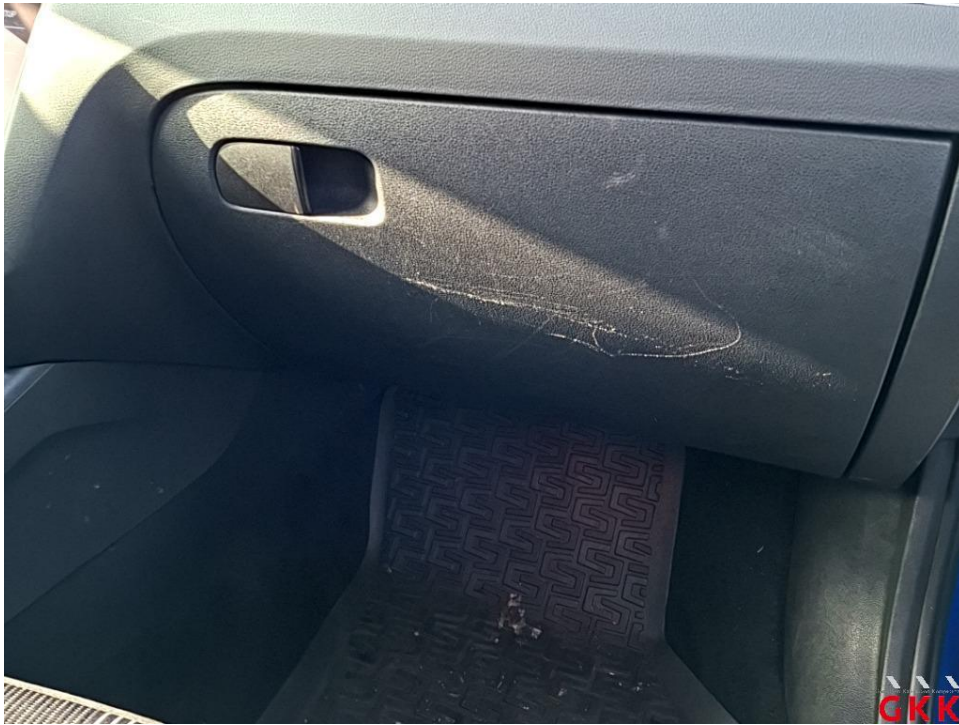
Bild 37 Handschuhfach, Deckel, verkratzt, ersetzen
