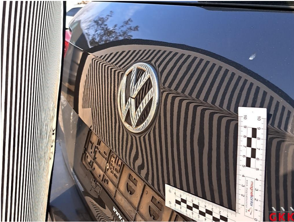
Bild 29 Heckklappe, beschädigt, instand setzen - lackieren
