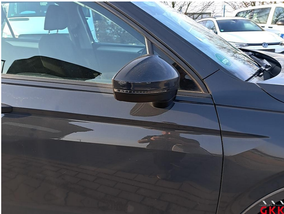
Bild 38 Spiegelgehäuse rechts, Blinker, verkratzt, ersetzen
