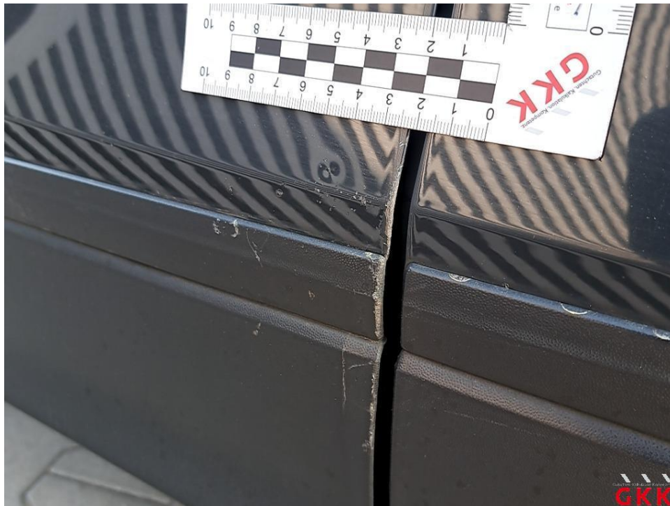
Bild 17 Tür vorne links, beschädigt, instand setzen - lackieren
