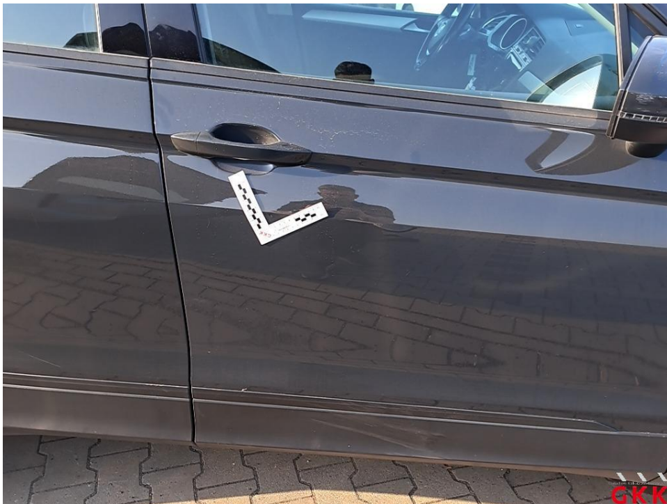
Bild 34 Tür vorne rechts, bis 3 Dellen / Bauteil, Smartrepair
