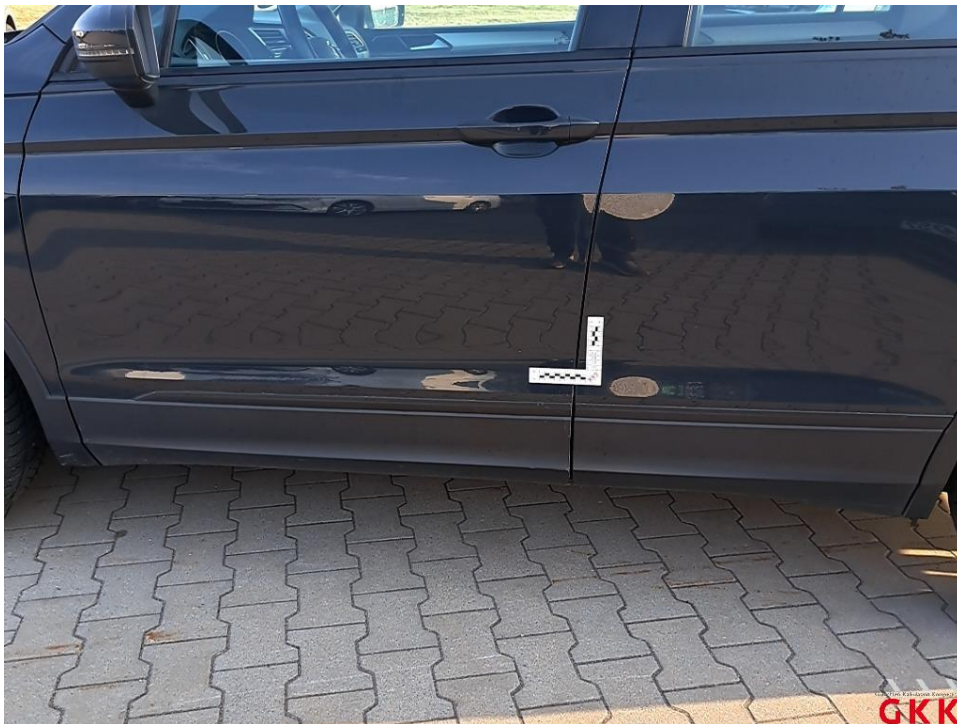
Bild 16 Tür vorne links, beschädigt, instand setzen - lackieren
