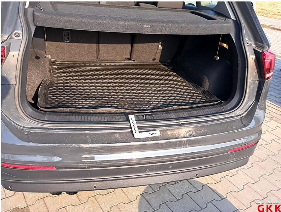
Bild 20 Stoßfänger hinten, Verkleidung -lackiert-, verkratzt, lackieren
