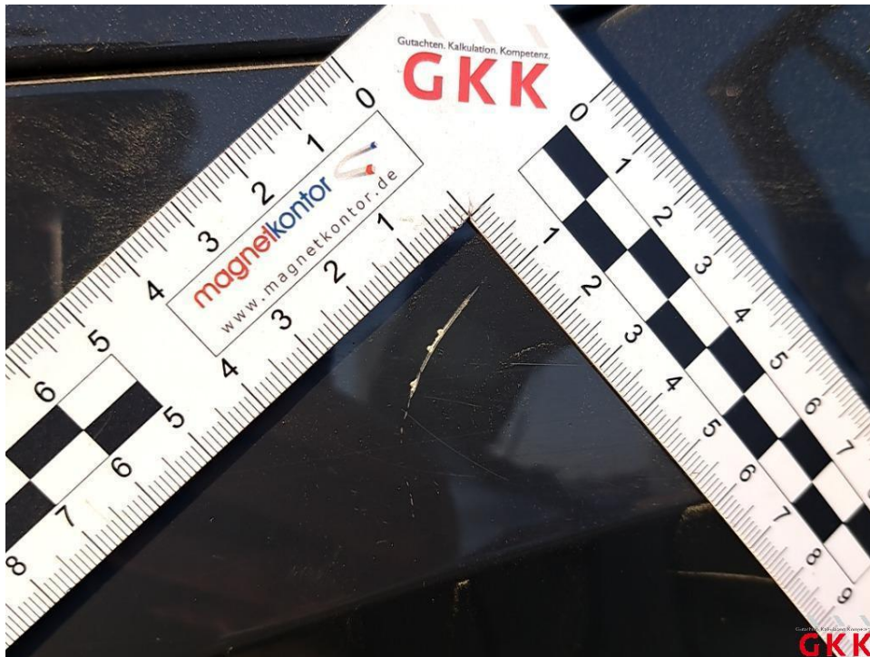
Bild 31 Seitenwand rechts, verkratzt, lackieren
