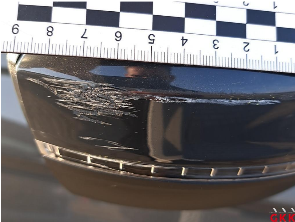
Bild 37 Spiegelgehäuse rechts, Blende -lackiert-, verkratzt, ersetzen
