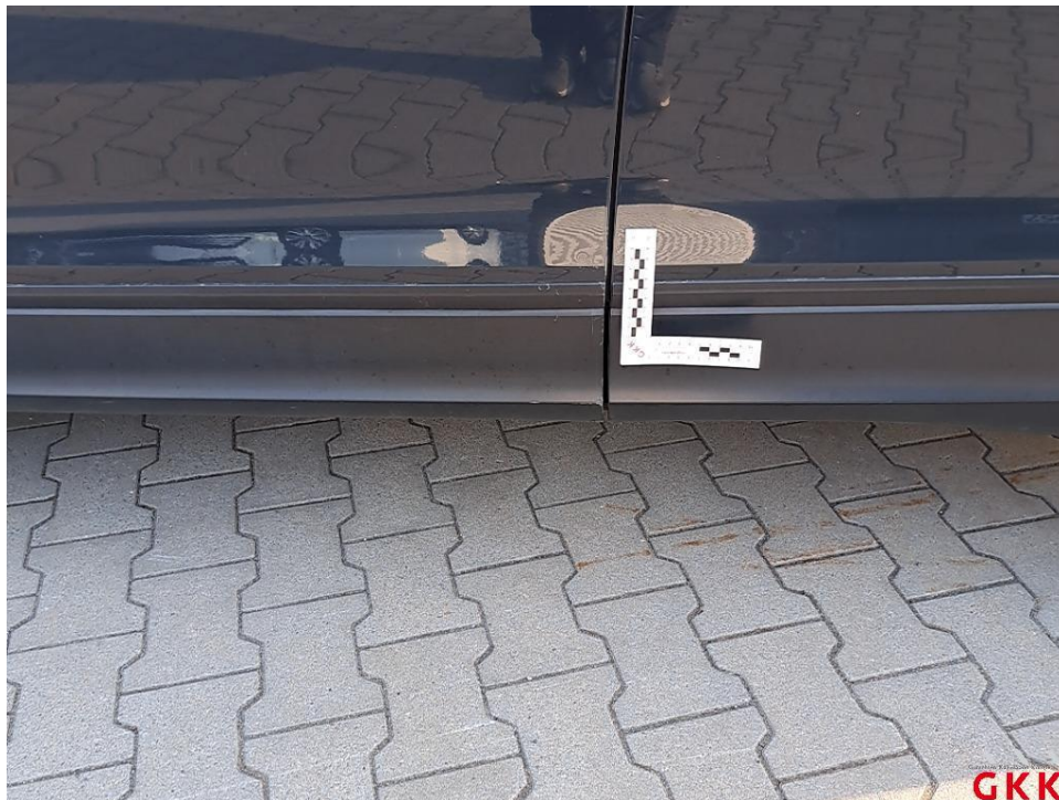
Bild 18 Tür vorne links, Leiste unten -unlackiert-, beschädigt, ersetzen
