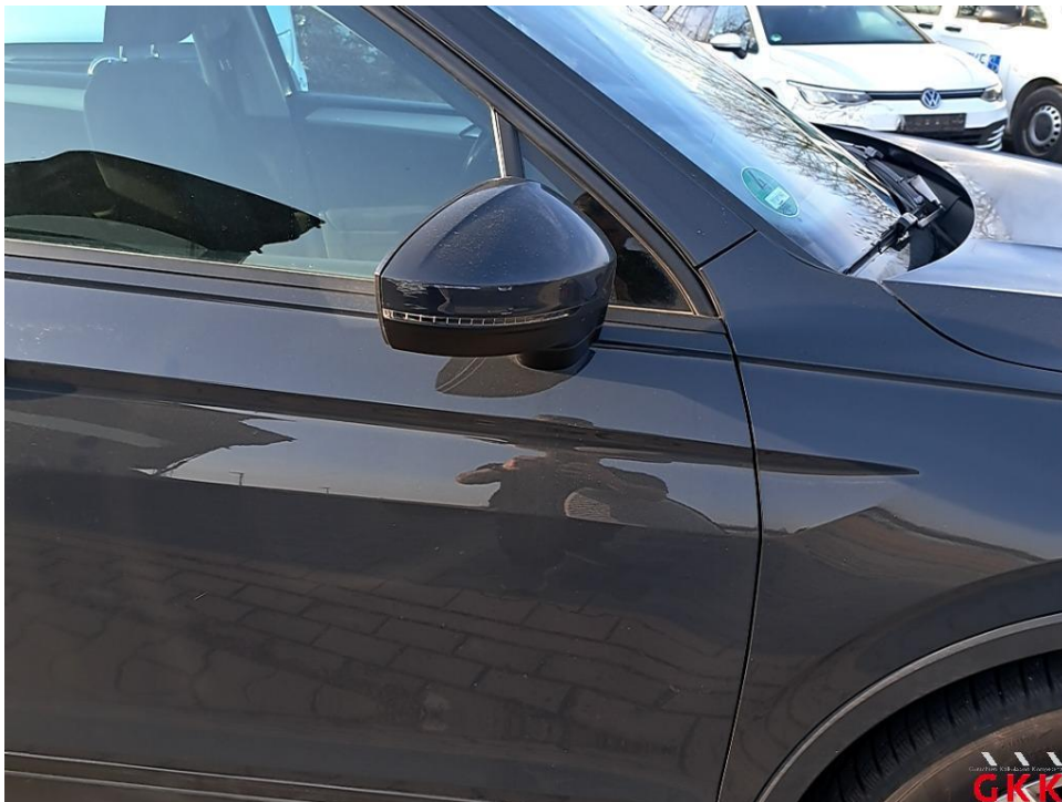
Bild 36 Spiegelgehäuse rechts, Blende -lackiert-, verkratzt, ersetzen
