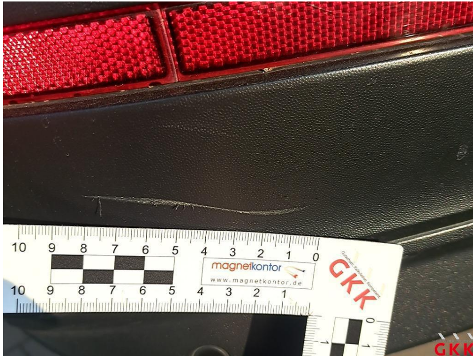
Bild 23 Stoßfänger hinten, Verkleidung unterhalb -unlackiert-, verkratzt, ersetzen
