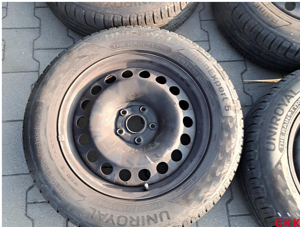
Bild 14 Reifen 1 x beiliegend, Luftdruck zu gering / drucklos, auffüllen
