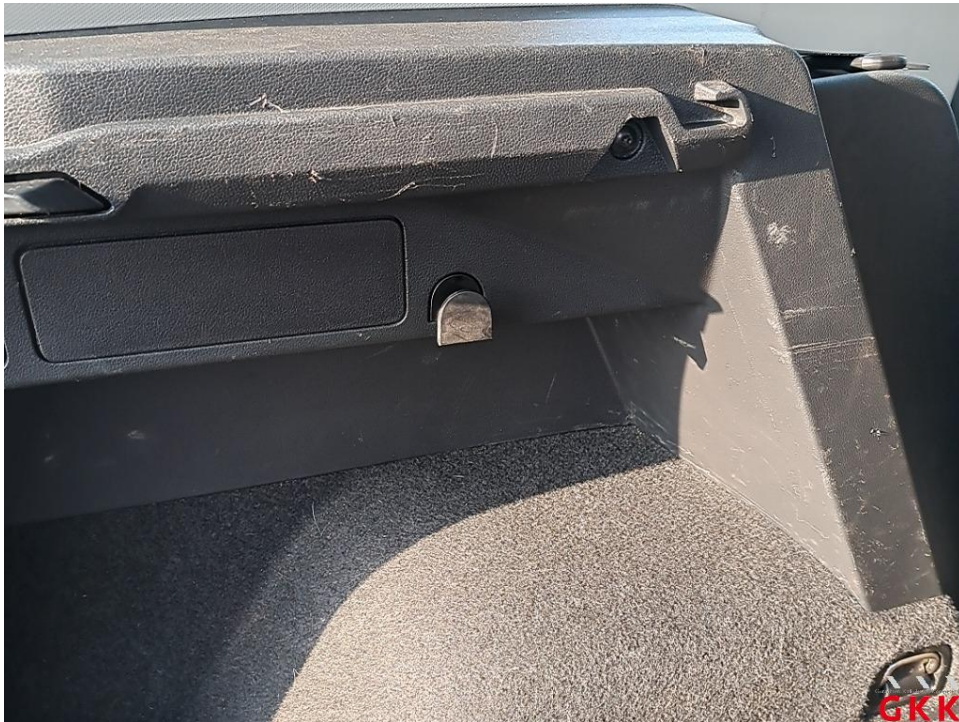
Bild 25 Seitenwand links, Innenverkleidung, verkratzt, ersetzen
