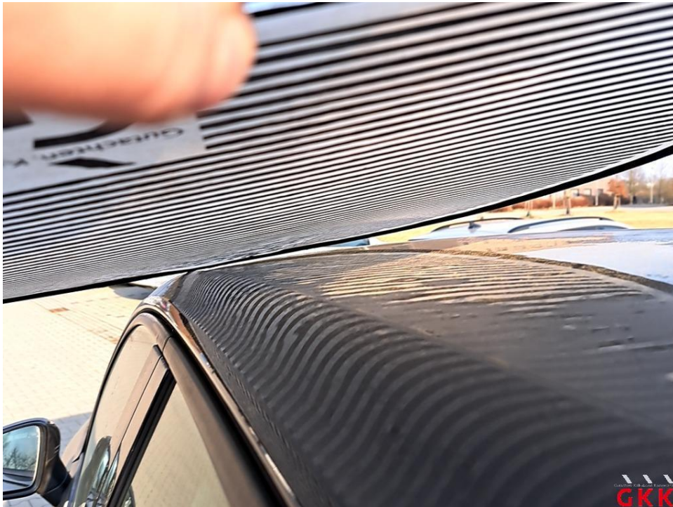
Bild 43 Dachholm Links Fahrzeug, Hagelschaden, instand setzen
