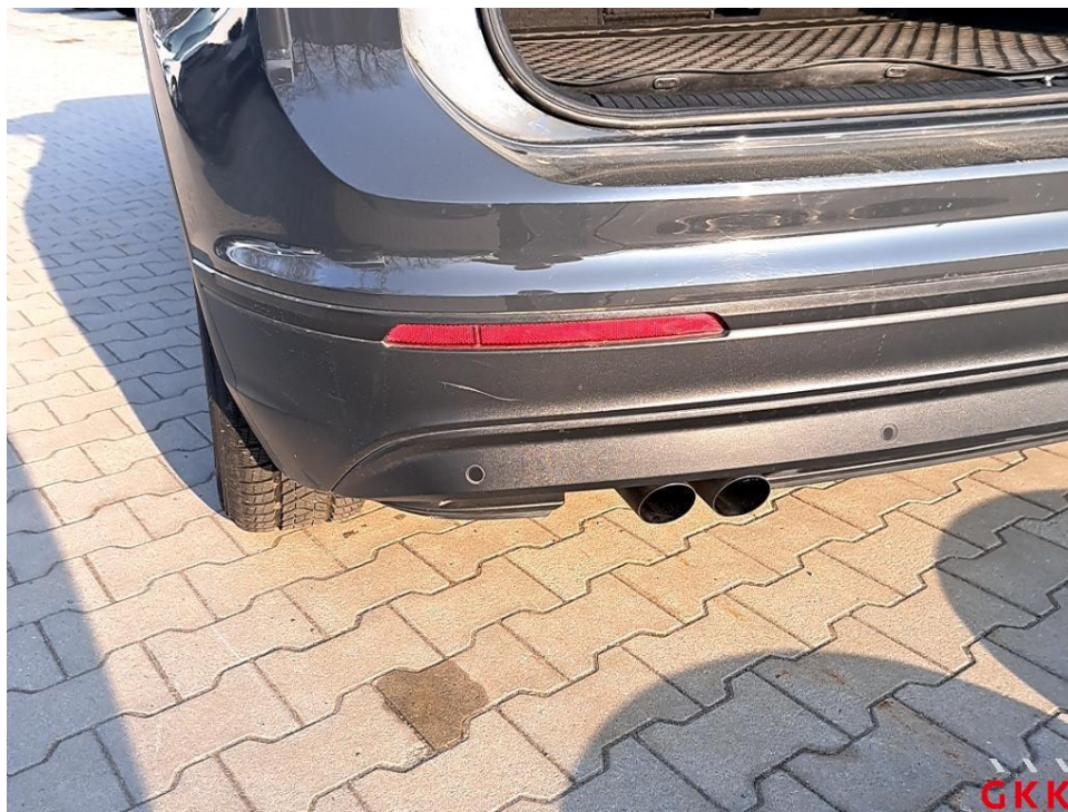
Bild 22 Stoßfänger hinten, Verkleidung unterhalb -unlackiert-, verkratzt, ersetzen
