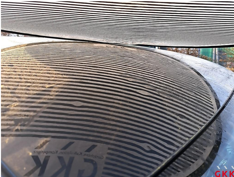
Bild 40 Dach Fahrzeug, Hagelschaden, instand setzen
