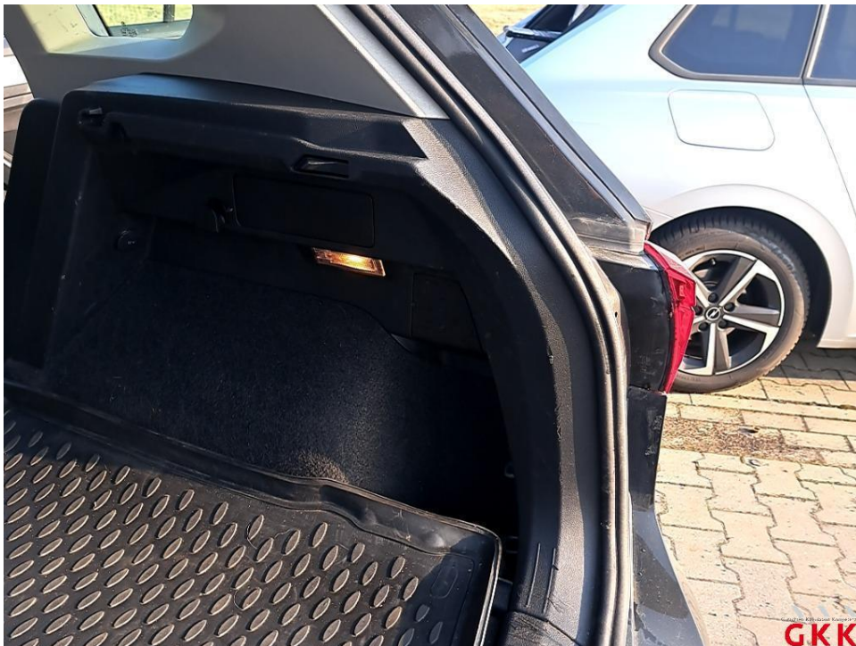
Bild 26 Seitenwand rechts, Innenverkleidung, verkratzt, ersetzen
