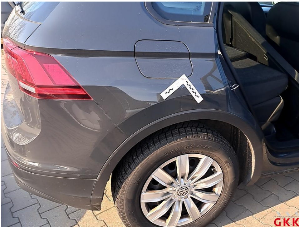
Bild 30 Seitenwand rechts, verkratzt, lackieren
