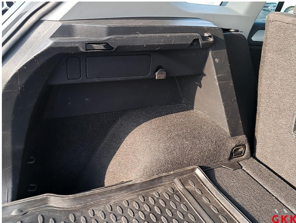
Bild 24 Seitenwand links, Innenverkleidung, verkratzt, ersetzen
