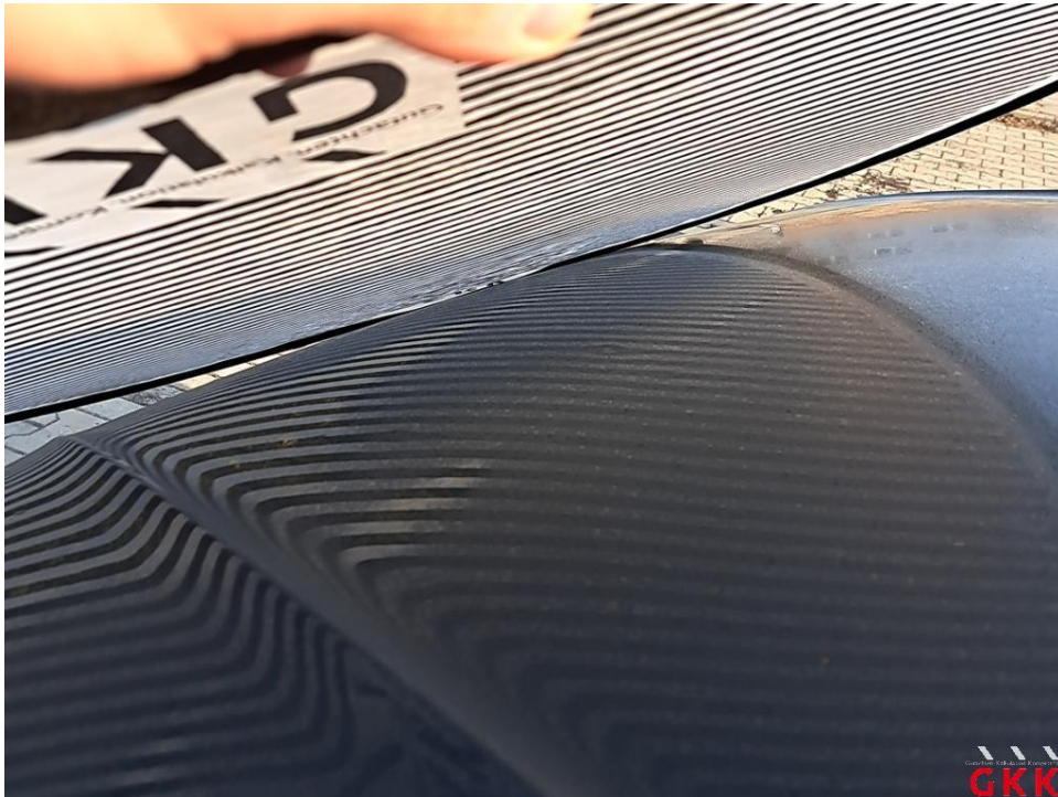
Bild 41 Motorhaube Fahrzeug, Hagelschaden, instand setzen
