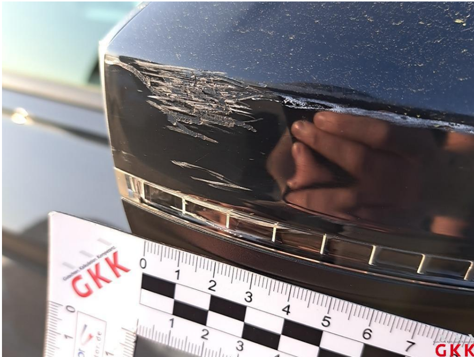
Bild 39 Spiegelgehäuse rechts, Blinker, verkratzt, ersetzen
