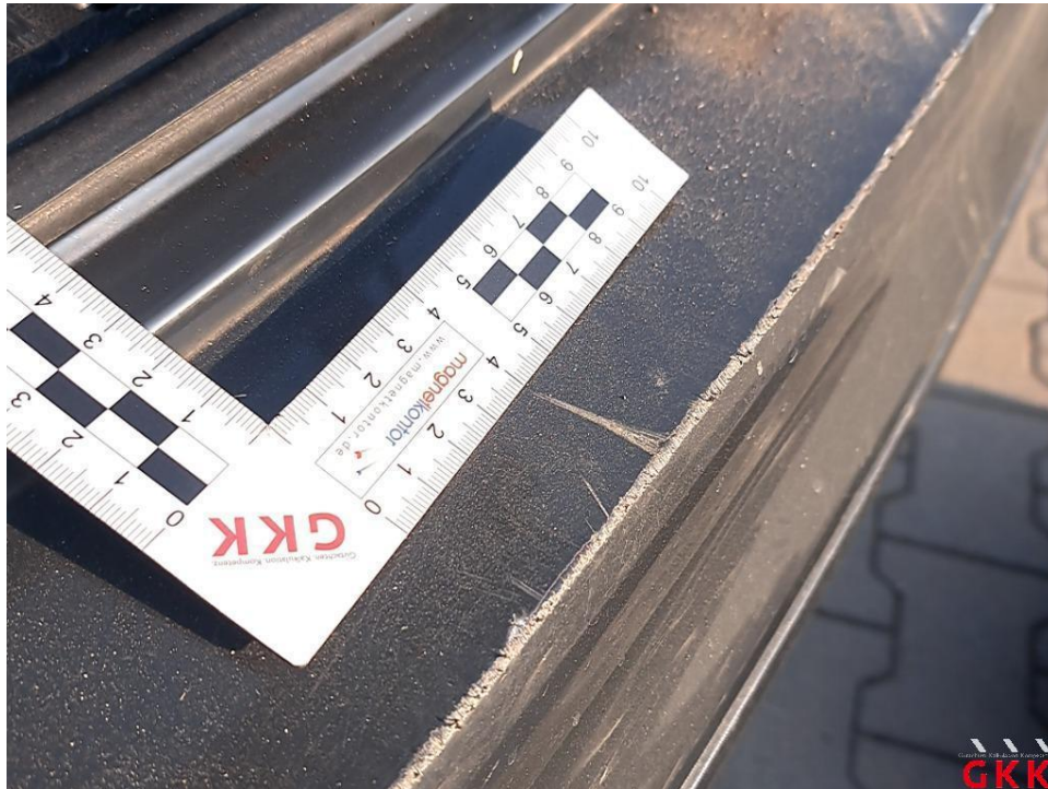
Bild 21 Stoßfänger hinten, Verkleidung -lackiert-, verkratzt, lackieren
