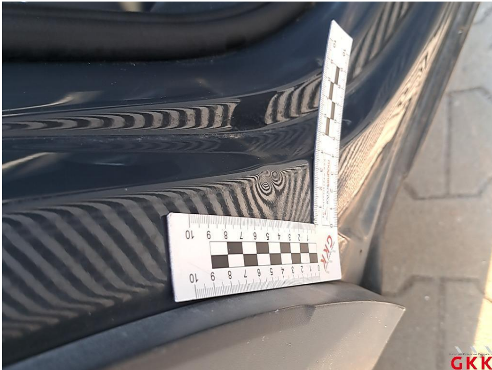
Bild 33 Tür hinten rechts, Einstieg, beschädigt, Smartrepair
