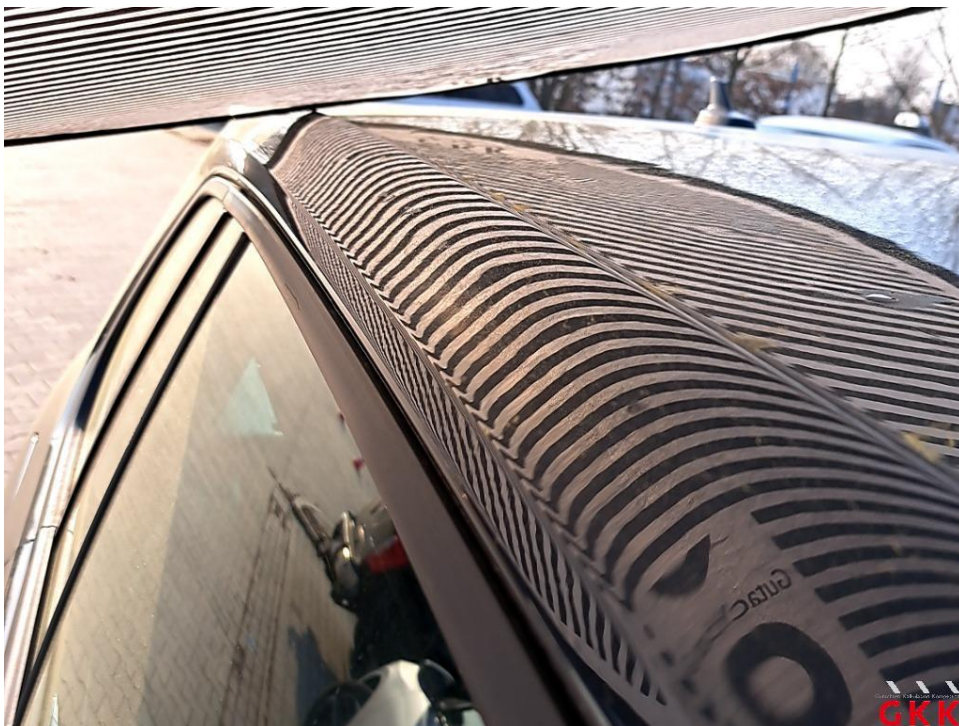
Bild 42 Dachholm rechts Fahrzeug, Hagelschaden, instand setzen
