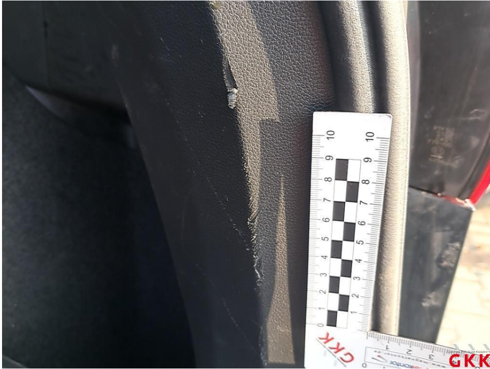
Bild 27 Seitenwand rechts, Innenverkleidung, verkratzt, ersetzen
