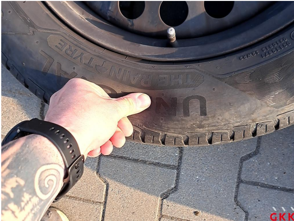
Bild 15 Reifen 1 x beiliegend, Luftdruck zu gering / drucklos, auffüllen
