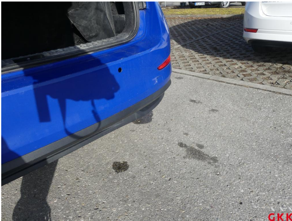
Bild 18 Stoßfänger hinten, PDC-Sensor, lose, ersetzen
