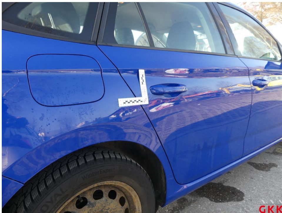
Bild 28 Seitenwand rechts, bis 3 Dellen / Bauteil, instand setzen - lackieren
