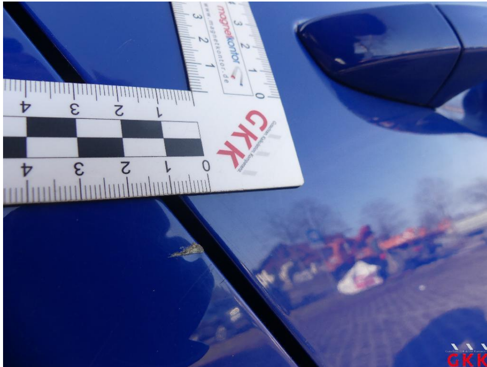
Bild 29 Seitenwand rechts, bis 3 Dellen / Bauteil, instand setzen - lackieren
