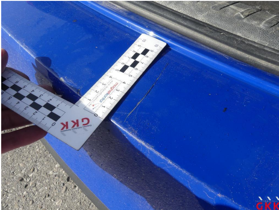
Bild 17 Stoßfänger hinten, Verkleidung -lackiert-, beschädigt, ersetzen
