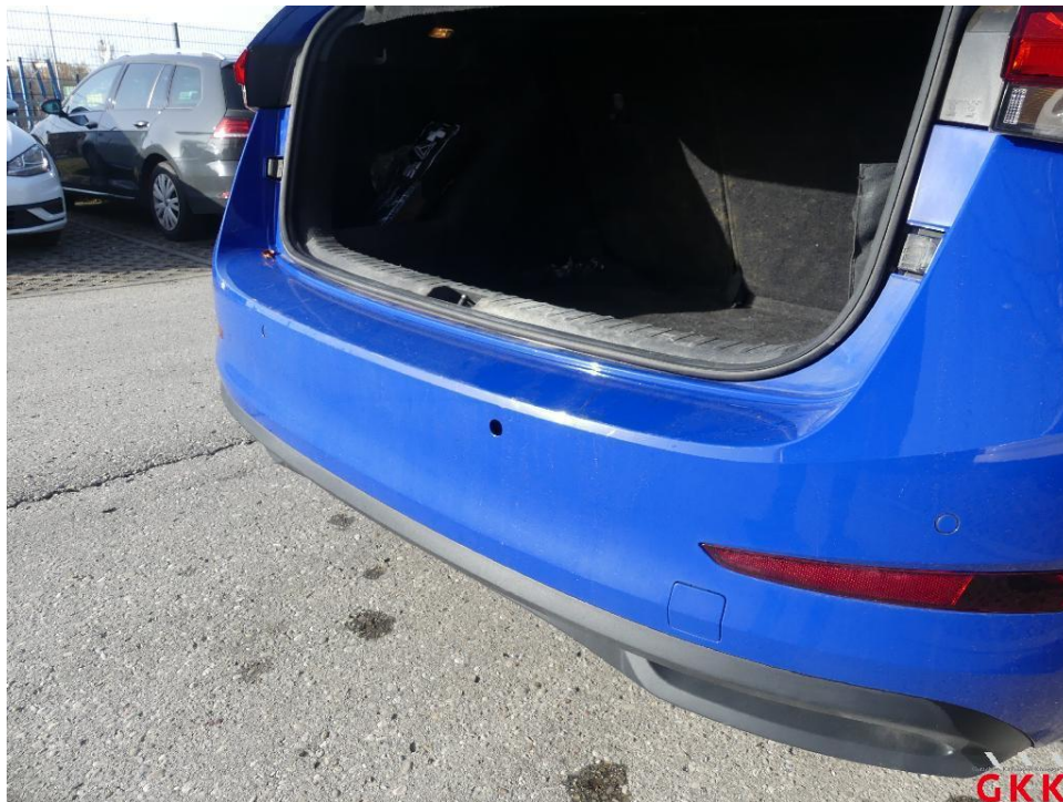
Bild 16 Stoßfänger hinten, Verkleidung -lackiert-, beschädigt, ersetzen
