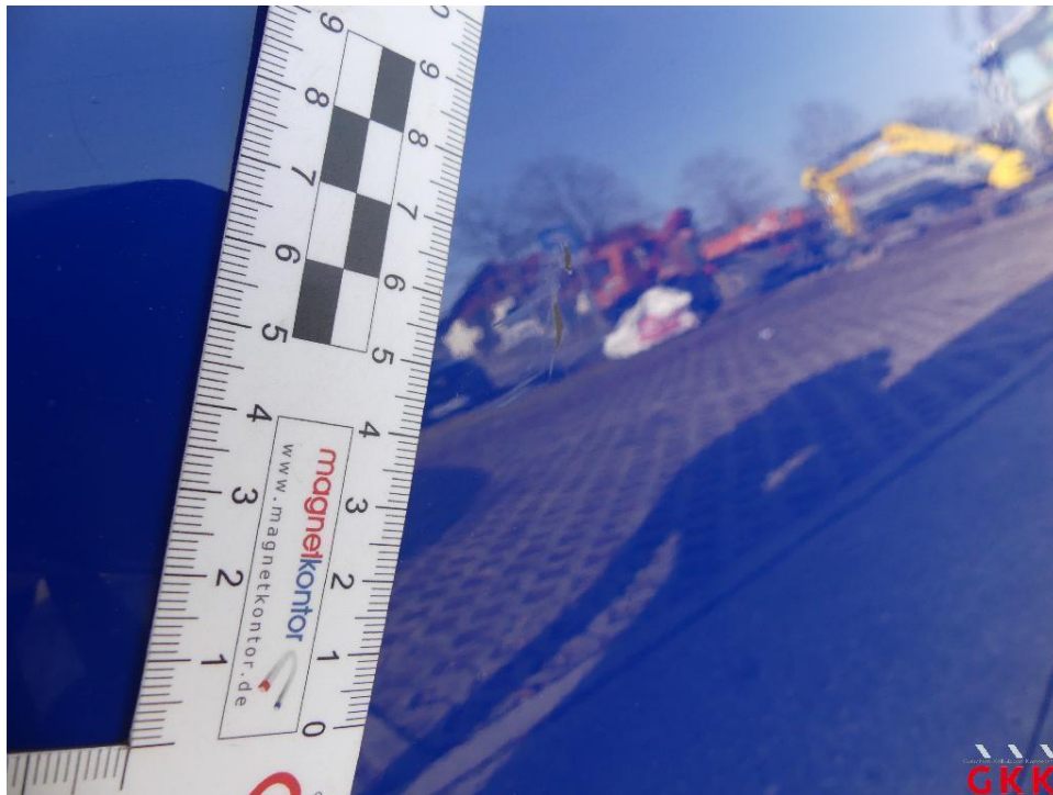
Bild 27 Tür hinten rechts, verkratzt, lackieren
