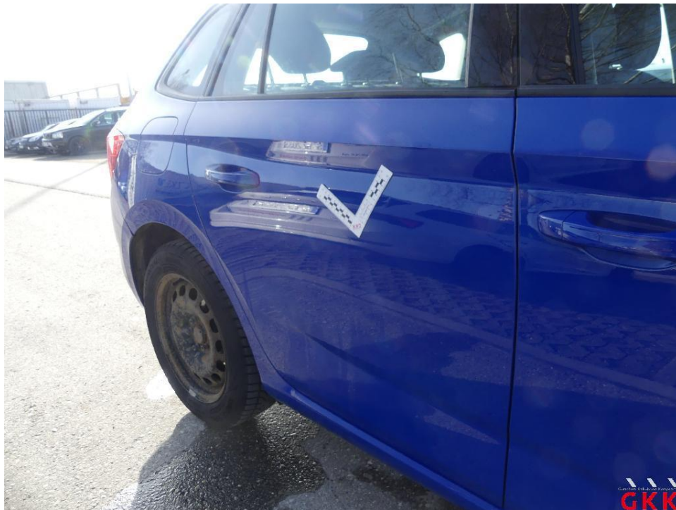
Bild 26 Tür hinten rechts, verkratzt, lackieren
