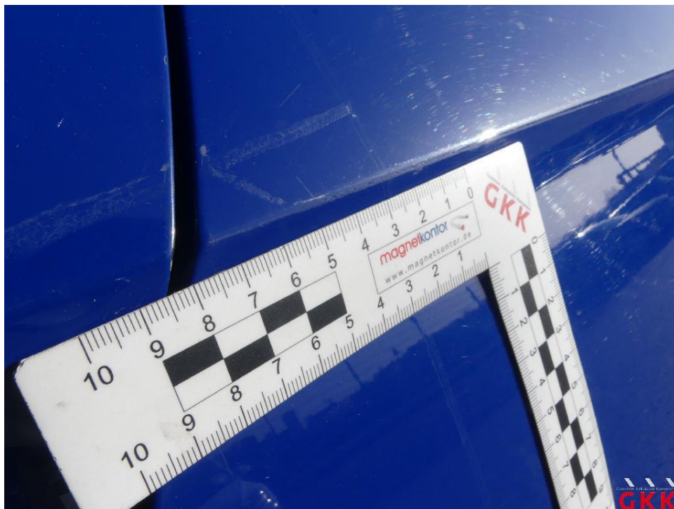
Bild 23 Seitenwand links, verkratzt, lackieren
