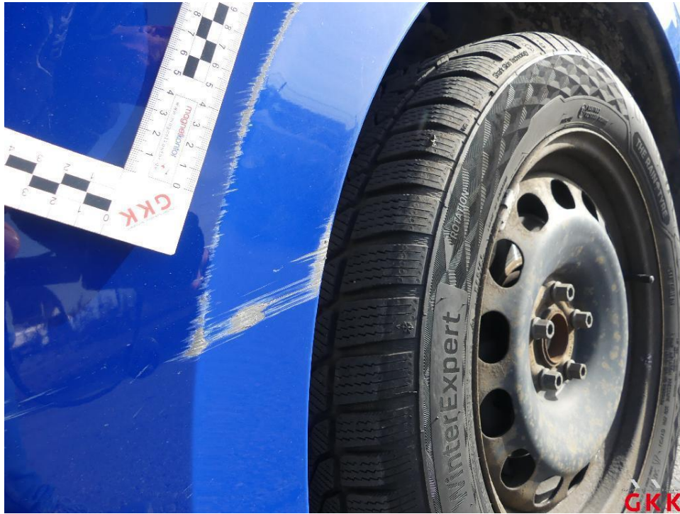
Bild 25 Stoßfänger vorne, Verkleidung -lackiert-, beschädigt, ersetzen
