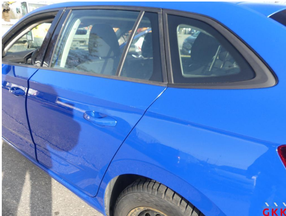
Bild 22 Seitenwand links, verkratzt, lackieren
