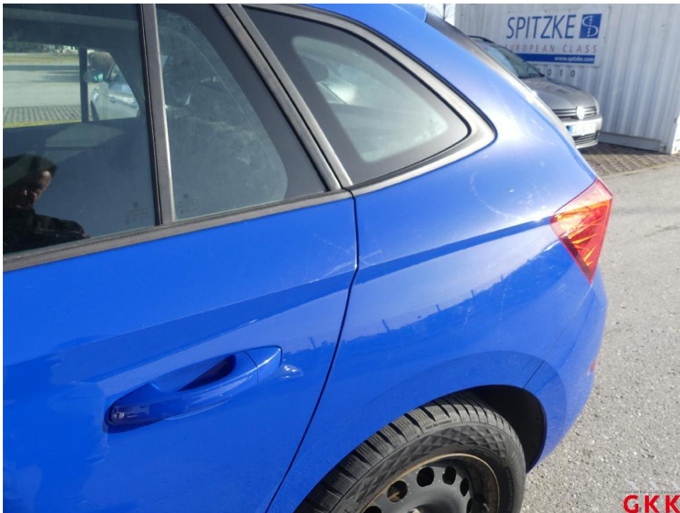
Bild 20 Tür hinten links, verkratzt, lackieren
