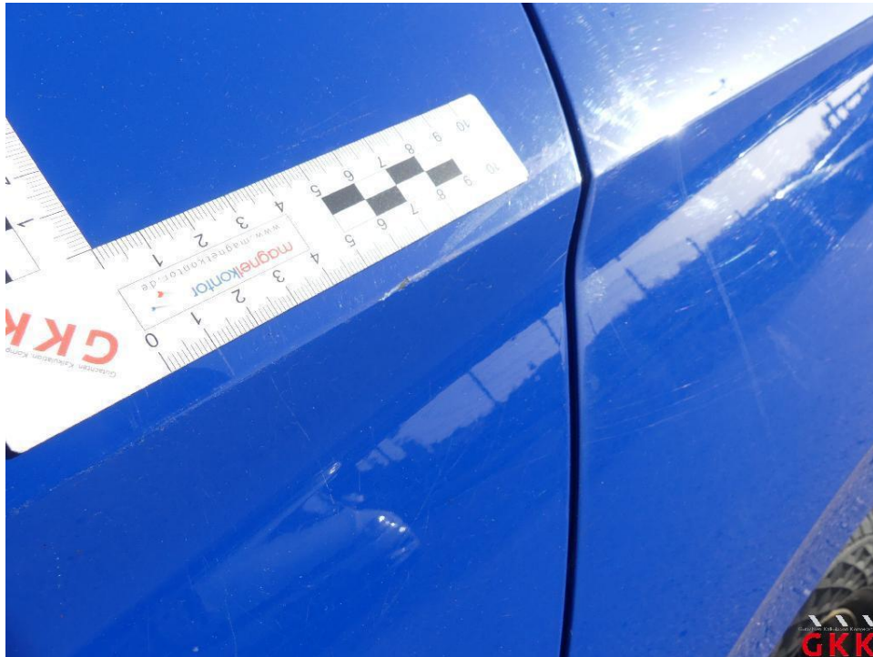
Bild 21 Tür hinten links, verkratzt, lackieren
