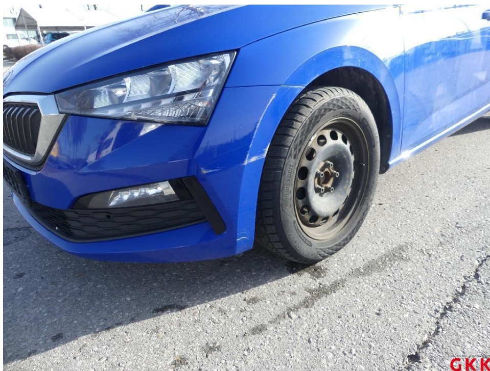
Bild 24 Stoßfänger vorne, Verkleidung -lackiert-, beschädigt, ersetzen
