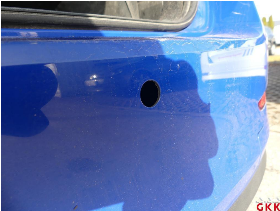
Bild 19 Stoßfänger hinten, PDC-Sensor, lose, ersetzen
