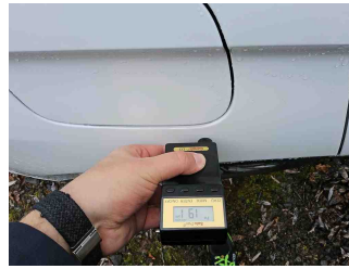
Lackstärke Seitenwand hinten rechts
