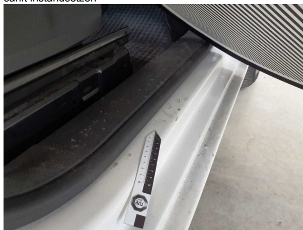
Beschädigung #4: Schweller rechts: Einstieg - Delle(n) - sanft instandsetzen
