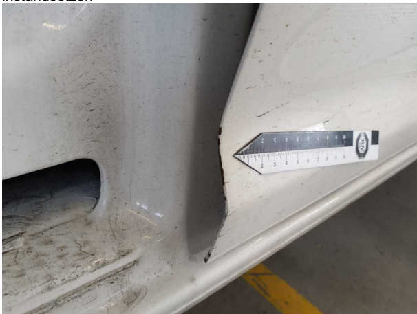
Beschädigung #5: Tür vorn rechts: Türkante - Kratzer - lackieren
