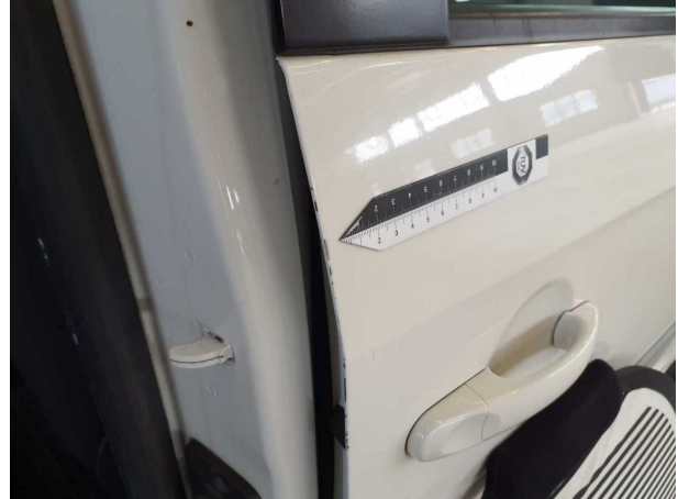
Beschädigung #5: Tür vorn rechts: Türkante - Kratzer - lackieren
