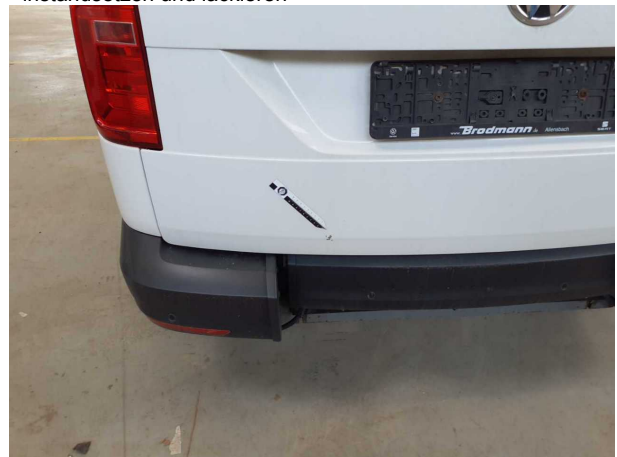
Beschädigung #8: Heckklappe/-tür: Heckklappe - Lackmangel - lackieren
