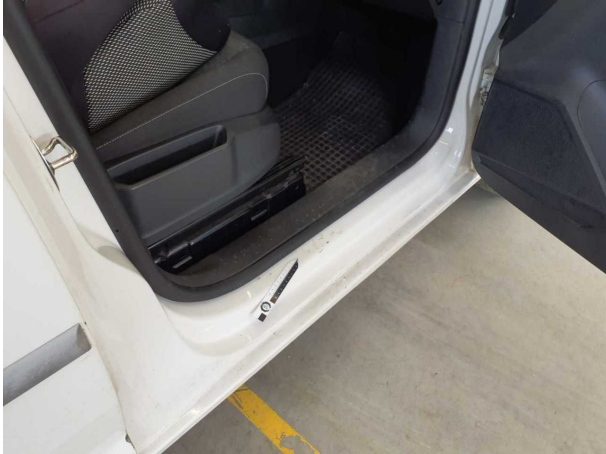
Beschädigung #4: Schweller rechts: Einstieg - Delle(n) - sanft instandsetzen
