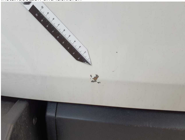
Beschädigung #8: Heckklappe/-tür: Heckklappe - Lackmangel - lackieren
