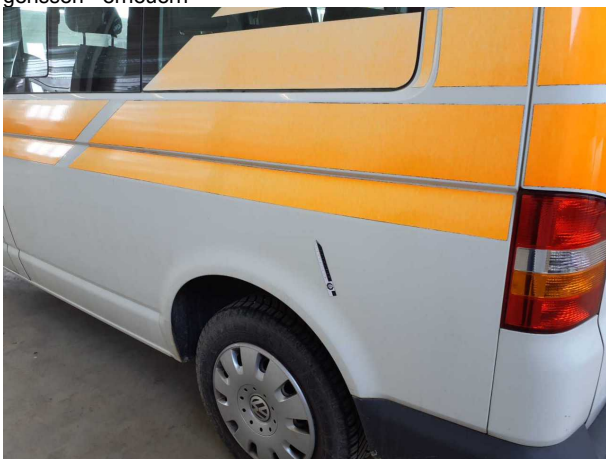
Beschädigung #21: Seitenwand links: Seitenwand - Delle(n) - instandsetzen und lackieren
