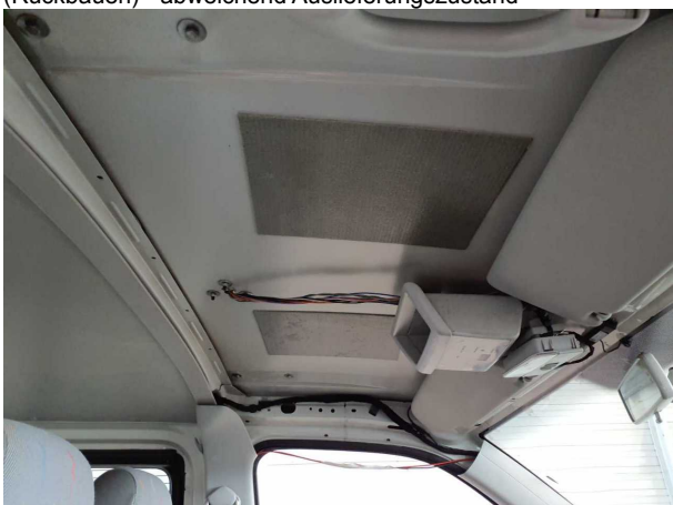
Beschädigung #10: Verkleidungen/Abdeckungen: Dachhimmel - fehlt - erneuern
