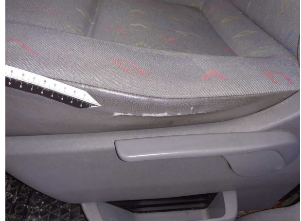
Beschädigung #23: Sitz vorn: Sitzbezug links - gebrochen / gerissen - erneuern
