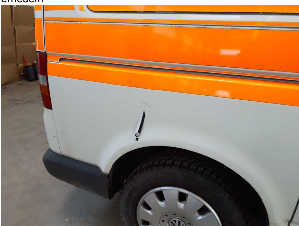
Beschädigung #16: Seitenwand rechts: Seitenwand - Kratze... lackieren
