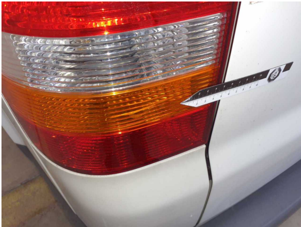
Beschädigung #20: Heckleuchte: Heckleuchte links - gebrochen / gerissen - erneuern
