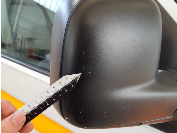
Beschädigung #7: Außenspiegel rechts: Abdeckkappe - Steinschlag - kein Abzug
