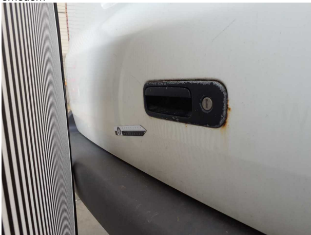
Beschädigung #17: Heckklappe/-tür: Heckklappe - Korrosion - erneuern
