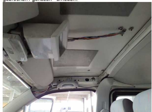
Beschädigung #10: Verkleidungen/Abdeckungen: Dachhim... - fehlt - erneuern
