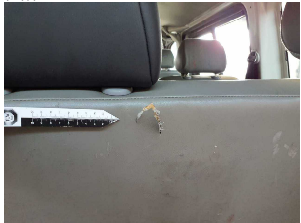
Beschädigung #18: Sitz hinten: Rücksitz - gebrochen / gerissen - erneuern
