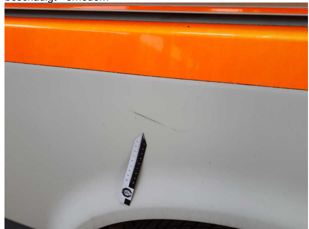
Beschädigung #16: Seitenwand rechts: Seitenwand - Kratze... lackieren
