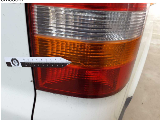
Beschädigung #19: Heckleuchte: Heckleuchte rechts - gebrochen / gerissen - erneuern
