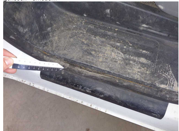
Beschädigung #24: Tür vorn links: Türdichtung - gebrochen / gerissen - erneuern
