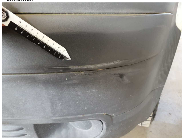
Beschädigung #4: Stossfänger vorn: Stossfänger vorn - Kratzer - erneuern
