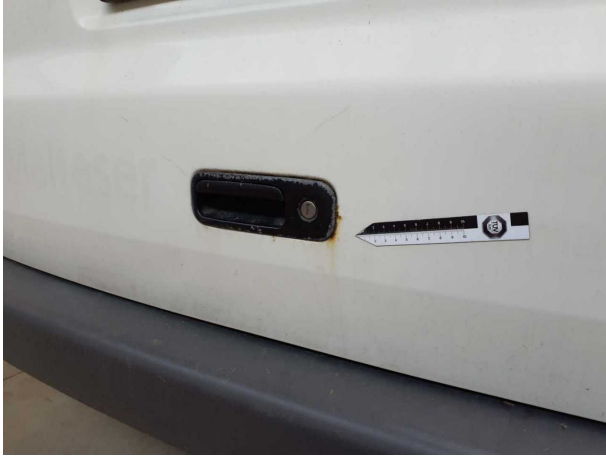
Beschädigung #17: Heckklappe/-tür: Heckklappe - Korrosion - erneuern
