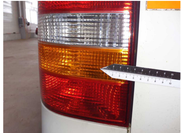
Beschädigung #20: Heckleuchte: Heckleuchte links - gebrochen / gerissen - erneuern
