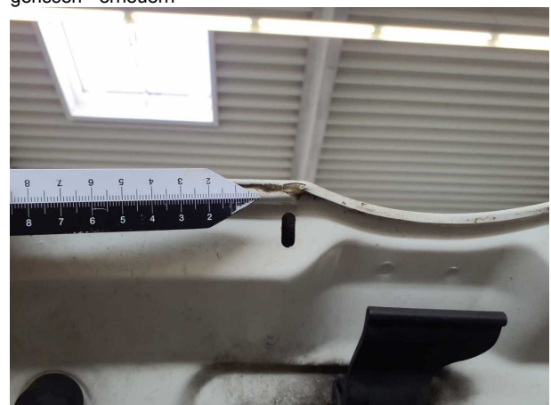
Beschädigung #26: Motorhaube: Motorhaube - Steinschlag - lackieren
