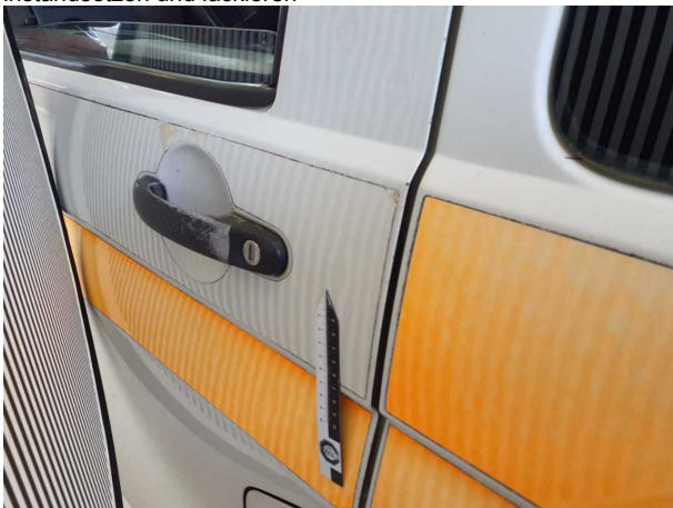
Beschädigung #22: Tür vorn links: Tür - Delle(n) - instandsetzen und lackieren
