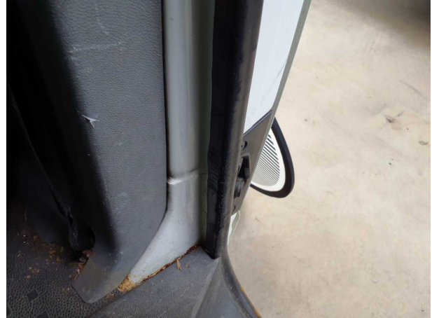
Beschädigung #14: Tür hinten rechts: Türdichtung - beschädigt - erneuern
