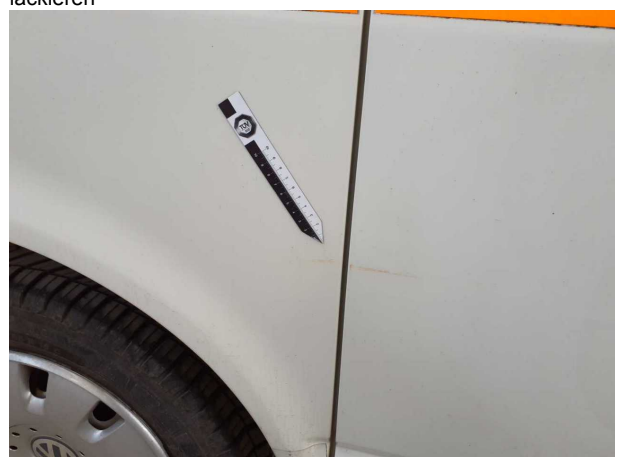
Beschädigung #16: Seitenwand rechts: Seitenwand - Kratze... lackieren
