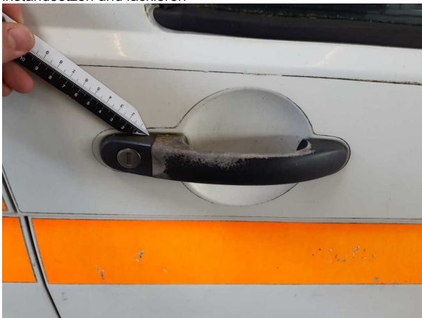
Beschädigung #15: Tür vorn rechts: Griff außen - Lackmangel - erneuern
