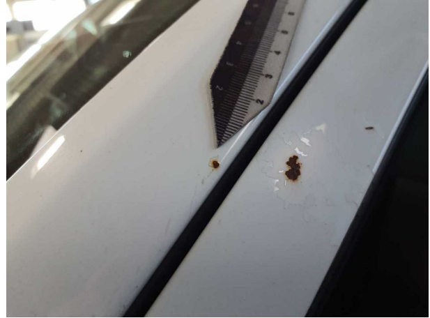
Beschädigung #12: Karosserie: A-Säule links - Steinschlag - auslegen / polieren
