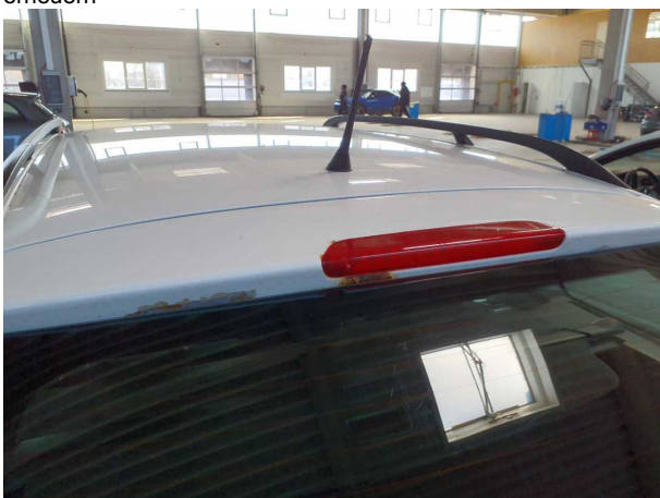
Beschädigung #8: Heckklappe/-tür: Heckklappe - Korrosion - erneuern
