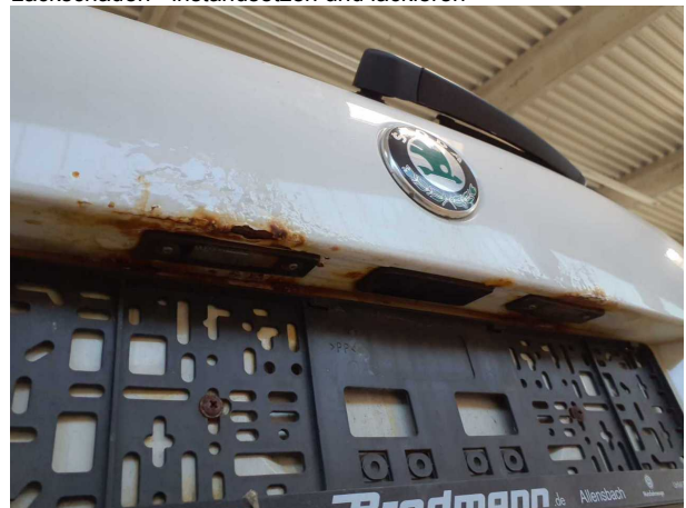
Beschädigung #8: Heckklappe/-tür: Heckklappe - Korrosion - erneuern
