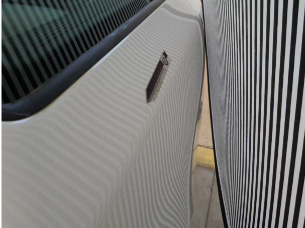
Beschädigung #21: Seitenwand links: Seitenwand (+ auslegen/polieren) - Delle / Lackschaden - sanft instandsetzen
