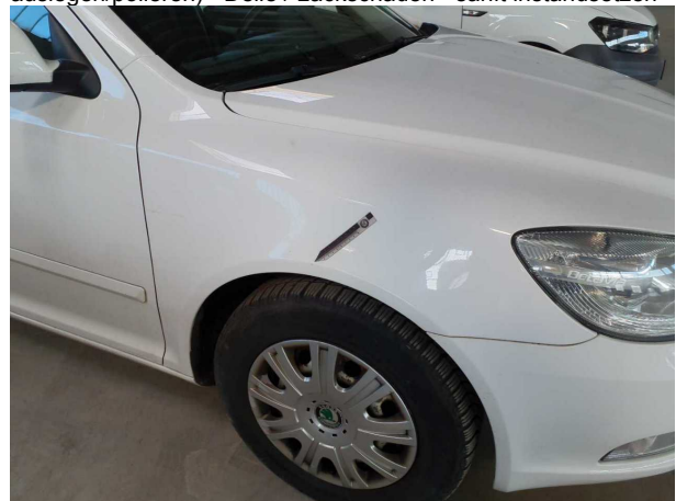
Beschädigung #22: Kotflügel rechts: Kotflügel rechts - Steinschlag - auslegen / polieren
