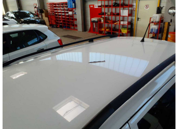
Beschädigung #6: Fahrzeugdach: Dach - Delle(n) - sanft instandsetzen
