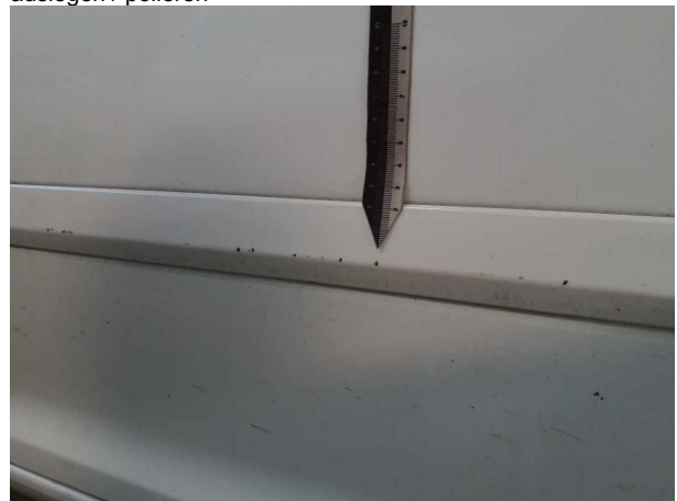
Beschädigung #13: Tür vorn rechts: Zierleiste Mitte - Kratzer - auslegen / polieren
