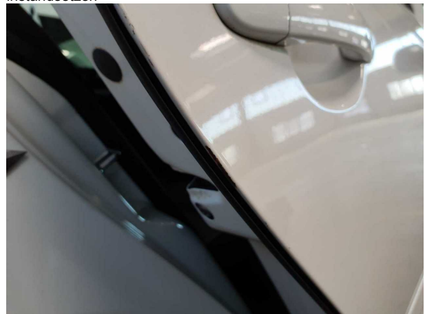
Beschädigung #18: Tür hinten rechts: Türkante - verkratzt / verschürft - auslegen / polieren
