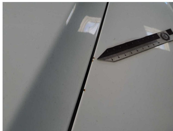
Beschädigung #23: Kotflügel links: Kotflügel links - Steinschlag - auslegen / polieren
