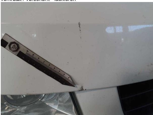
Beschädigung #20: Stossfänger vorn: Stossfänger vorn - verkratzt / verschürft - lackieren
