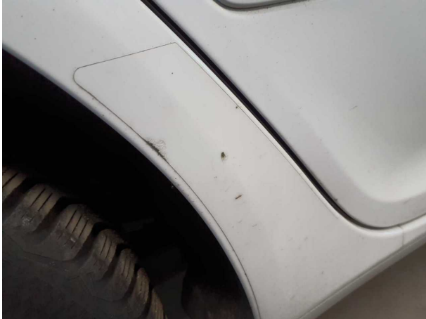
Beschädigung #19: Seitenwand rechts: Seitenwand - Kratzer - auslegen / polieren
