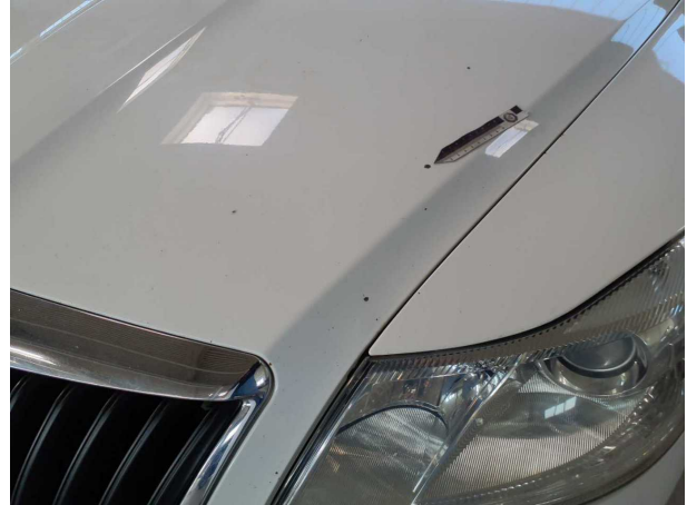
Beschädigung #7: Motorhaube: Motorhaube - Delle / Lackschaden - instandsetzen und lackieren
