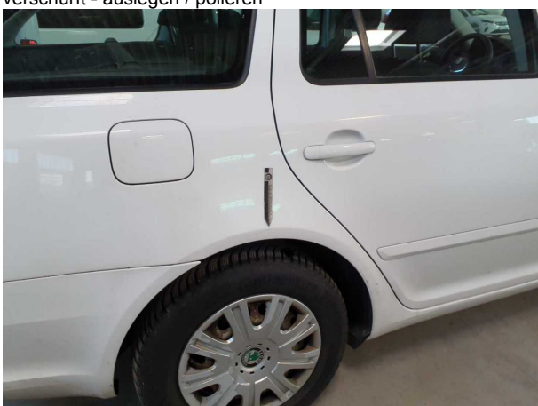
Beschädigung #19: Seitenwand rechts: Seitenwand - Kratzer - auslegen / polieren
