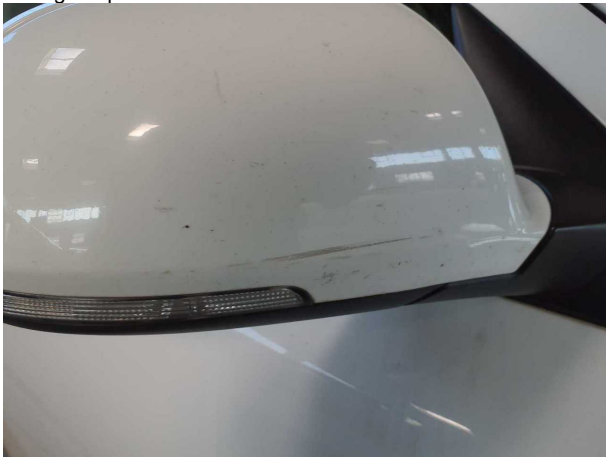
Beschädigung #15: Außenspiegel rechts: Abdeckkappe - verkratzt / verschürft - Smart Repair
