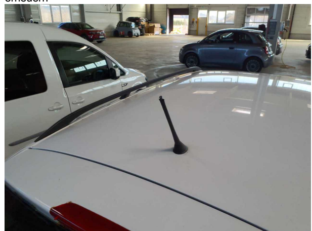
Beschädigung #5: Fahrzeugdach: Antennenstab - gebroche... gerissen - erneuern
