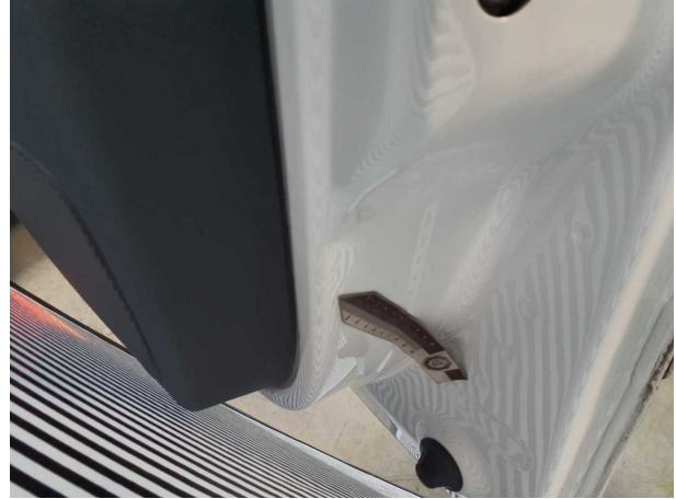
Beschädigung #17: Tür vorn rechts: Tür - Delle(n) - sanft instandsetzen
