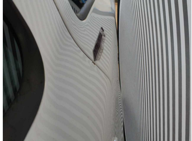
Beschädigung #10: Tür hinten links: Tür - Delle / Lackschad... - instandsetzen und lackieren
