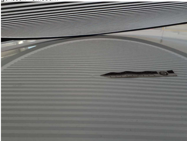
Beschädigung #6: Fahrzeugdach: Dach - Delle(n) - sanft instandsetzen
