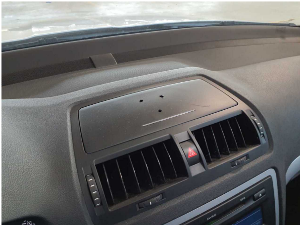
Beschädigung #1: Instrumententafel: Mittelkonsole vorn (Klappe... Löcher - erneuern
