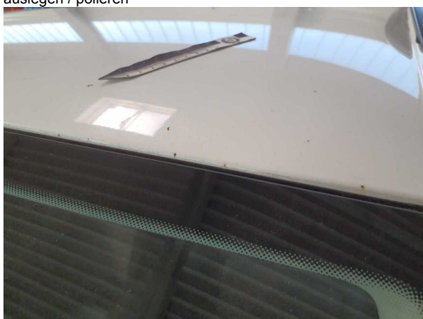
Beschädigung #24: Fahrzeugdach: Dach - Steinschlag - auslegen / polieren
