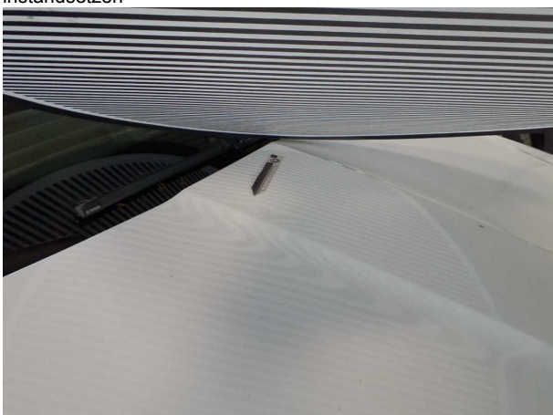
Beschädigung #7: Motorhaube: Motorhaube - Delle / Lackschad... - instandsetzen und lackieren
