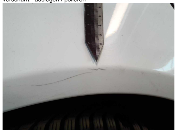
Beschädigung #19: Seitenwand rechts: Seitenwand - Kratze... auslegen / polieren
