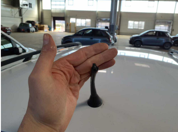
Beschädigung #5: Fahrzeugdach: Antennenstab - gebrochen / gerissen - erneuern
