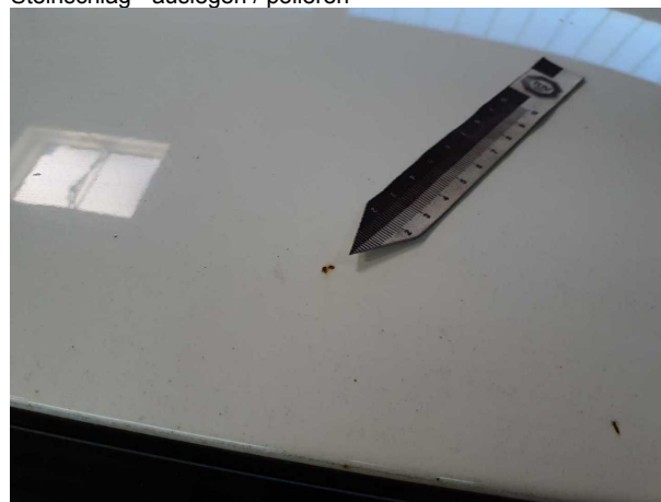
Beschädigung #24: Fahrzeugdach: Dach - Steinschlag - auslegen / polieren
