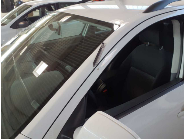
Beschädigung #12: Karosserie: A-Säule links - Steinschlag - auslegen / polieren
