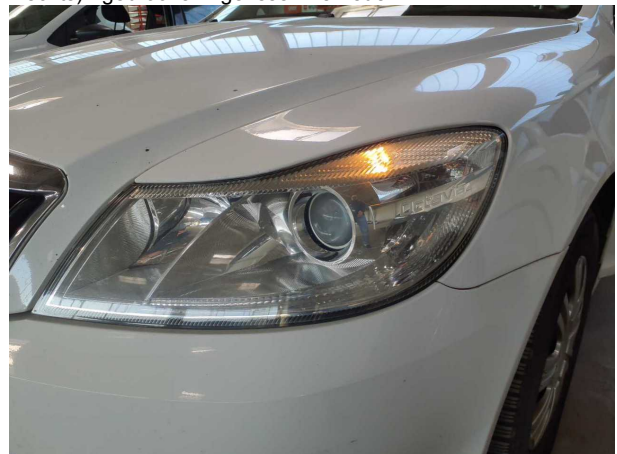
Beschädigung #3: Scheinwerfer: Leuchtmittel links - defekt - erneuern
