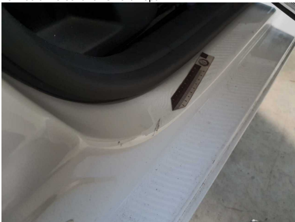
Beschädigung #16: Schweller rechts: Einstieg - Delle / Lackschaden - Smart Repair
