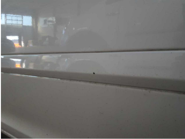
Beschädigung #14: Tür vorn links: Zierleiste Mitte - Kratzer - auslegen / polieren
