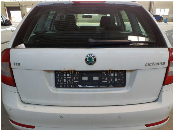
Beschädigung #8: Heckklappe/-tür: Heckklappe - Korrosion - erneuern
