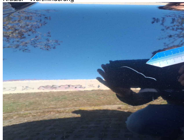
Beschädigung #14: Tür hinten rechts: Tür - Kratzer - Wertminderung
