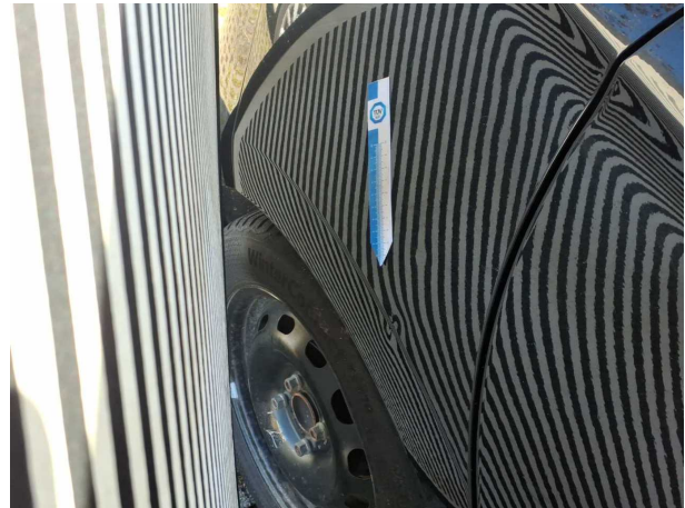
Beschädigung #7: Karosserie: Karosserie (Ca 300 Dellen) - Hagelschaden - Kostenvoranschlag erforderlich
