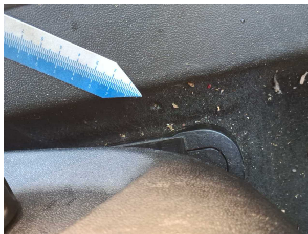
Beschädigung #5: Verkleidungen/Abdeckungen: Teppichboden - Brandloch - Wertminderung
