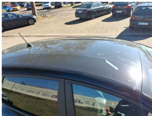
Beschädigung #7: Karosserie: Karosserie (Ca 300 Dellen) - Hagelschaden - Kostenvoranschlag erforderlich
