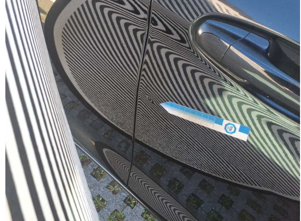
Beschädigung #10: Tür vorn rechts: Tür (Auslegen/Polieren) - Delle / Lackschaden - sanft instandsetzen
