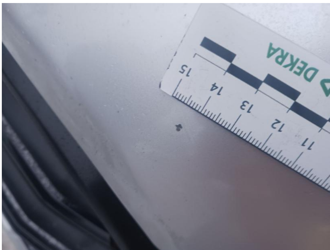
Fot. 32 Pokrywa komory silnika - Rysa/odprysk 1
