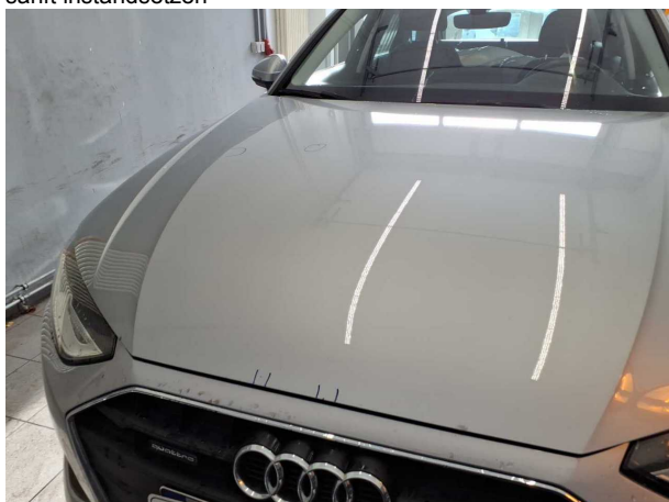
Beschädigung 2: Motorhaube: Motorhaube - Delle / Lackschaden - instandsetzen und lackieren
