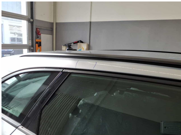
Beschädigung 1: Fahrzeugdach: Dachholm rechts - Delle(n) - sanft instandsetzen
