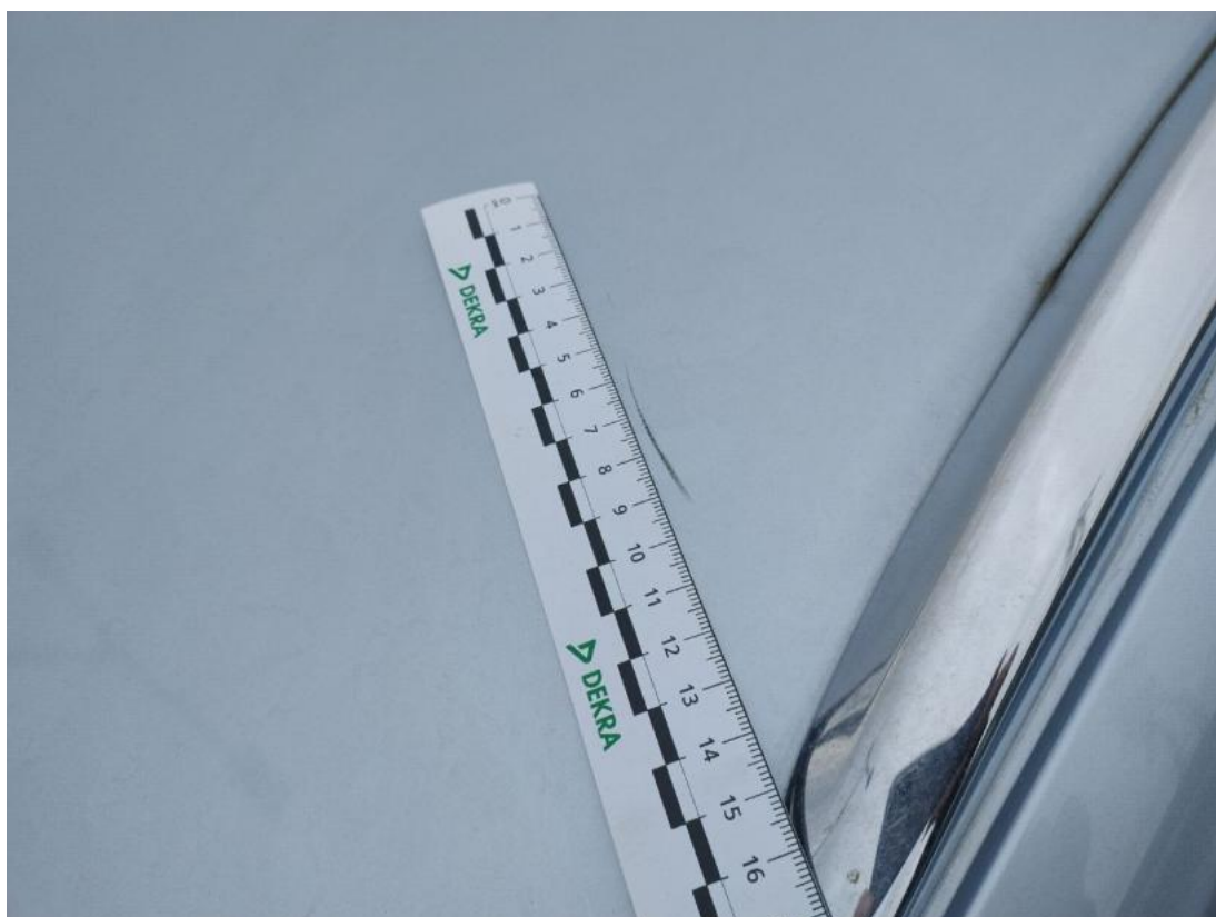
Fot. 40 Dach - Rysa/odprysk 1
