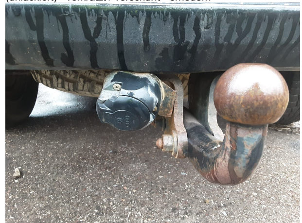
Beschädigung #15: Heckbereich: Anhängerdose - verformt - erneuern
