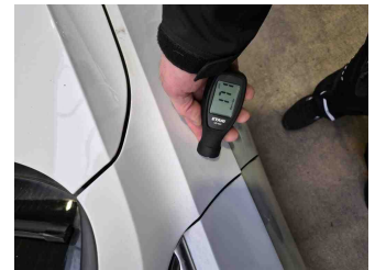
Lackstärke Kotflügel vorne rechts
