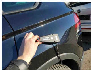
Lackstärke Seitenwand hinten links
