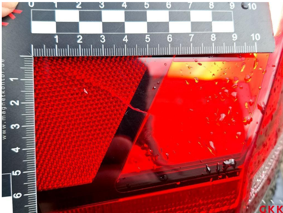
Bild 30 Rückleuchte links, außen, beschädigt, ersetzen
