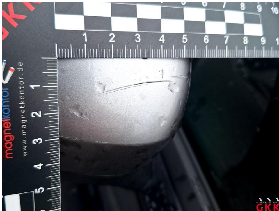
Bild 22 Spiegelgehäuse rechts, Kappe -lackiert-, verkratzt, lackieren
