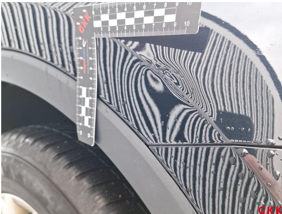
Bild 20 Kotflügel vorne rechts, beschädigt, ersetzen
