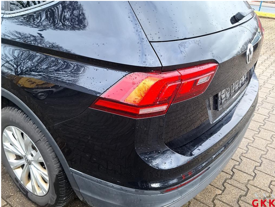
Bild 29 Rückleuchte links, außen, beschädigt, ersetzen
