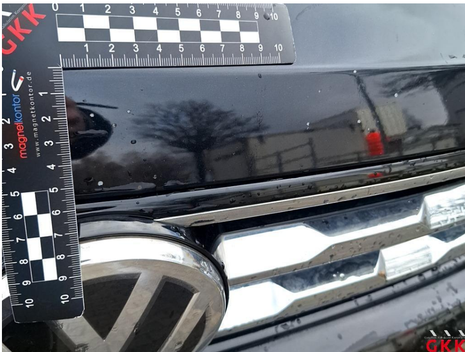
Bild 32 Motorhaube, Steinschlag, lackieren
