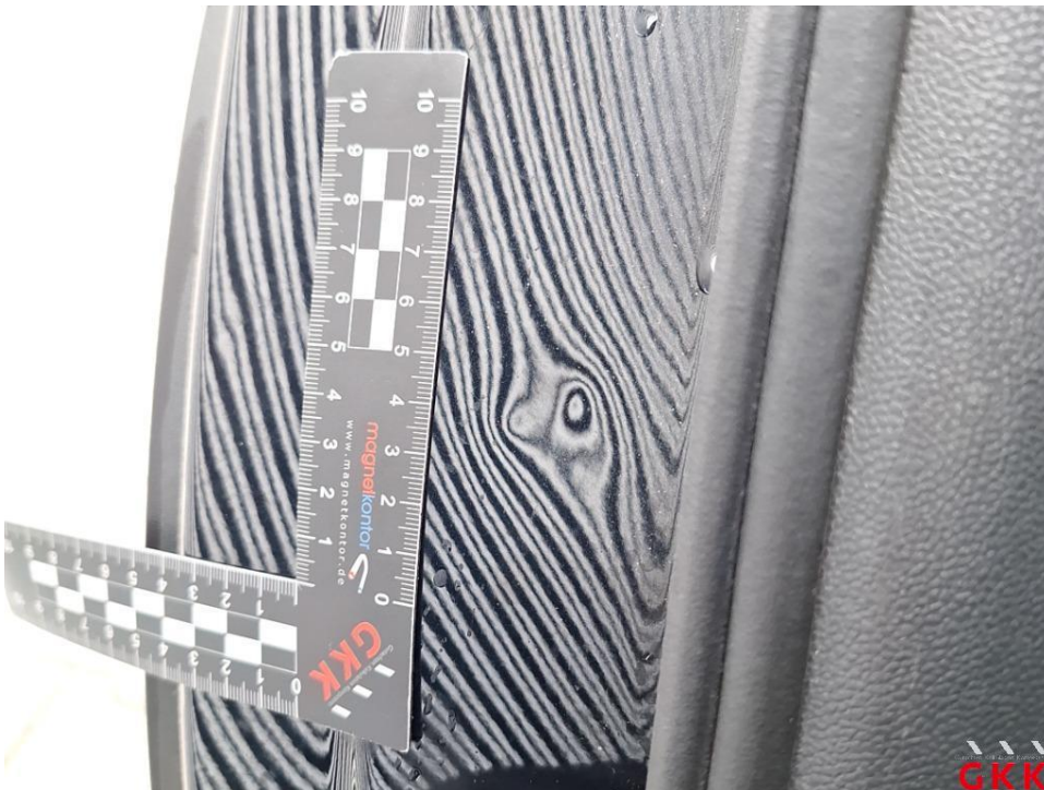
Bild 24 C- Säule rechts, innen, beschädigt, Smartrepair
