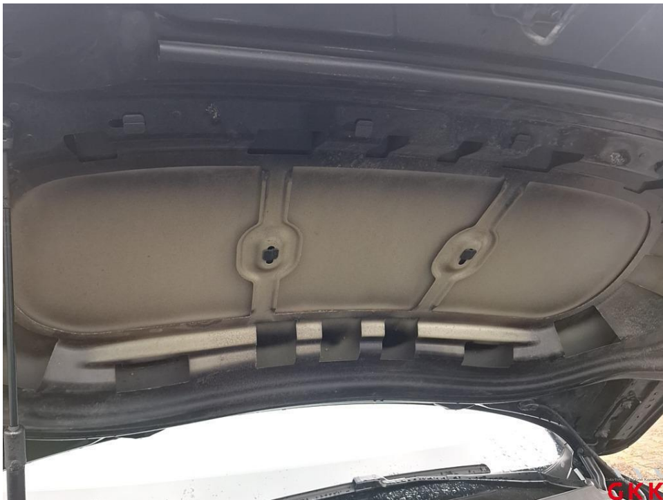
Bild 16 Motorhaube, Dämmmatte, fehlt, ersetzen
