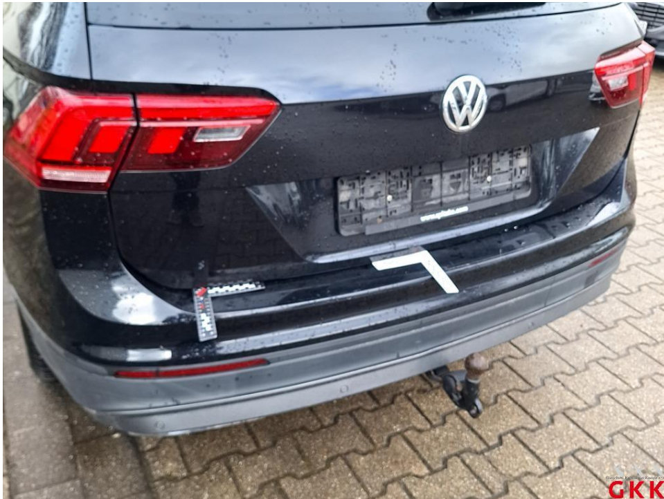
Bild 25 Stoßfänger hinten, Verkleidung -lackiert-, beschädigt, ersetzen
