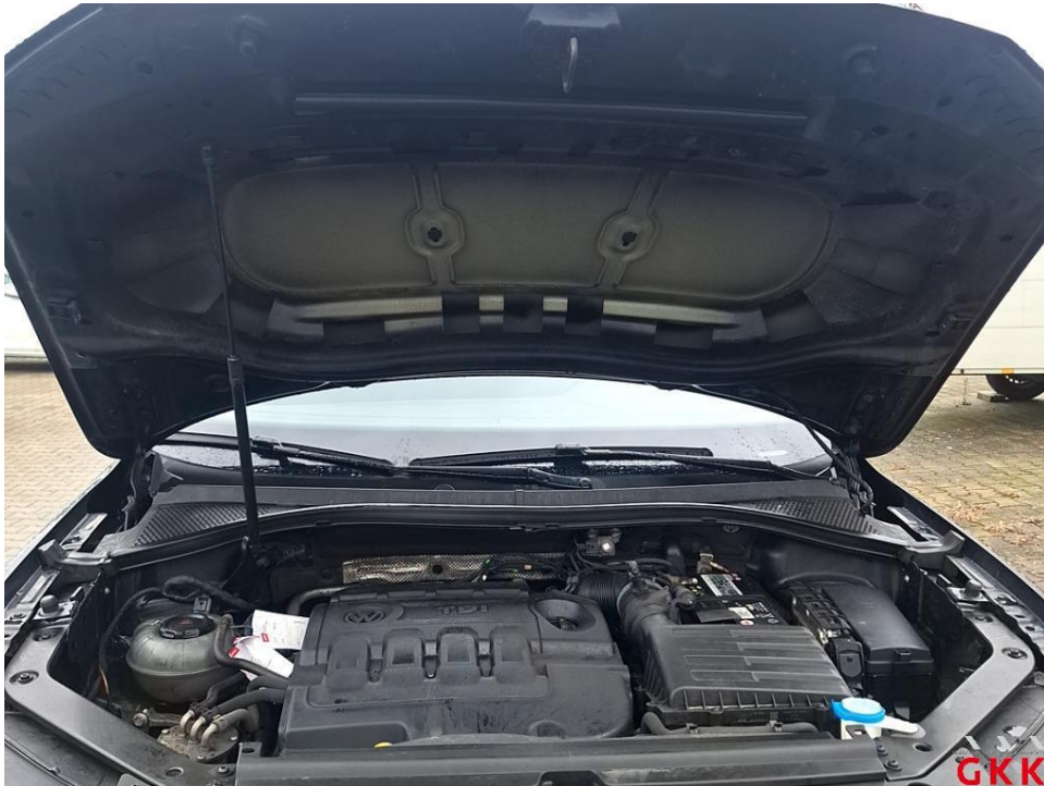
Bild 15 Motorhaube, Dämmmatte, fehlt, ersetzen
