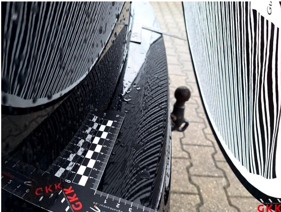
Bild 26 Stoßfänger hinten, Verkleidung -lackiert-, beschädigt, ersetzen
