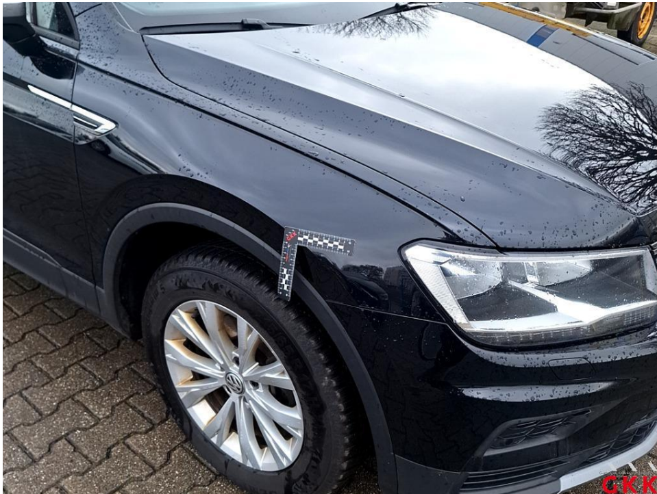
Bild 19 Kotflügel vorne rechts, beschädigt, ersetzen
