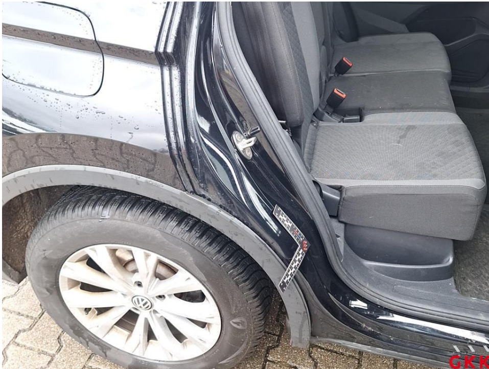
Bild 23 C- Säule rechts, innen, beschädigt, Smartrepair
