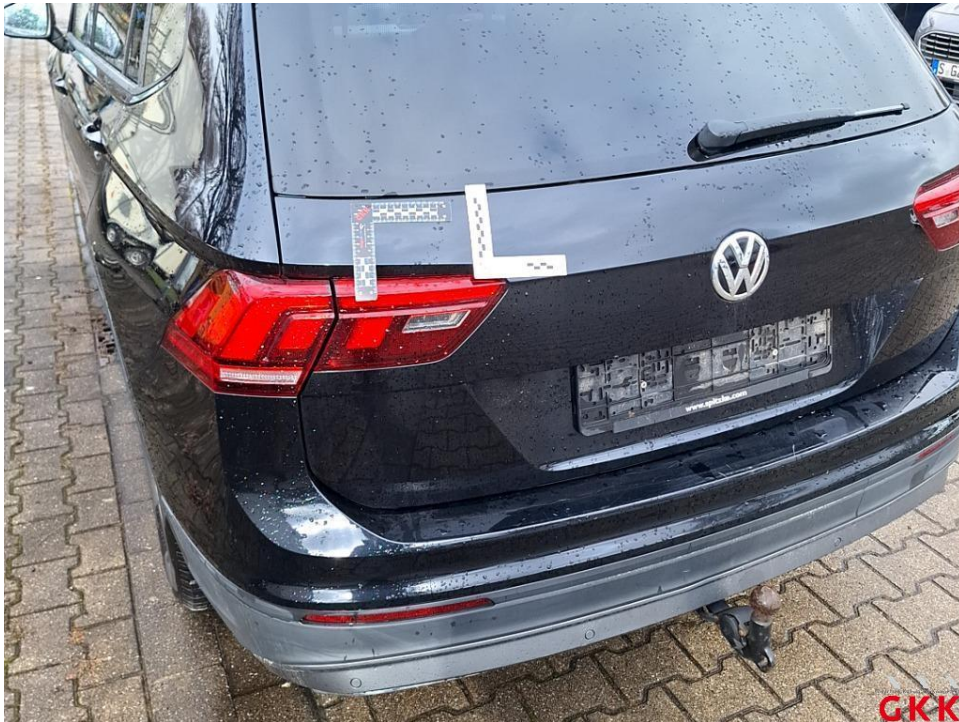
Bild 27 Heckklappe, beschädigt, instand setzen - lackieren
