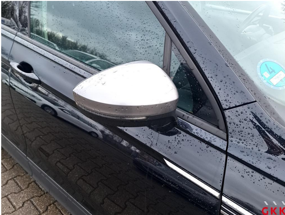
Bild 21 Spiegelgehäuse rechts, Kappe -lackiert-, verkratzt, lackieren
