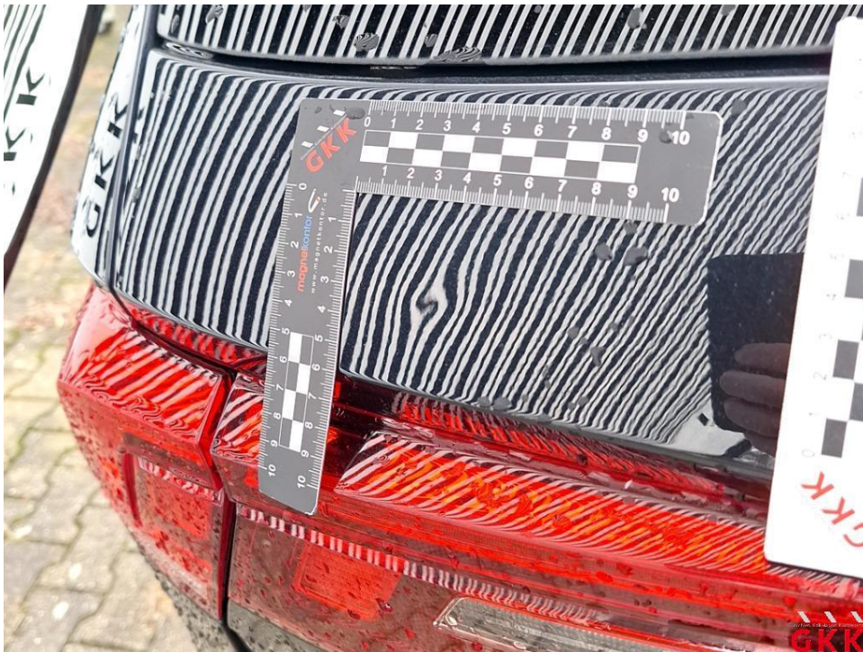
Bild 28 Heckklappe, beschädigt, instand setzen - lackieren
