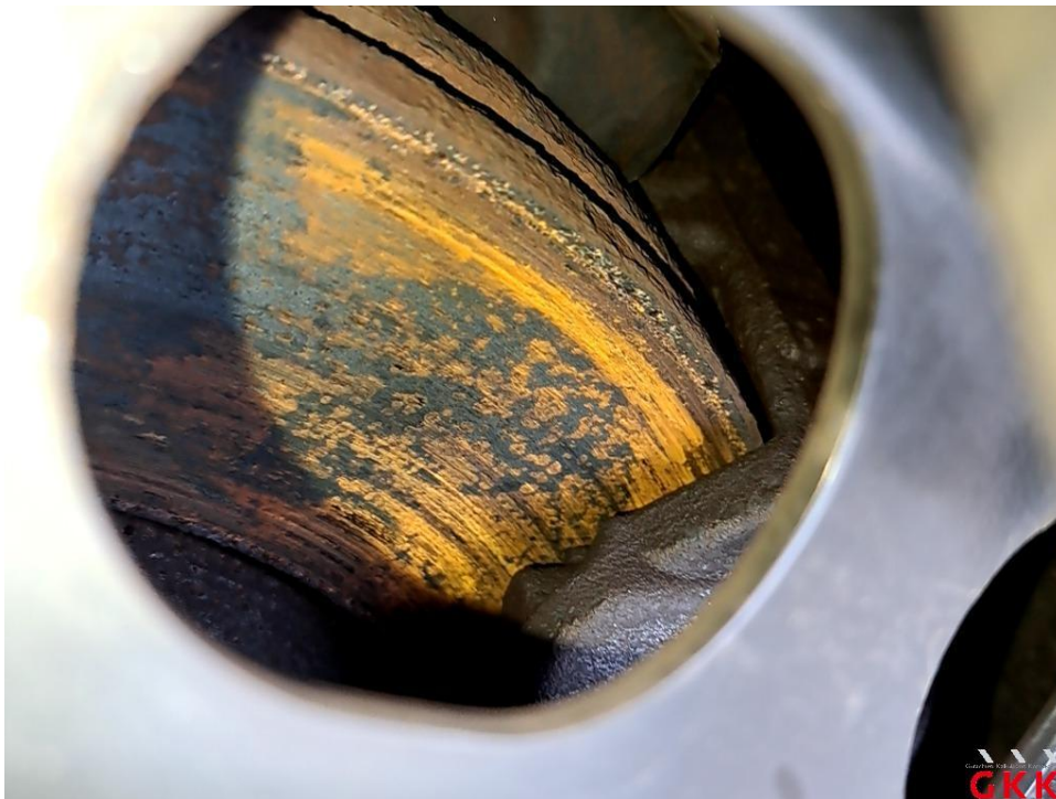
Bild 24 Bremsscheiben, vorne, korrodiert, ersetzen
