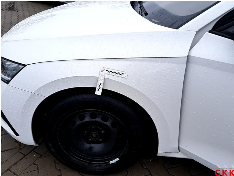
Bild 25 Kotflügel vorne links, beschädigt, instand setzen - lackieren
