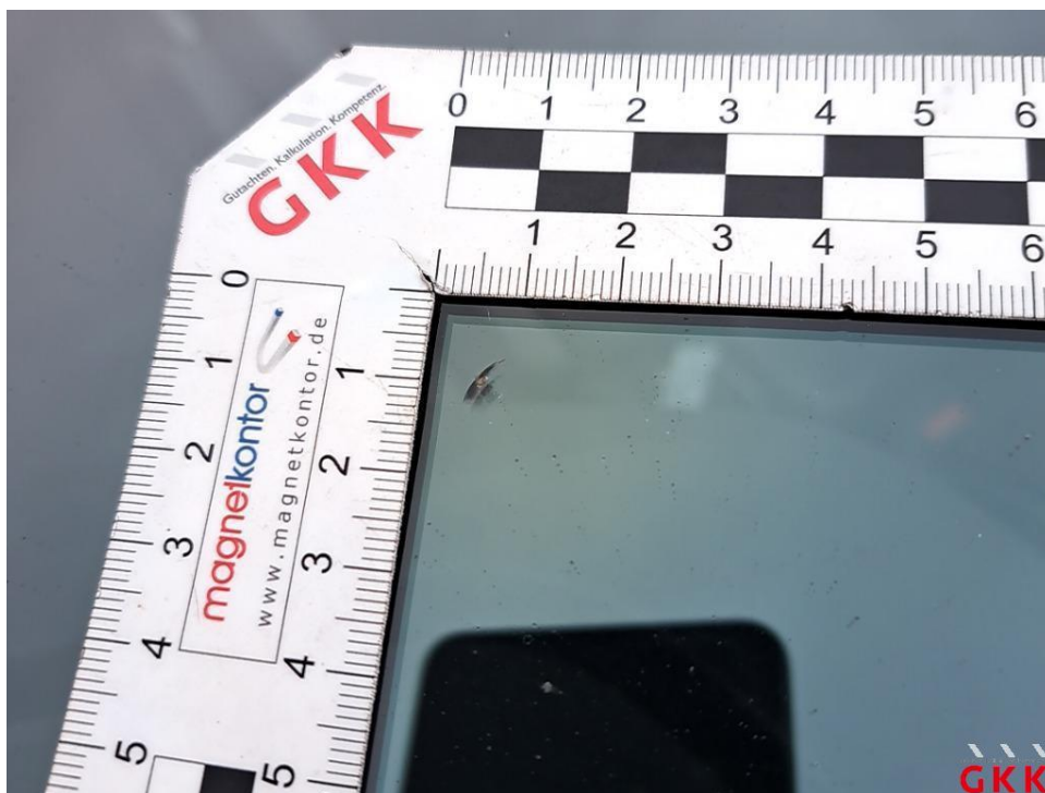
Bild 28 Frontscheibe, mit Regensensor und Frontkamera, Steinschlag im Sichtfeld, ersetzen
