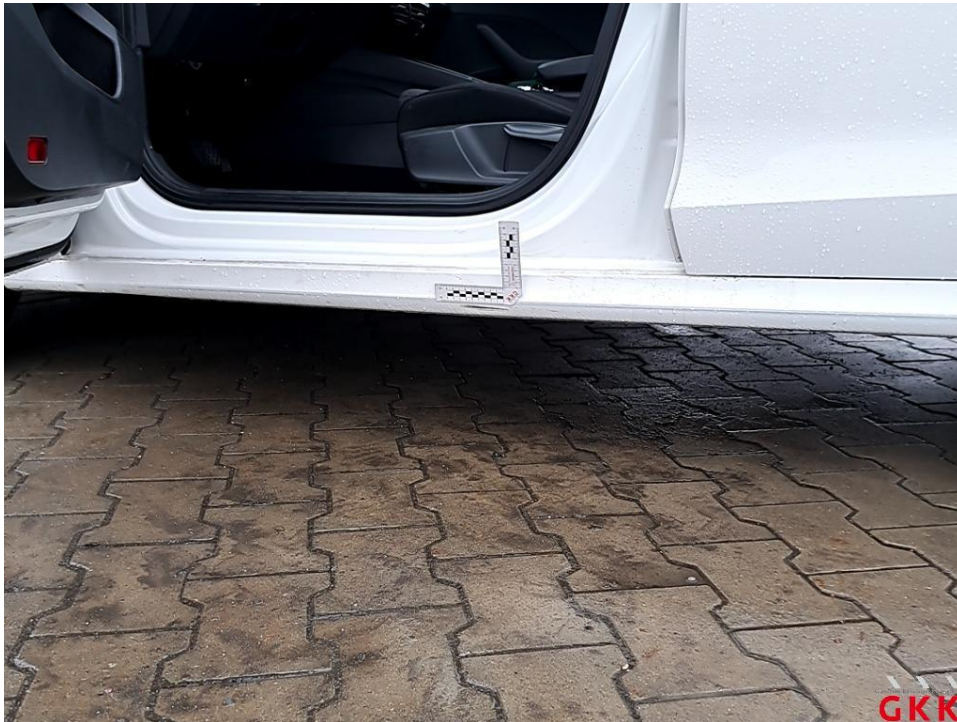
Bild 19 Schweller links, verkratzt, lackieren
