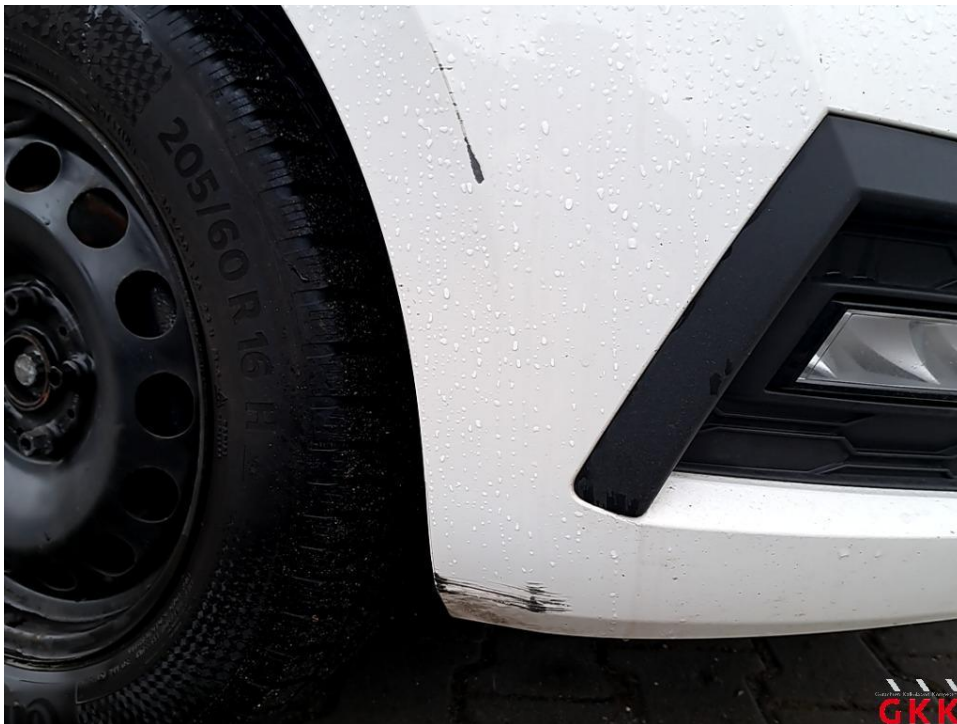
Bild 16 Stoßfänger vorne, Verkleidung -lackiert-, verkratzt, lackieren
