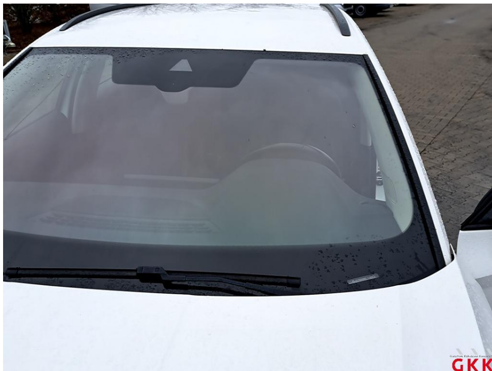
Bild 27 Frontscheibe, mit Regensensor und Frontkamera, Steinschlag im Sichtfeld, ersetzen
