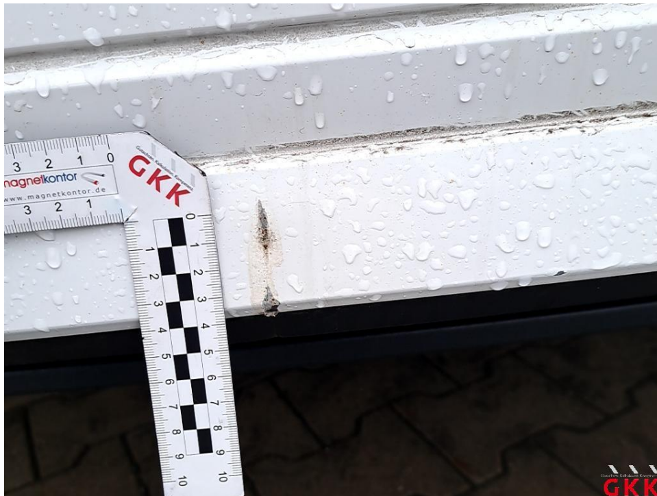
Bild 22 Stoßfänger hinten, Verkleidung -lackiert-, beschädigt, ersetzen
