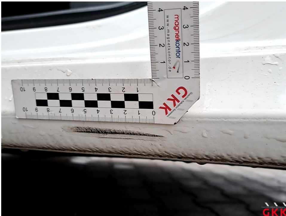
Bild 20 Schweller links, verkratzt, lackieren
