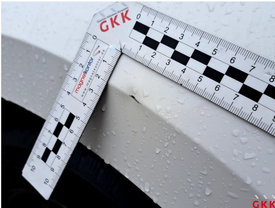
Bild 26 Kotflügel vorne links, beschädigt, instand setzen - lackieren
