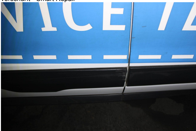
Beschädigung #8: Tür hinten rechts: Tür (Türstoßleiste) - verkratzt / verschürft - erneuern
