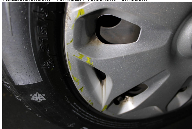
Beschädigung #1: Rad/Reifen: Radblende vorn rechts (alle Radzierblenden) - verkratzt / verschürft - erneuern
