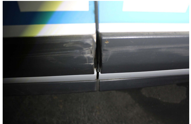
Beschädigung #9: Tür vorn rechts: Tür (Türstoßleiste) - verkratzt / verschürft - erneuern
