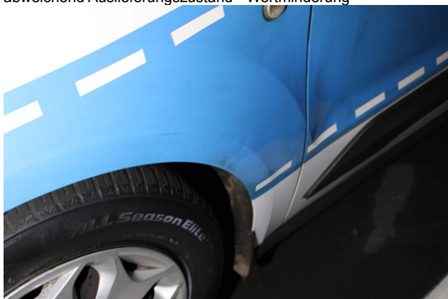
Beschädigung #5: Kotflügel links: Kotflügel links - verformt - instandsetzen und lackieren
