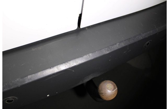
Beschädigung #6: Stossfänger hinten: Stossfänger hinten (unlackiert) - verkratzt / verschürft - Wertminderung
