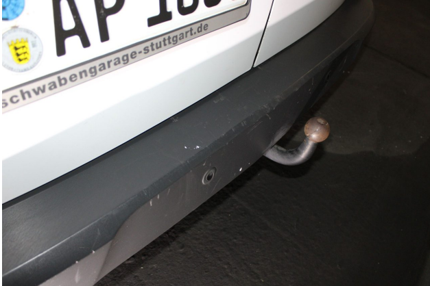
Beschädigung #6: Stossfänger hinten: Stossfänger hinten (unlackiert) - verkratzt / verschürft - Wertminderung
