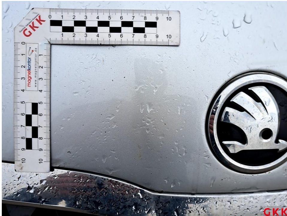
Bild 17 Motorhaube, Steinschlag, lackieren
