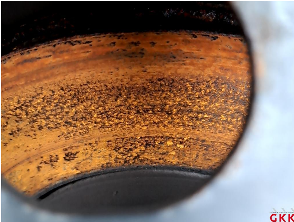
Bild 15 Vorderachse Bremsscheiben, komplett, korrodiert, ersetzen
