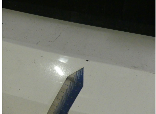
Beschädigung #9: Stossfänger hinten: Stossfänger hinten (Ladekante) - verkratzt / verschürft - Smart Repair
