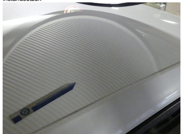
Beschädigung #6: Fahrzeugdach: Dach - Delle(n) - sanft instandsetzen
