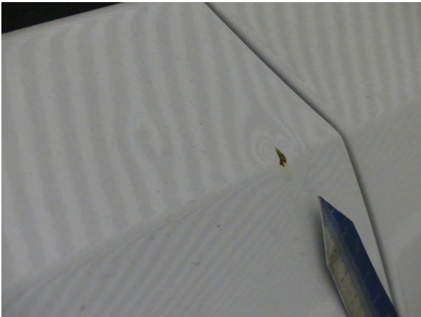
Beschädigung #1: Tür vorn links: Tür - Delle / Lackschaden - instandsetzen und lackieren
