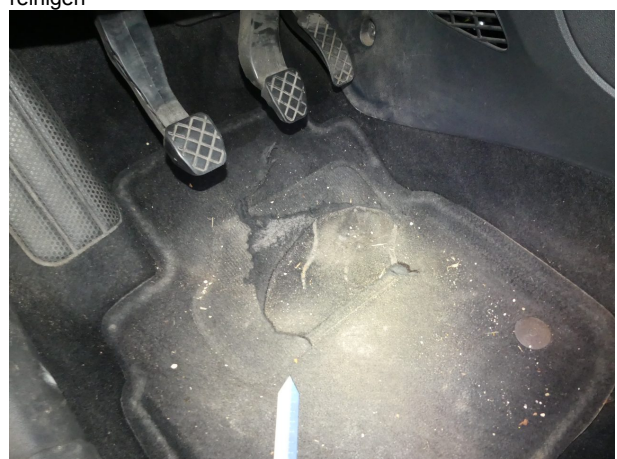
Beschädigung #3: Verkleidungen/Abdeckungen: Fußmatten (vorne links) - gebrochen / gerissen - erneuern
