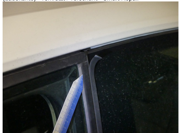
Beschädigung #10: Tür vorn links: Türdichtung - gebrochen / gerissen - erneuern
