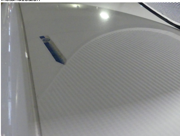
Beschädigung #6: Fahrzeugdach: Dach - Delle(n) - sanft instandsetzen
