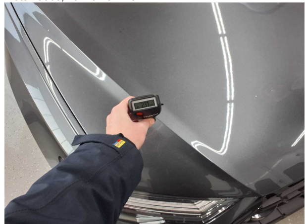
Nachlackierung 1: Kotflügel links, Kotflügel rechts, Motorhaube, Tür vorne links
