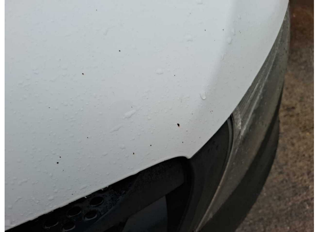
Beschädigung #11: Motorhaube: Motorhaube - Korrosion - instandsetzen und lackieren
