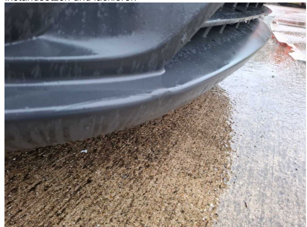
Beschädigung #12: Stossfänger vorn: Stossfänger vorn - verformt - erneuern
