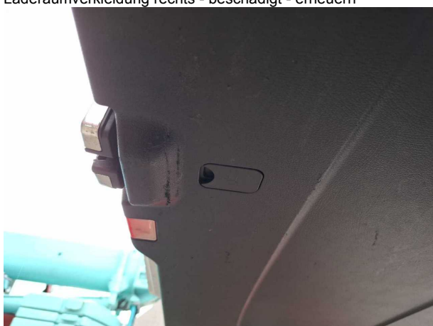
Beschädigung #7: Verkleidungen/Abdeckungen: Heckdeckel, Innenverkleidung - Kratzer - erneuern
