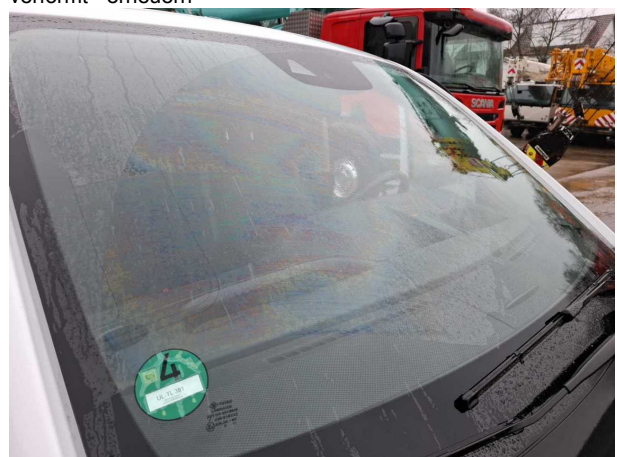
Beschädigung #13: Verglasung: Frontscheibe mit Spurhalteassistent - Steinschlag - erneuern
