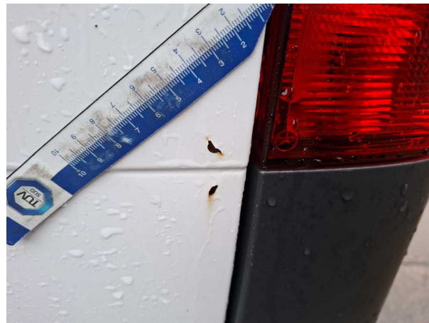
Beschädigung #8: Heckklappe/-tür: Heckklappe - Korrosion - instandsetzen und lackieren
