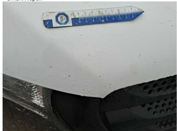
Beschädigung #11: Motorhaube: Motorhaube - Korrosion - instandsetzen und lackieren
