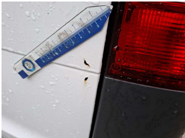
Beschädigung #8: Heckklappe/-tür: Heckklappe - Korrosion - instandsetzen und lackieren
