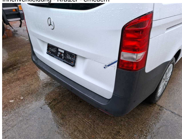
Beschädigung #8: Heckklappe/-tür: Heckklappe - Korrosion - instandsetzen und lackieren
