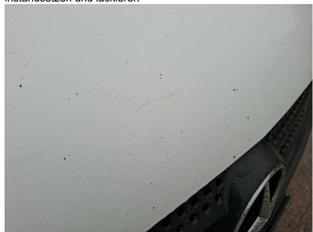
Beschädigung #11: Motorhaube: Motorhaube - Korrosion - instandsetzen und lackieren
