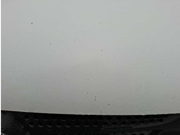
Beschädigung #11: Motorhaube: Motorhaube - Korrosion - instandsetzen und lackieren
