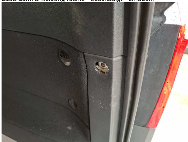
Beschädigung #6: Verkleidungen/Abdeckungen: Laderaumverkleidung rechts - beschädigt - erneuern
