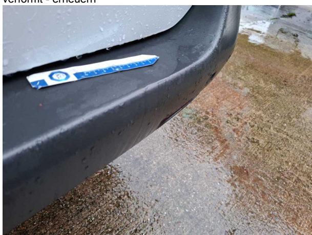
Beschädigung #9: Stossfänger hinten: Stossfänger hinten - verformt - erneuern
