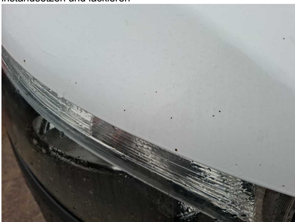
Beschädigung #11: Motorhaube: Motorhaube - Korrosion - instandsetzen und lackieren
