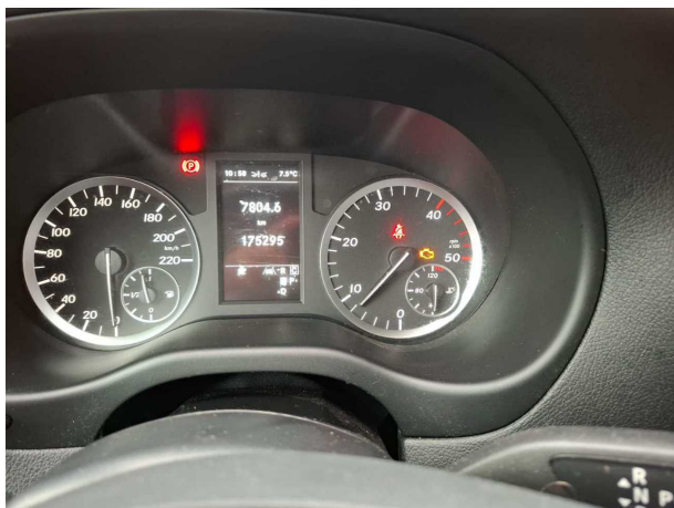
Beschädigung #1: Instrumententafel: Kontrollleuchte - leuchtet - Diagnose durchführen
