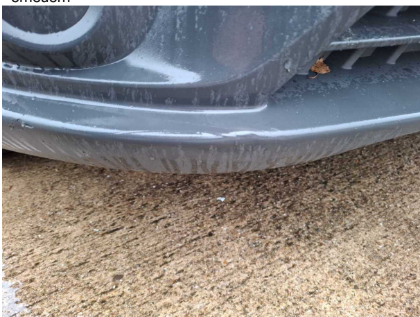
Beschädigung #12: Stossfänger vorn: Stossfänger vorn - verformt - erneuern
