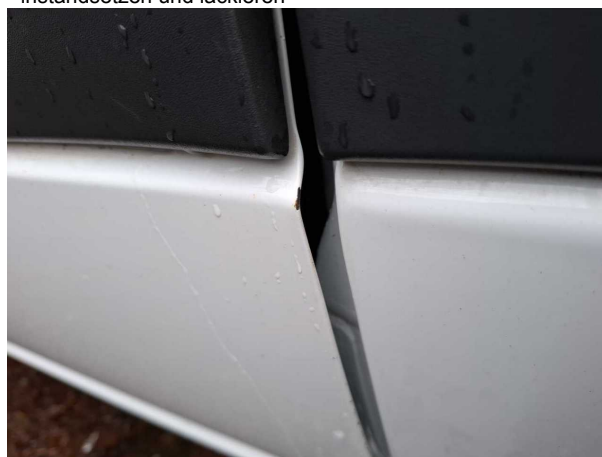
Beschädigung #12: Tür hinten rechts: Tür (Unterhalb) - Krat... - instandsetzen und lackieren
