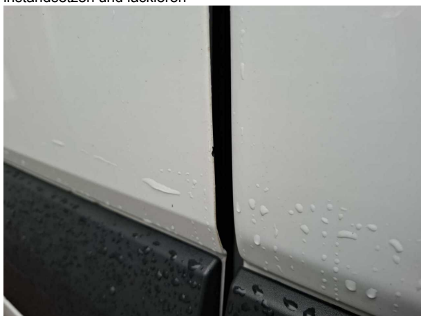
Beschädigung #12: Tür hinten rechts: Tür (Unterhalb) - Kratzer - instandsetzen und lackieren
