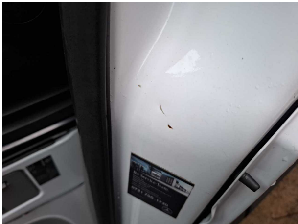
Beschädigung #9: Karosserie: B-Säule links - Delle / Lackschad... - Smart Repair
