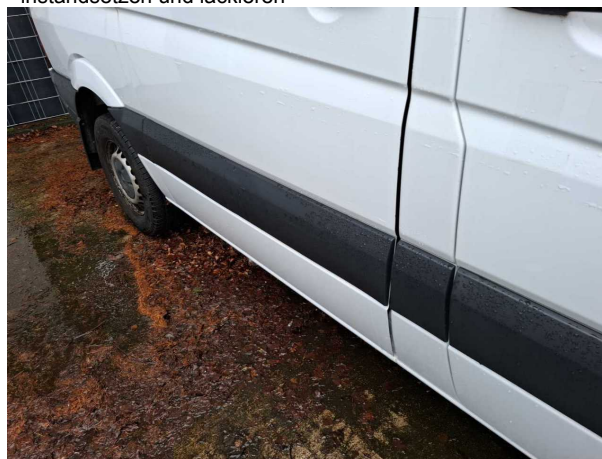
Beschädigung #12: Tür hinten rechts: Tür (Unterhalb) - Krat... - instandsetzen und lackieren
