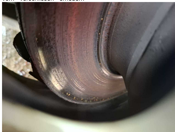
Beschädigung #2: Bremsanlage: Bremsscheiben und Beläge vorn - verschlissen - erneuern
