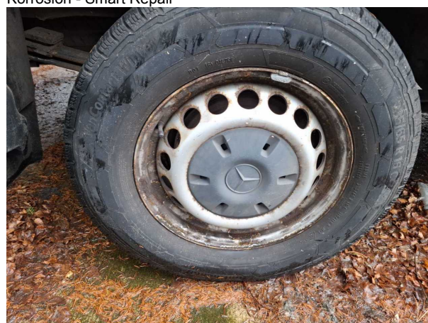
Beschädigung #6: Rad/Reifen: Felgensatz komplett - Korrosion - Smart Repair
