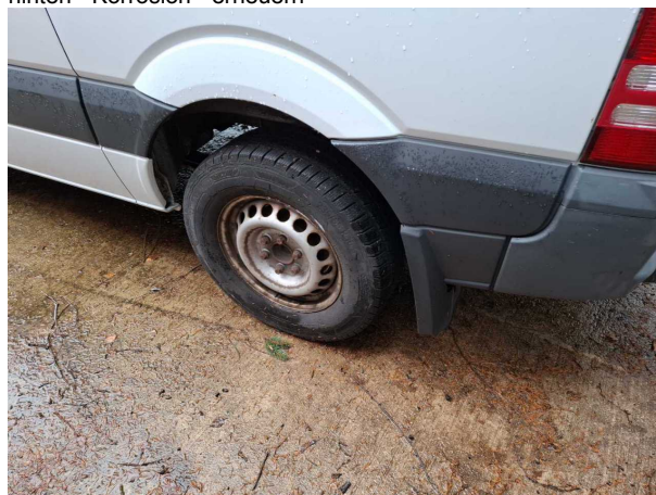
Beschädigung #8: Rad/Reifen: Radblende hinten links - fehlt - erneuern
