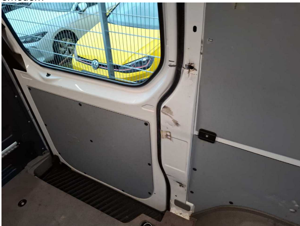
Beschädigung #4: Schiebetür rechts: Türdichtung - gebrochen / gerissen - erneuern
