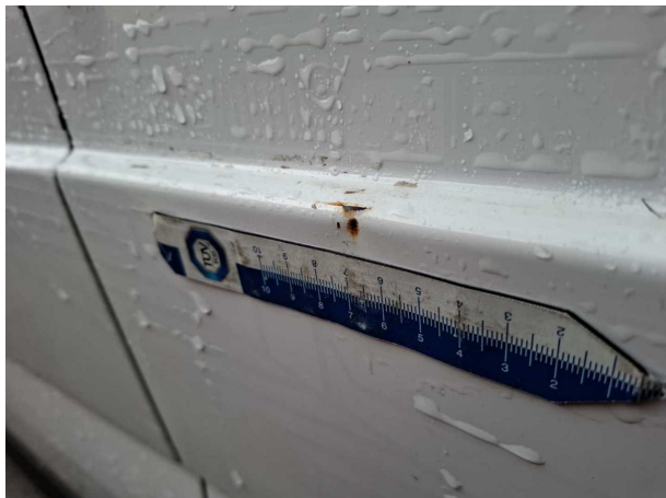
Beschädigung #11: Seitenwand links: Seitenwand - Korrosion - instandsetzen und lackieren
