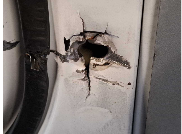
Beschädigung #3: Karosserie: B-Säule links - beschädigt - erneuern
