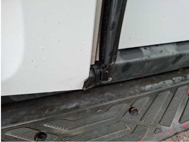
Beschädigung #14: Heckklappe/-tür: Dichtung - verformt - erneuern
