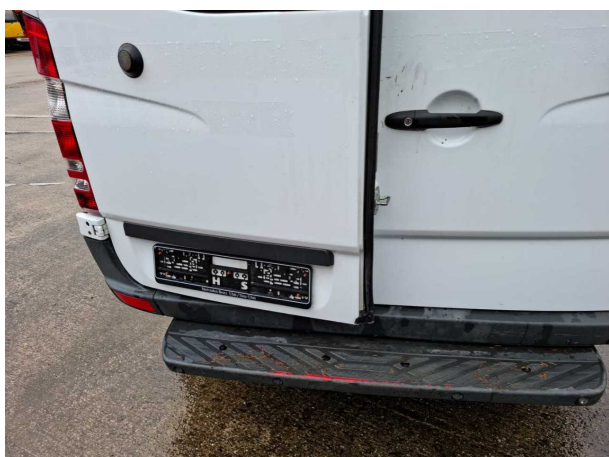
Beschädigung #14: Heckklappe/-tür: Dichtung - verformt - erneuern
