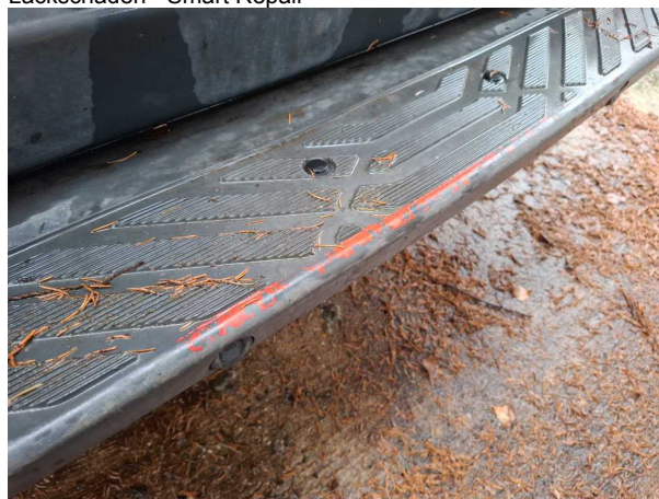
Beschädigung #10: Heckbereich: Auftritt (Farbe) - beschädigt... erneuern
