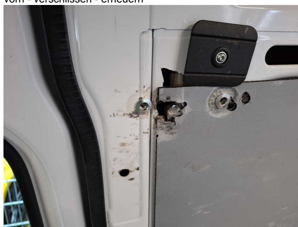
Beschädigung #3: Karosserie: B-Säule links - beschädigt - erneuern
