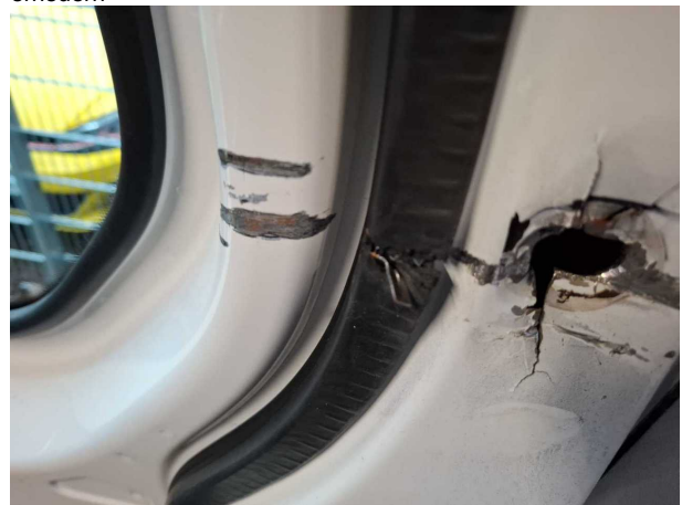
Beschädigung #4: Schiebetür rechts: Türdichtung - gebrochen / gerissen - erneuern
