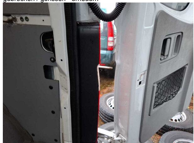
Beschädigung #5: Heckklappe/-tür: Fangband / Feststeller - fehlt - erneuern
