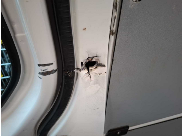
Beschädigung #3: Karosserie: B-Säule links - beschädigt - erneuern
