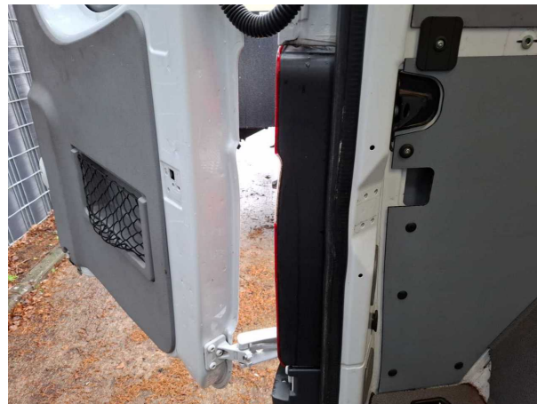
Beschädigung #5: Heckklappe/-tür: Fangband / Feststeller - fehlt - erneuern
