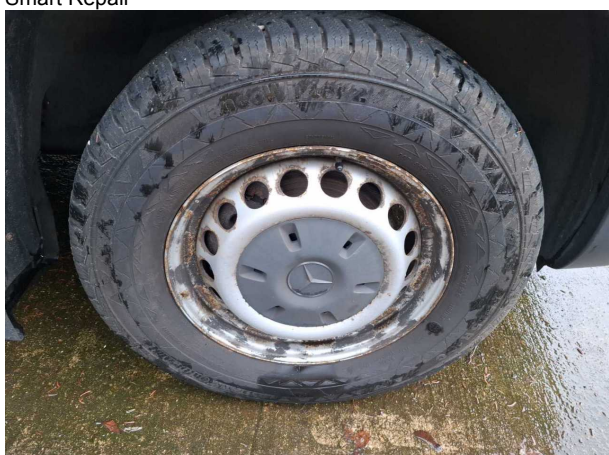
Beschädigung #6: Rad/Reifen: Felgensatz komplett - Korrosion - Smart Repair
