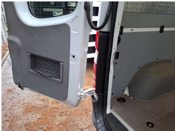
Beschädigung #5: Heckklappe/-tür: Fangband / Feststeller - fehlt - erneuern
