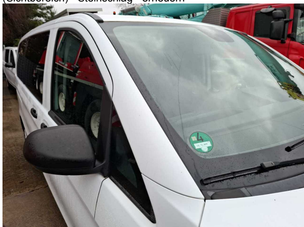
Beschädigung #14: Karosserie: A-Säule rechts - Steinschlag - Smart Repair
