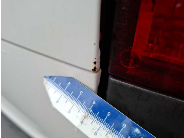
Beschädigung #16: Heckklappe/-tür: Heckklappe - Kratzer - instandsetzen und lackieren
