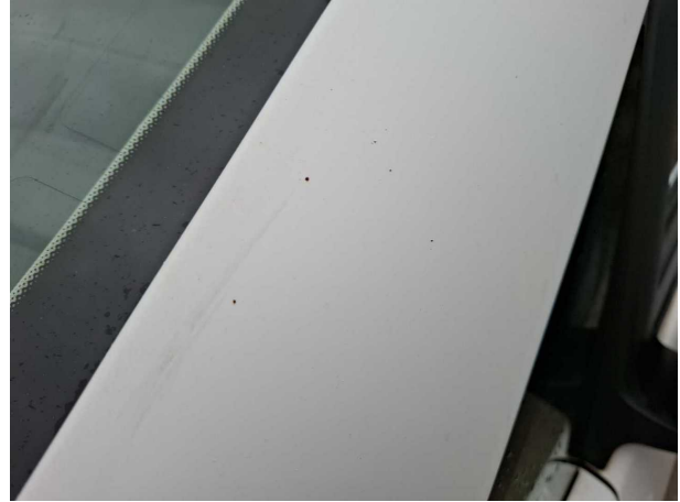
Beschädigung #15: Karosserie: A-Säule links - Steinschlag - Smart Repair
