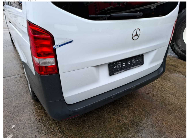
Beschädigung #16: Heckklappe/-tür: Heckklappe - Kratzer - instandsetzen und lackieren
