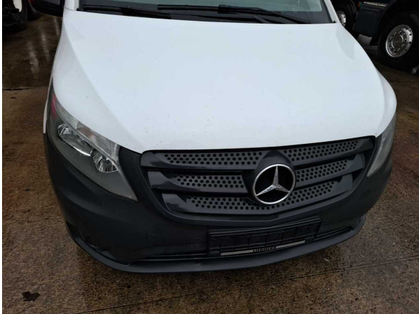
Beschädigung #6: Motorhaube: Motorhaube - Korrosion - instandsetzen und lackieren
