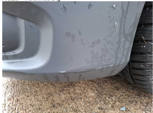
Beschädigung #17: Stossfänger vorn: Stossfänger vorn - Kratzer - Wertminderung
