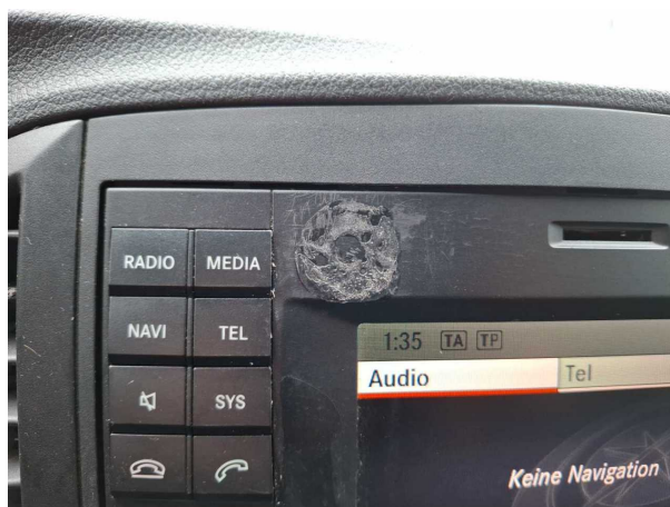
Beschädigung #3: Multimediasystem: Radio - beschädigt - Wertminderung
