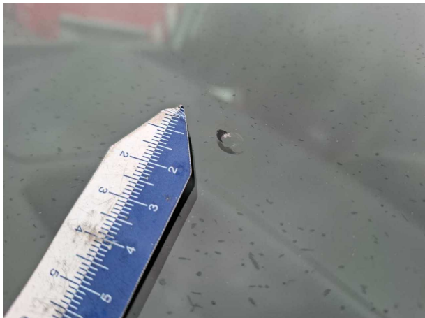
Beschädigung #13: Verglasung: Frontscheibe mit Regensensor (Sichtbereich) - Steinschlag - erneuern
