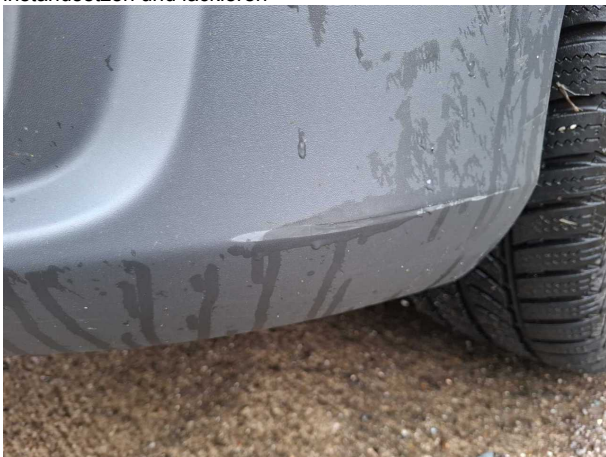
Beschädigung #17: Stossfänger vorn: Stossfänger vorn - Kratzer - Wertminderung
