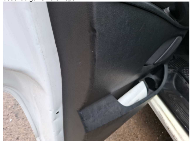
Beschädigung #8: Verkleidungen/Abdeckungen: Türverkleidung vorn links - beschädigt - Wertminderung
