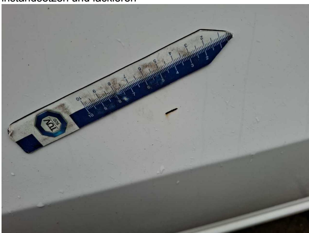
Beschädigung #12: Tür hinten links: Tür - Korrosion - instandsetzen und lackieren
