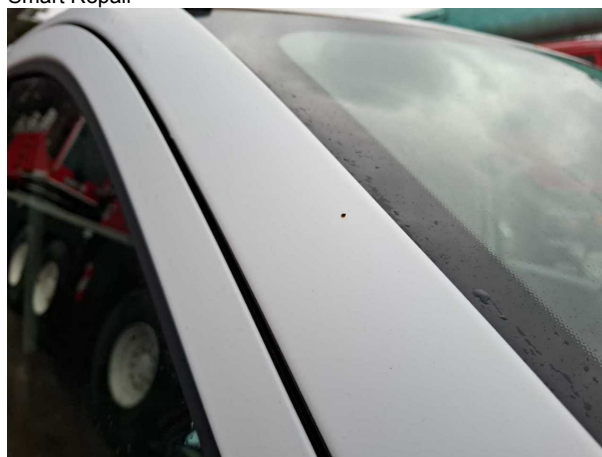
Beschädigung #14: Karosserie: A-Säule rechts - Steinschlag - Smart Repair
