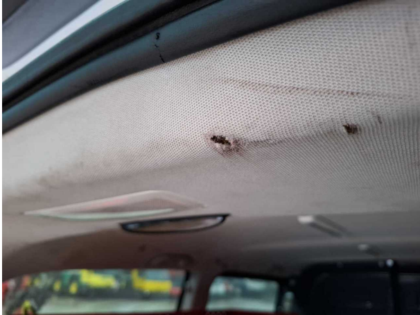
Beschädigung #7: Verkleidungen/Abdeckungen: Dachhimmel - beschädigt - Smart Repair
