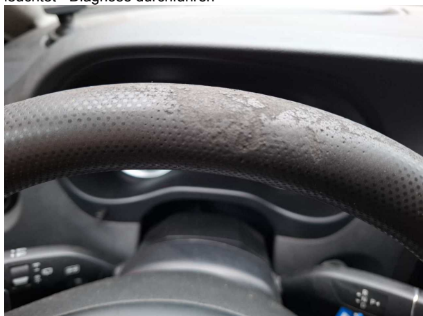
Beschädigung #2: Lenkanlage: Lenkrad - Abrieb - erneuern
