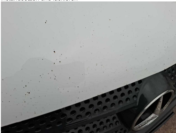
Beschädigung #6: Motorhaube: Motorhaube - Korrosion - instandsetzen und lackieren
