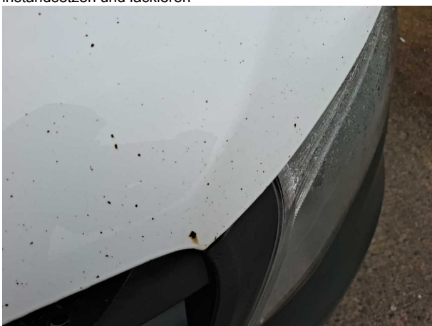
Beschädigung #6: Motorhaube: Motorhaube - Korrosion - instandsetzen und lackieren
