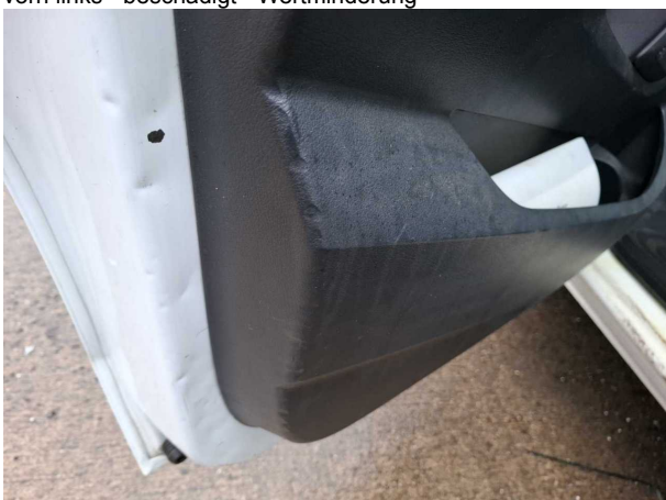
Beschädigung #8: Verkleidungen/Abdeckungen: Türverkleidung vorn links - beschädigt - Wertminderung
