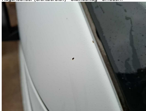
Beschädigung #14: Karosserie: A-Säule rechts - Steinschlag - Smart Repair
