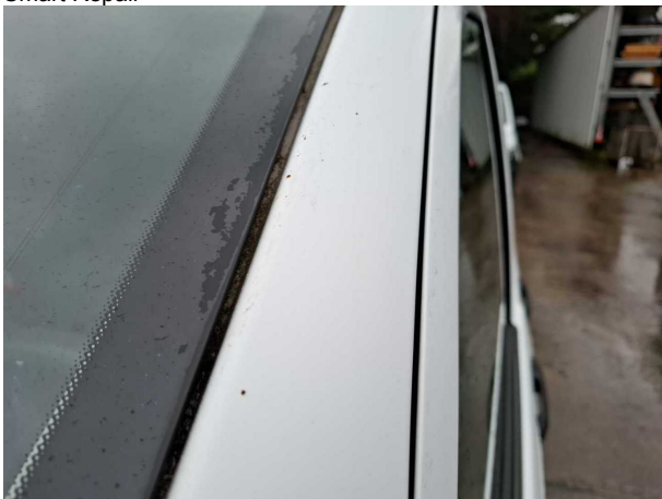
Beschädigung #15: Karosserie: A-Säule links - Steinschlag - Smart Repair
