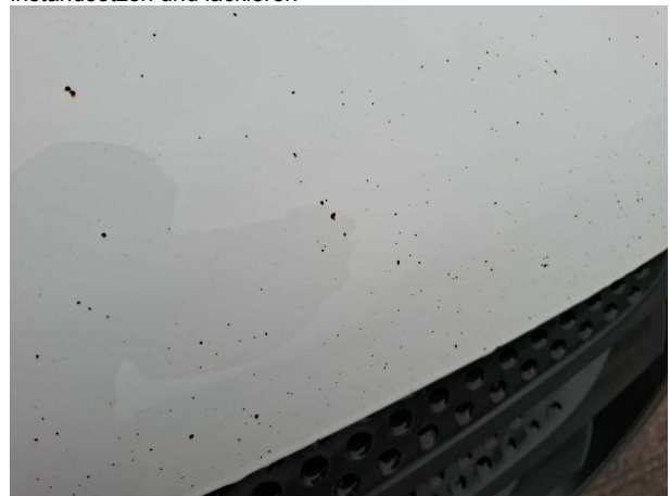
Beschädigung #6: Motorhaube: Motorhaube - Korrosion - instandsetzen und lackieren
