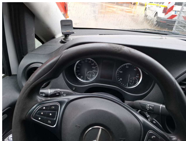
Beschädigung #2: Lenkanlage: Lenkrad - Abrieb - erneuern
