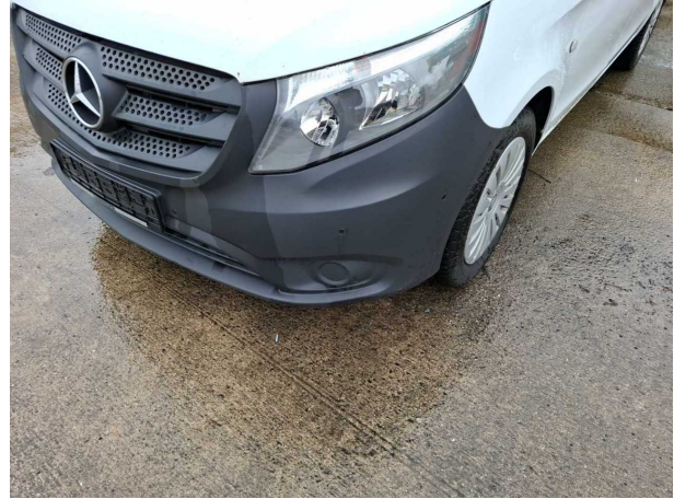
Beschädigung #17: Stossfänger vorn: Stossfänger vorn - Kratzer - Wertminderung
