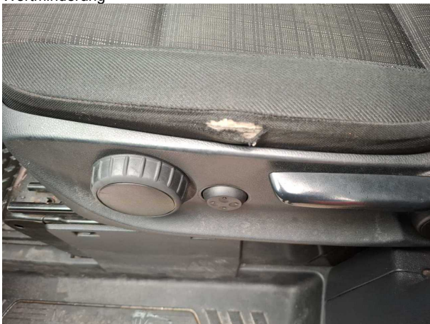
Beschädigung #4: Sitz vorn: Sitzbezug links - gebrochen / gerissen - erneuern
