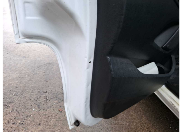
Beschädigung #9: Tür vorn links: Tür (Innen) - verformt - instandsetzen und lackieren
