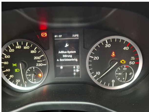
Beschädigung #1: Instrumententafel: Kontrollleuchte (Adblue) - leuchtet - Diagnose durchführen
