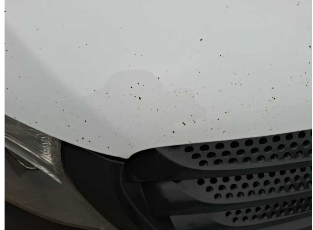
Beschädigung #6: Motorhaube: Motorhaube - Korrosion - instandsetzen und lackieren
