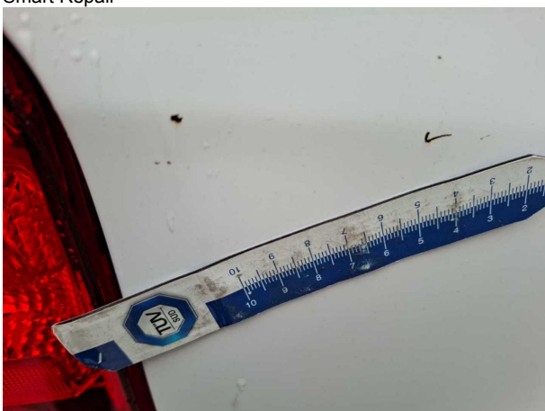
Beschädigung #16: Heckklappe/-tür: Heckklappe - Kratzer - instandsetzen und lackieren
