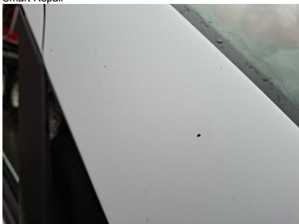
Beschädigung #14: Karosserie: A-Säule rechts - Steinschlag - Smart Repair
