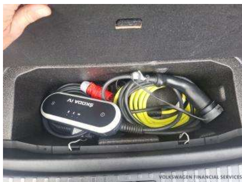
Fot. 29 Przewód ładowania baterii trakcyjnej
