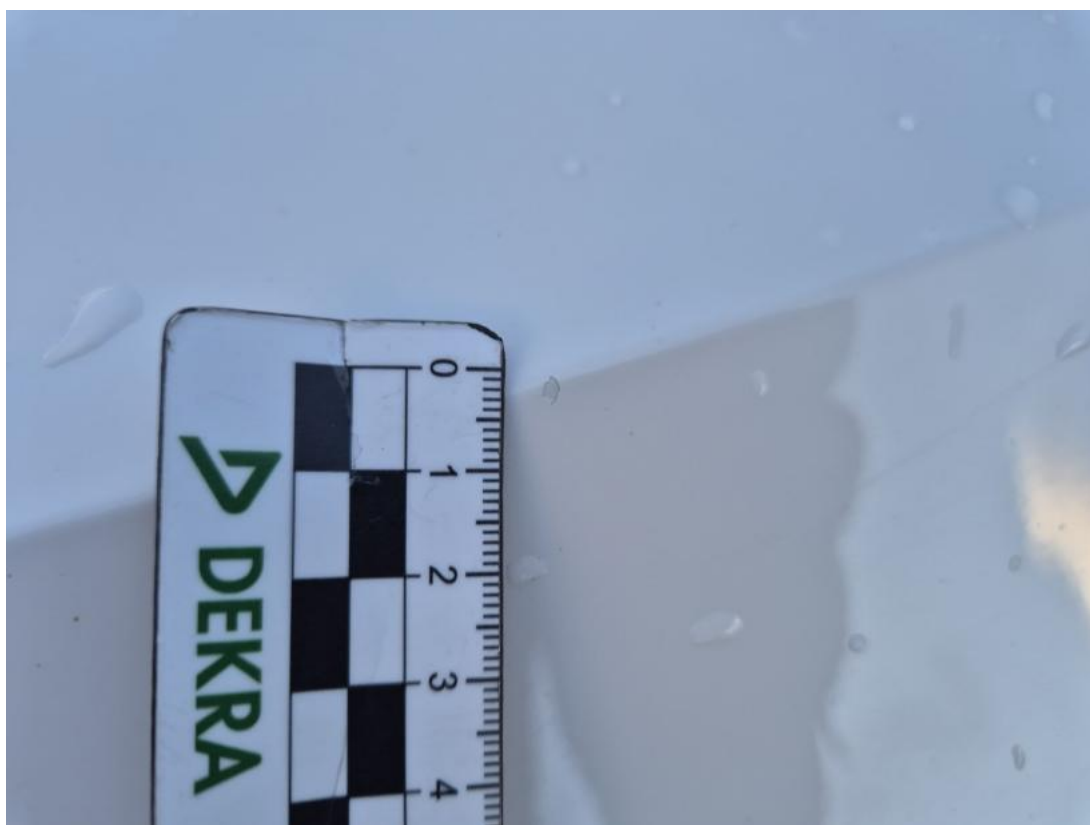
Fot. 32 Pokrywa komory silnika - Rysa/odprysk 1
