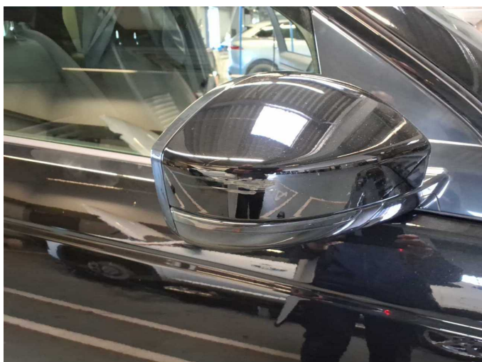
Beschädigung 5: Außenspiegel rechts: Abdeckkappe - verkratzt / verschürft - lackieren
