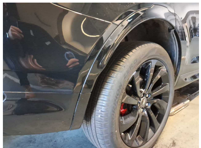
Beschädigung 1: Seitenwand rechts: Radlauf - lose - befunden ggf. instandsetzen
