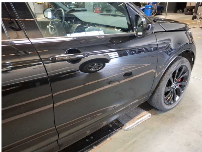
Gebrauchsspur 1: Tür vorn rechts: Tür - Kratzer - kein Abzug
