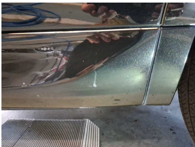
Beschädigung 3: Karosserie: Karosserie - Lackmangel - aufbereiten
