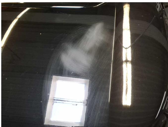
Beschädigung 8: Motorhaube: Motorhaube - verkratzt / verschürft - instandsetzen und lackieren
