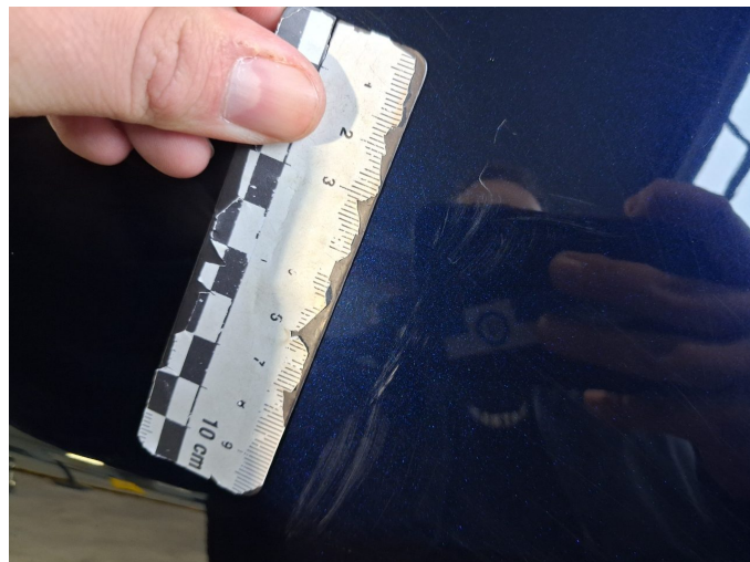
Beschädigung 5: Seitenwand links: Seitenwand - Kratzer - lackieren
