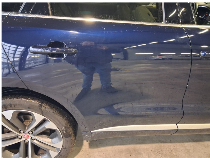
Beschädigung 6: Tür hinten rechts: Tür - Kratzer - lackieren
