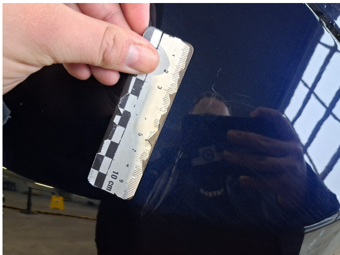
Beschädigung 5: Seitenwand links: Seitenwand - Kratzer - lackieren
