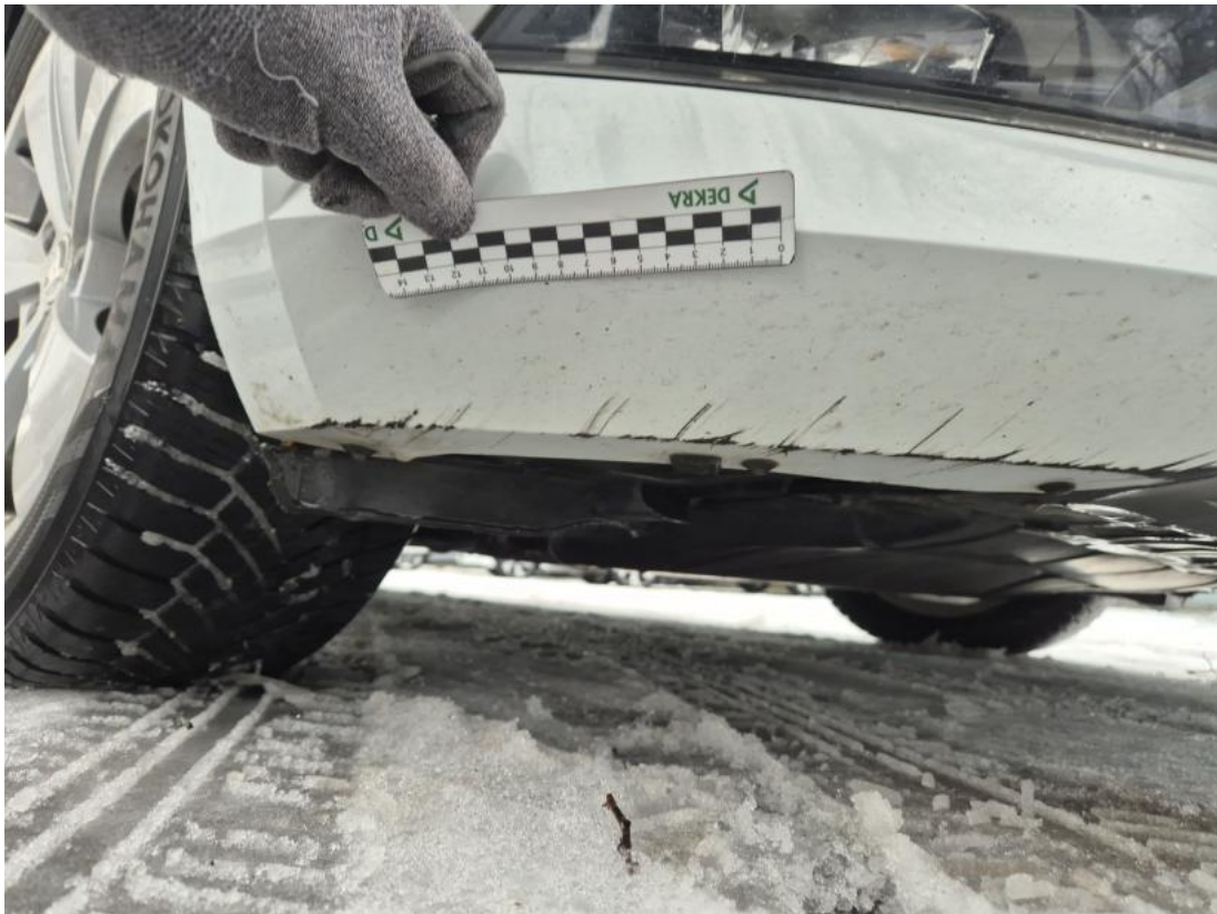
Fot. 33 Zderzak - Rysa/odprysk 2
