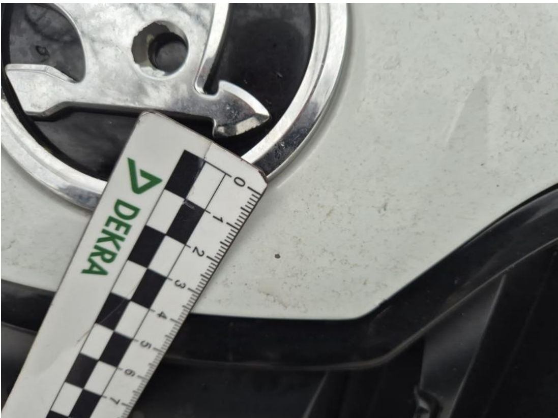
Fot. 30 Pokrywa komory silnika - Rysa/odprysk 1
