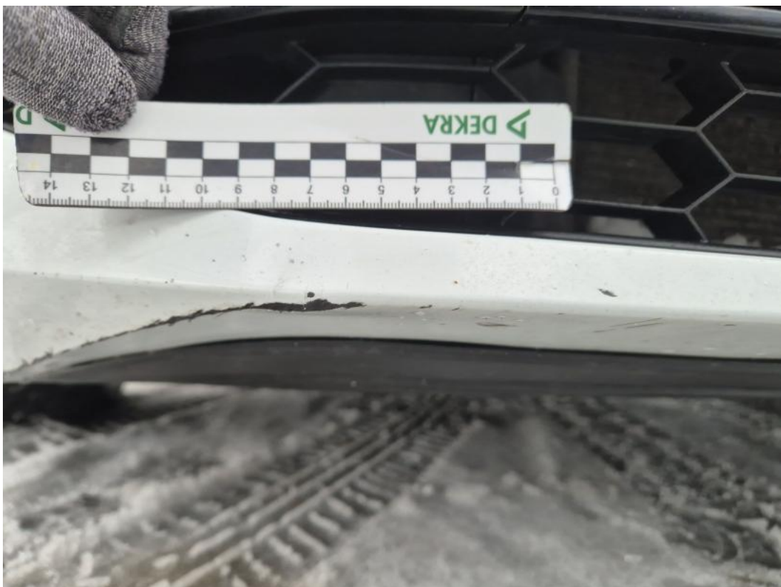
Fot. 34 Zderzak() - Rysa/odprysk 3
