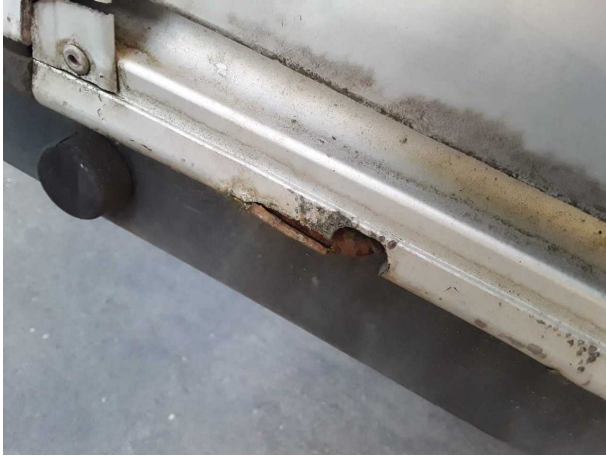
Beschädigung #4: Heckklappe/-tür: Heckklappe - gebrochen / gerissen - erneuern
