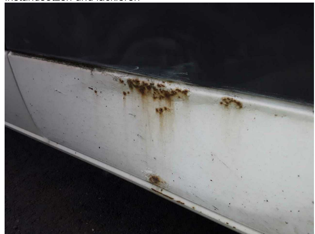
Beschädigung #8: Tür vorn rechts: Tür (Korrosion und) - verformt - erneuern
