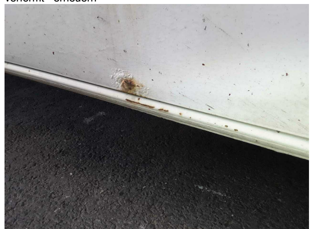
Beschädigung #9: Schweller rechts: Einstieg - Korrosion - instandsetzen und lackieren
