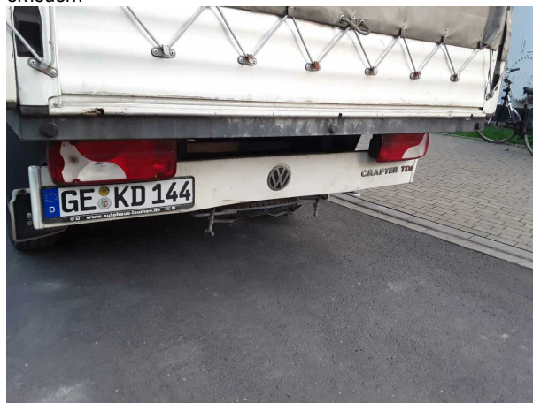
Beschädigung #3: Stossfänger hinten: Stossfänger hinten - verformt - erneuern
