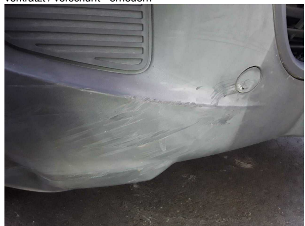
Beschädigung #6: Stossfänger vorn: Stossfänger vorn - verkratzt / verschürft - erneuern
