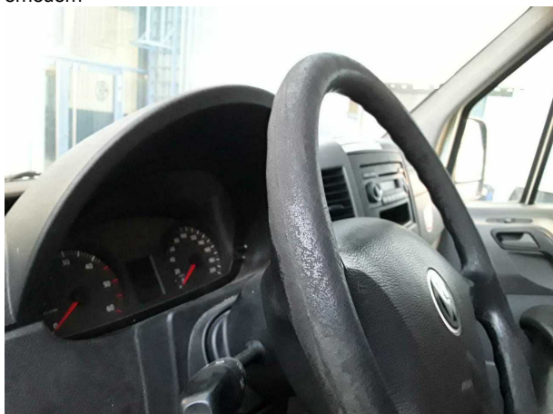
Beschädigung #2: Lenkanlage: Lenkrad (Starker) - Abrieb - erneuern
