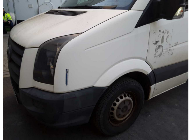
Beschädigung #5: Kotflügel links: Kotflügel links - Delle / Lackschaden - instandsetzen und lackieren
