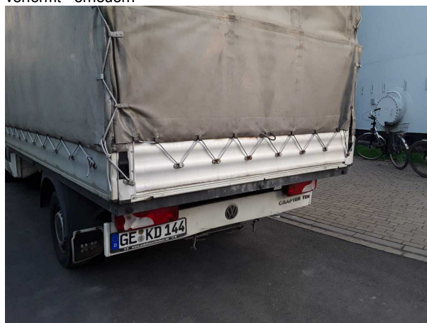
Beschädigung #4: Heckklappe/-tür: Heckklappe - gebrochen / gerissen - erneuern
