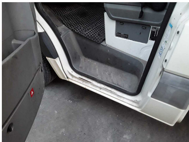
Beschädigung #10: Schweller links: Einstieg - Abrieb - Smart Repair
