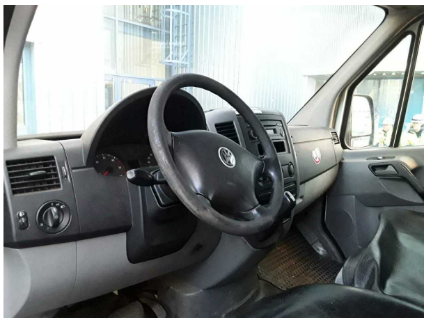
Beschädigung #2: Lenkanlage: Lenkrad (Starker) - Abrieb - erneuern
