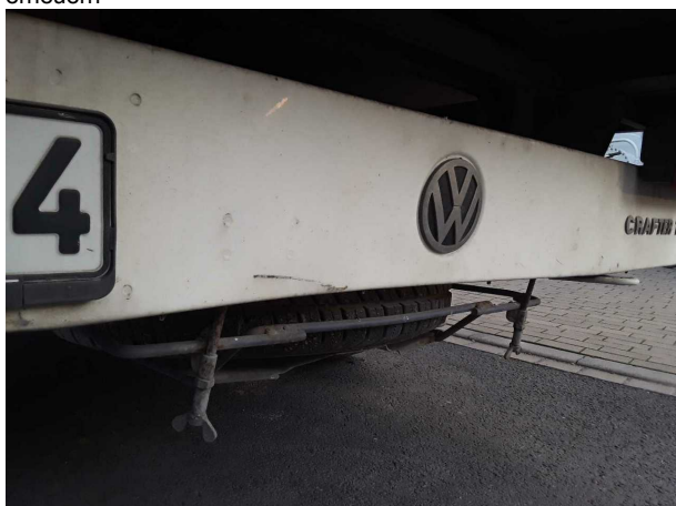
Beschädigung #3: Stossfänger hinten: Stossfänger hinten - verformt - erneuern
