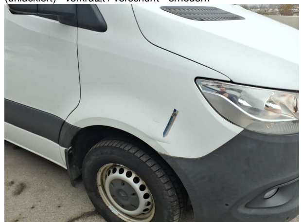
Beschädigung #4: Kotflügel rechts: Kotflügel rechts - Delle / Lackschaden - instandsetzen und lackieren
