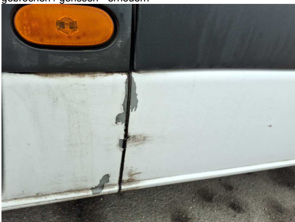
Beschädigung #14: Seitenwand links: Seitenwand - Kratzer - lackieren
