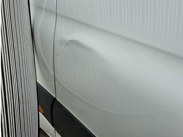
Beschädigung #7: Schiebetür rechts: Schiebetür - verformt - instandsetzen und lackieren
