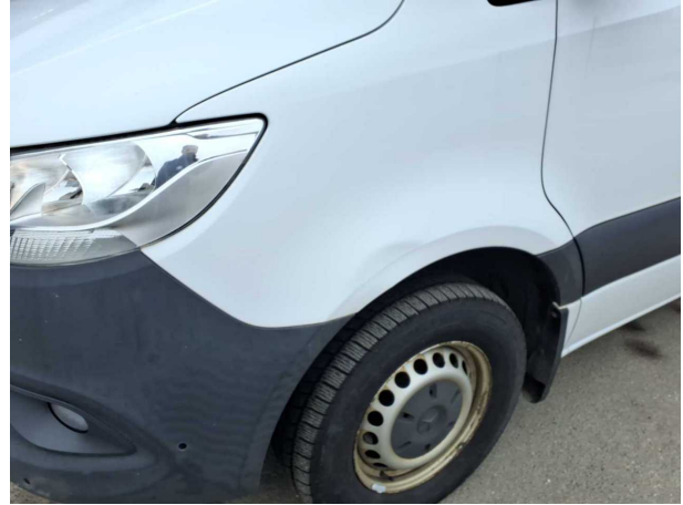
Beschädigung #16: Kotflügel links: Kotflügel links - Delle / Lackschaden - instandsetzen und lackieren
