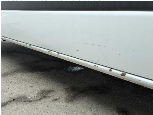
Beschädigung #10: Schweller rechts: Schweller - Kratzer - lackieren
