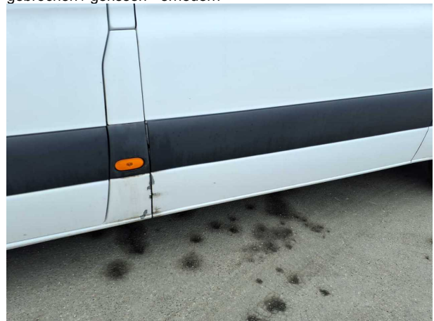
Beschädigung #14: Seitenwand links: Seitenwand - Kratzer - lackieren
