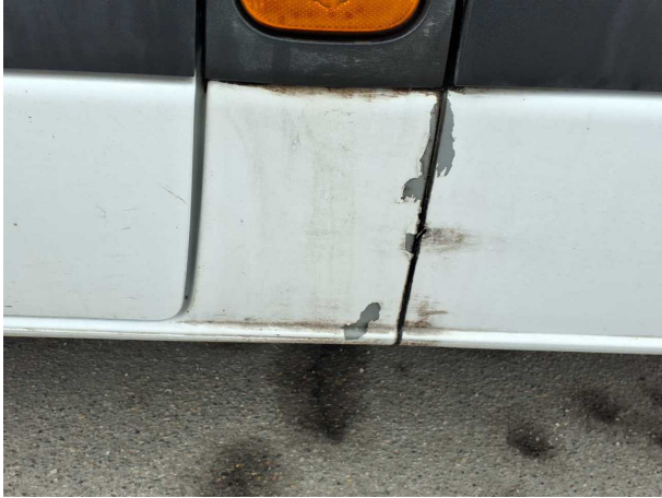
Beschädigung #15: Karosserie: B-Säule links - Kratzer - lackieren
