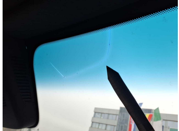
Beschädigung #2: Verglasung: Frontscheibe - gebrochen / gerissen - erneuern
