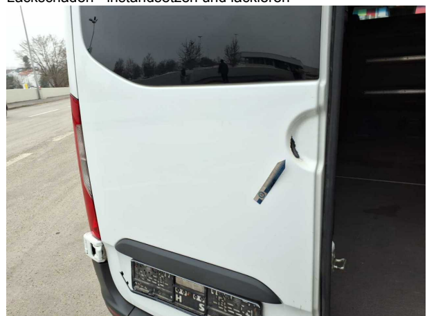
Beschädigung #12: Heckklappe/-tür: Hecktür links - Kratzer - lackieren
