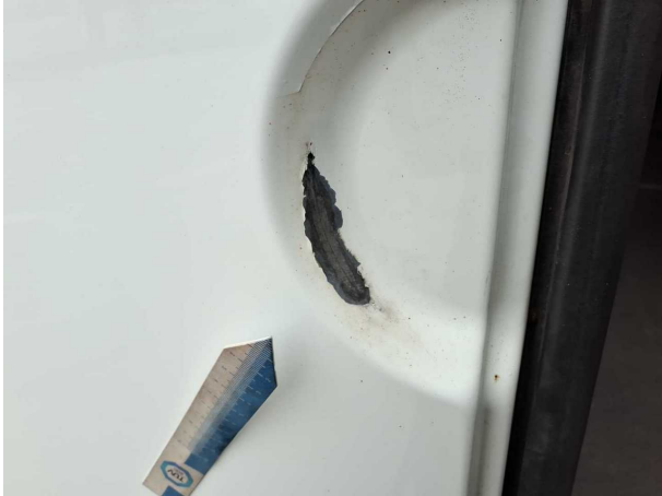
Beschädigung #12: Heckklappe/-tür: Hecktür links - Kratzer - lackieren
