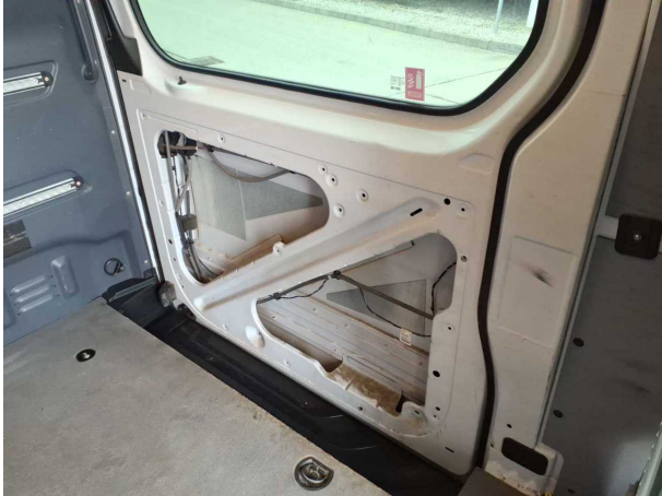
Beschädigung #1: Schiebetür rechts: Verkleidung - fehlt - erneuern
