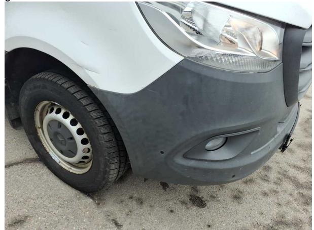
Beschädigung #3: Stossfänger vorn: Stossfänger vorn (unlackiert) - verkratzt / verschürft - erneuern
