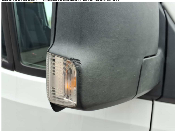
Beschädigung #5: Außenspiegel rechts: Abdeckkappe - verkratzt / verschürft - erneuern
