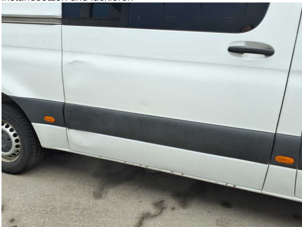
Beschädigung #8: Schiebetür rechts: Schutzleiste - verkratzt / verschürft - erneuern
