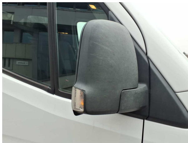
Beschädigung #5: Außenspiegel rechts: Abdeckkappe - verkratzt / verschürft - erneuern
