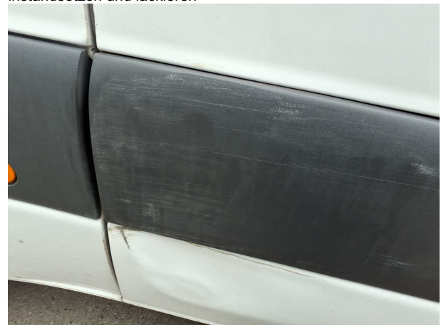
Beschädigung #8: Schiebetür rechts: Schutzleiste - verkratzt / verschürft - erneuern
