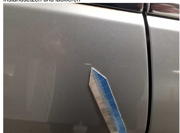
Beschädigung #6: Tür hinten rechts: Tür - Kratzer - lackieren
