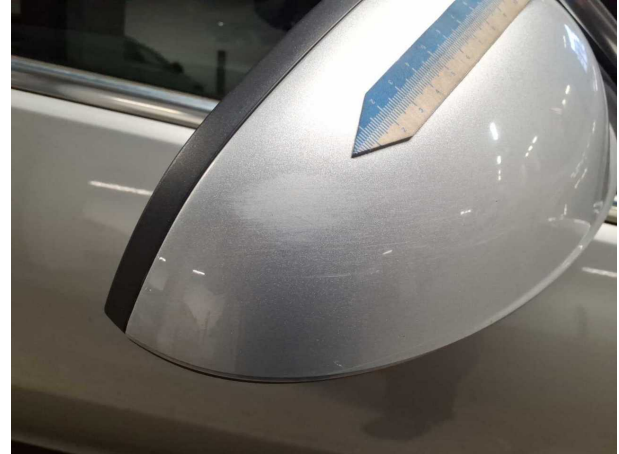
Beschädigung #4: Außenspiegel rechts: Abdeckkappe - Kratzer - lackieren
