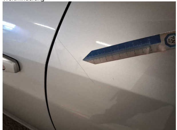
Beschädigung #12: Tür hinten links: Tür - Kratzer - lackieren
