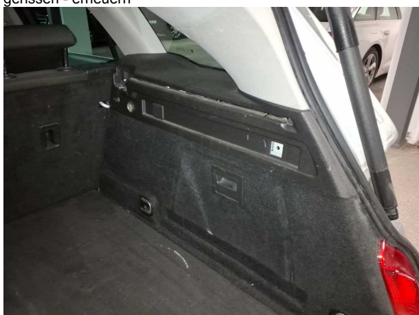
Beschädigung #3: Verkleidungen/Abdeckungen: Kofferraumverkleidung - Kratzer - Wertminderung
