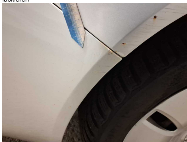
Beschädigung #9: Stossfänger hinten: Stossfänger hinten - Delle / Lackschaden - lackieren
