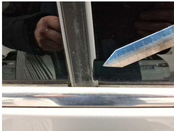
Beschädigung #7: Tür hinten rechts: Fensterführung (Gummi) - beschädigt - erneuern
