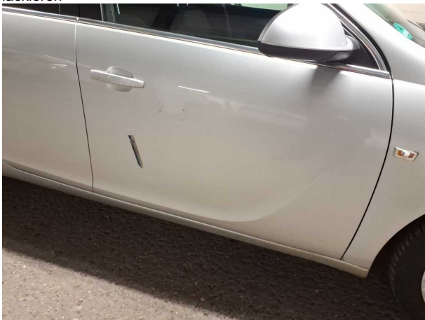
Beschädigung #5: Tür vorn rechts: Tür - Delle / Lackschaden - instandsetzen und lackieren
