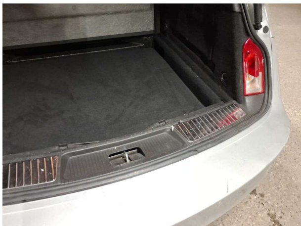
Beschädigung #1: Verkleidungen/Abdeckungen: Verkleidung Ladekante - gebrochen / gerissen - erneuern
