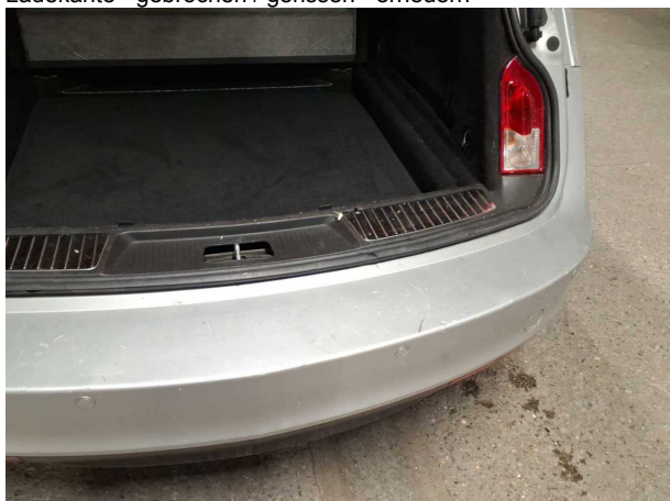
Beschädigung #2: Heckklappe/-tür: Dichtung - gebrochen / gerissen - erneuern
