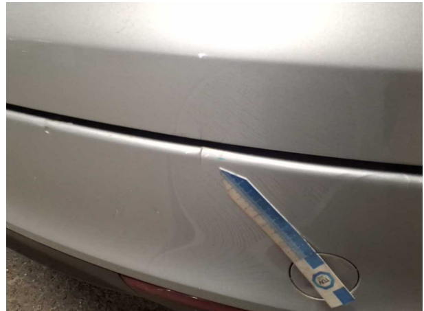
Beschädigung #9: Stossfänger hinten: Stossfänger hinten - Delle / Lackschaden - lackieren
