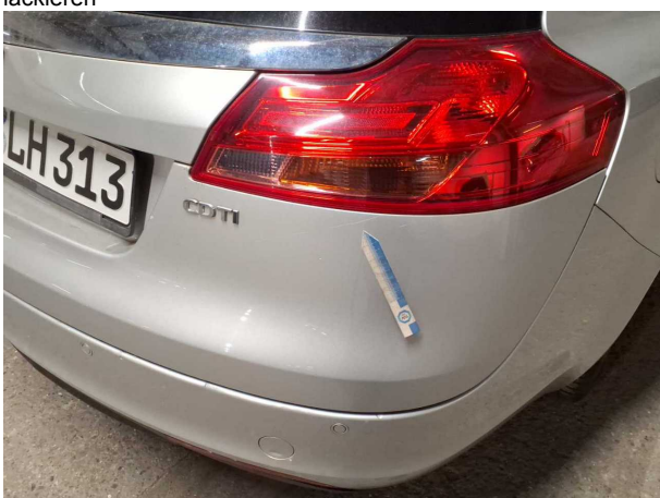
Beschädigung #10: Heckklappe/-tür: Heckklappe - Kratzer - lackieren
