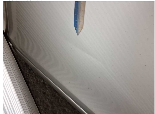
Beschädigung #5: Tür vorn rechts: Tür - Delle / Lackschade... instandsetzen und lackieren
