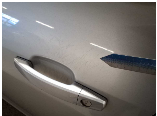
Beschädigung #13: Tür vorn links: Tür - Kratzer - auslegen / polieren
