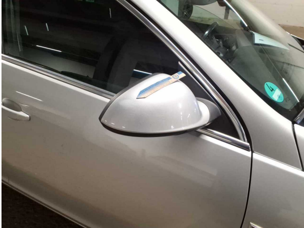
Beschädigung #4: Außenspiegel rechts: Abdeckkappe - Kratzer - lackieren
