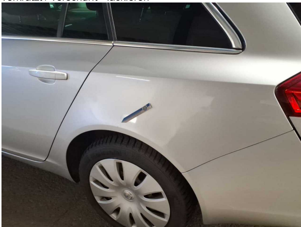
Beschädigung #15: Seitenwand links: Seitenwand - Kratzer - lackieren
