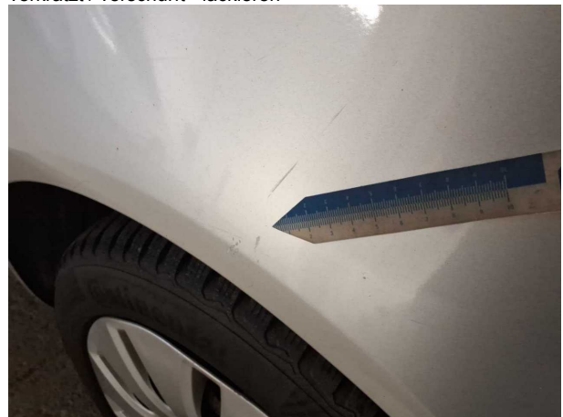
Beschädigung #15: Seitenwand links: Seitenwand - Kratzer - lackieren
