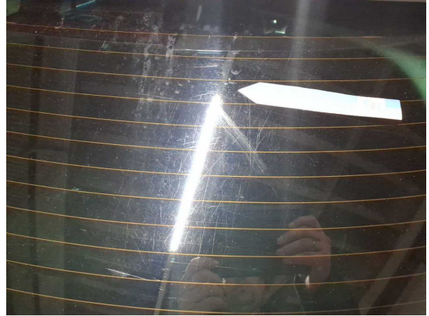
Beschädigung #11: Verglasung: Heckscheibe - Kratzer - Wertminderung
