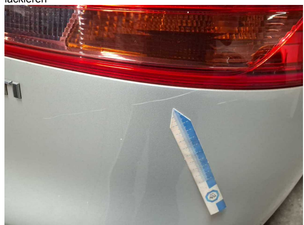
Beschädigung #10: Heckklappe/-tür: Heckklappe - Kratzer - lackieren
