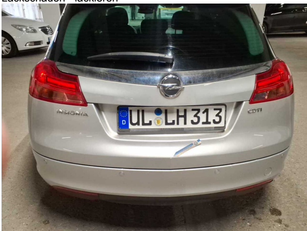
Beschädigung #10: Heckklappe/-tür: Heckklappe - Kratzer - lackieren
