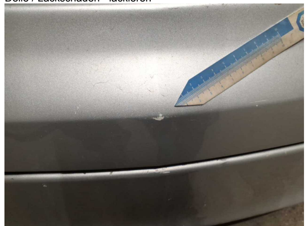
Beschädigung #10: Heckklappe/-tür: Heckklappe - Kratzer - lackieren
