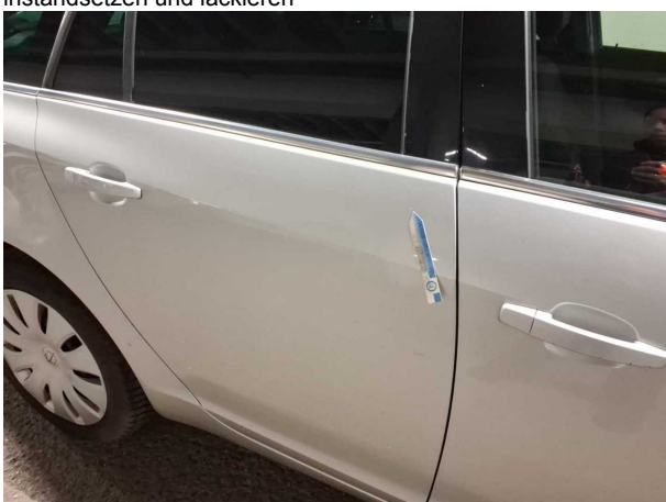
Beschädigung #6: Tür hinten rechts: Tür - Kratzer - lackieren
