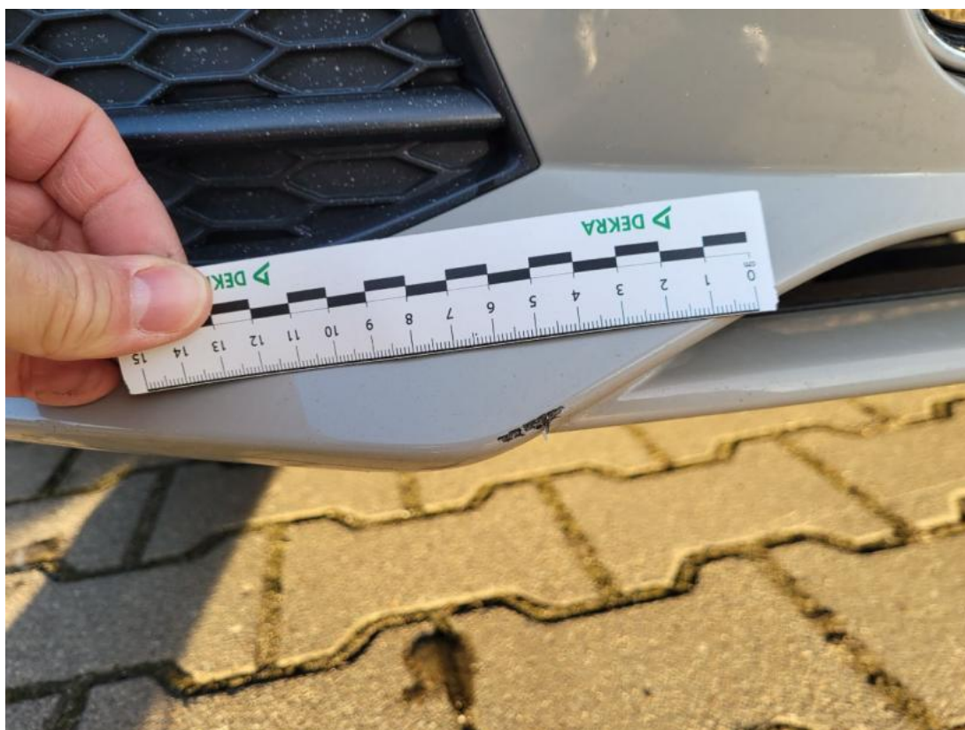
Fot. 36 Zderzak - Rysa/odprysk 1
