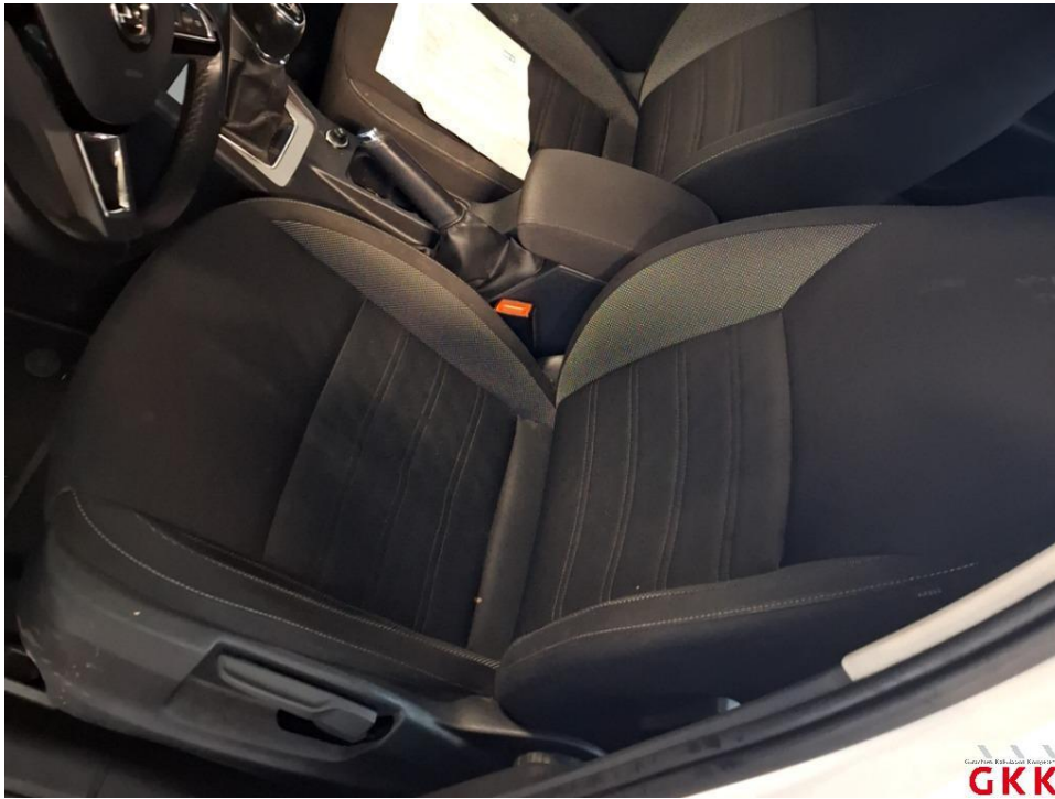
Bild 19 Sitz vorne links, Bezug Sitzkissen -Stoff-, Brandloch, ersetzen
