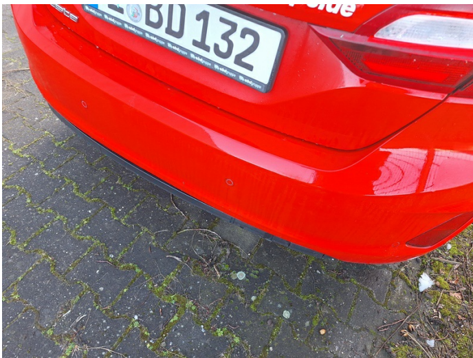
Stoßfänger hinten: verschrammt - lackieren (Foto 11)
