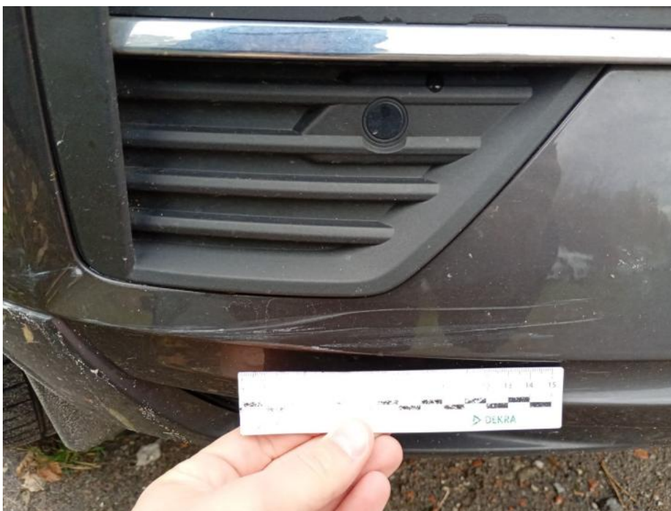
Fot. 42. Zderzak przedni cz P - Rysa/odprysk 1
